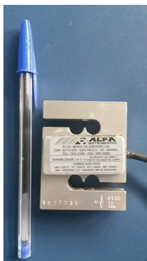
Figura 3.12: Célula de carga.
