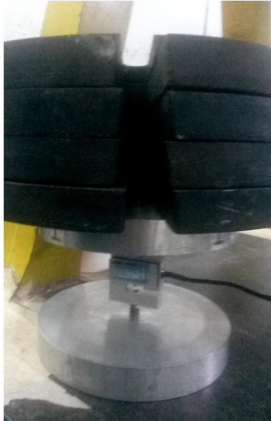
Figura 3.13: Calibração da célula de carga.
