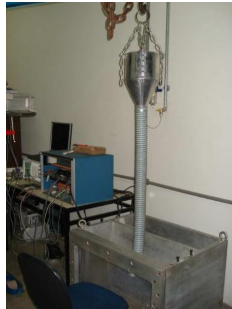
(b) Vista do Pluviador
