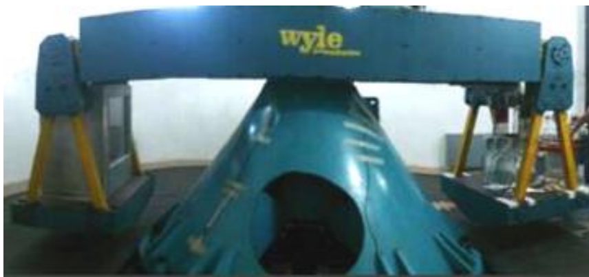
Figura 3.11: Centrífuga Geotécnica da UENF.
