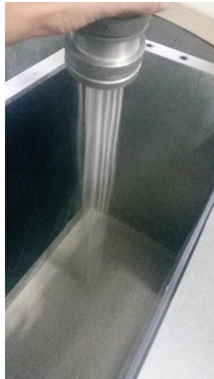
(b) Detalhe da “chuva” de areia (altura de pluviação de 50 cm)
