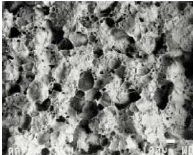
Figura 2.9 – Microscopia eletrônica de uma argamassa com alto teor de ar incorporado (CEMENT & CONCRETE ASSOCIATION OF AUSTRALIA, 2001).
