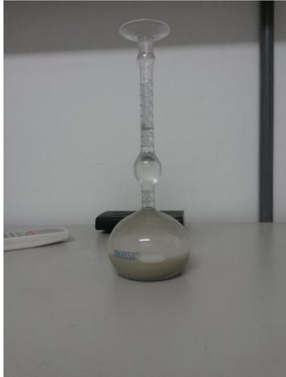
Figura 3.2 – Ensaio de densidade real dos grãos da cal pelo método de Le Chatelier.
