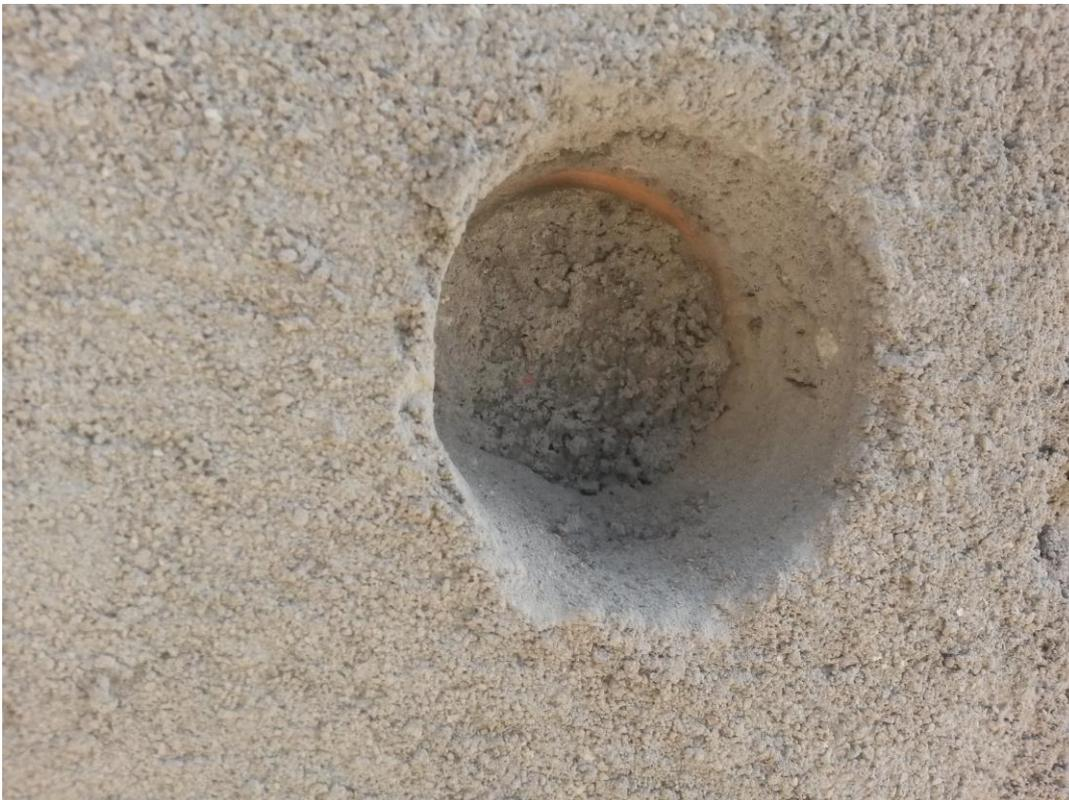
Figura 4.9 – Ruptura na interface chapisco/argamassa.
