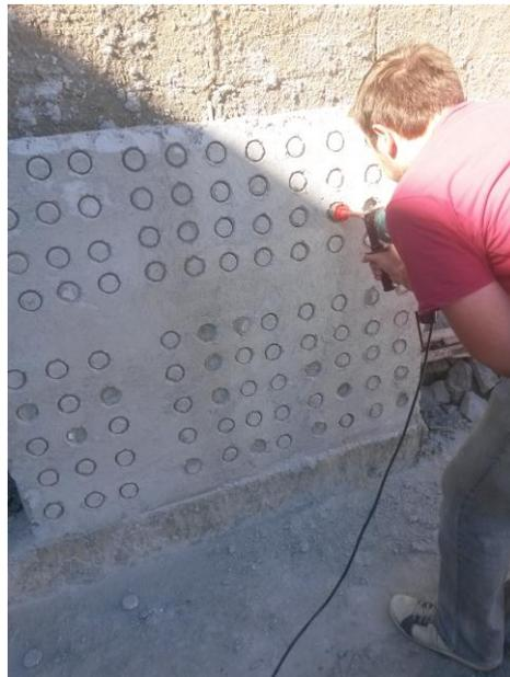
Figura 4.5 – Delimitação dos corpos de prova com serra copo.
