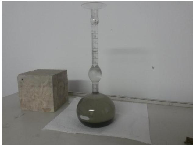
Figura 3.1 – Ensaio de densidade real dos grãos do cimento pelo método de Le Chatelier.
