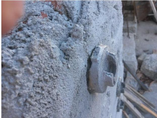
Figura 4.6 – Colagem das pastilhas metálicas sobre a argamassa
