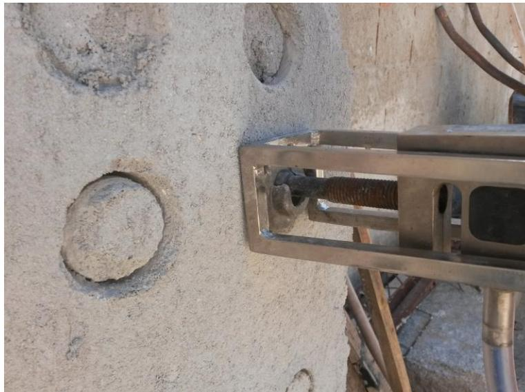
Figura 4.7 – Ensaio de resistência à aderência à tração.
