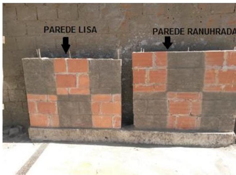
Figura 4.2 – Paredes para ensaio de resistência de aderência à tração.
