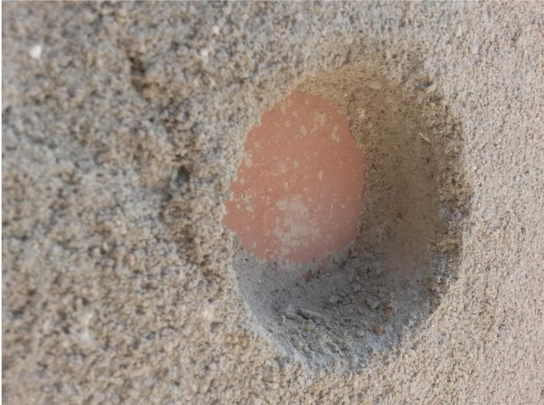
Figura 4.8 – Ruptura na interface substrato/argamassa.
