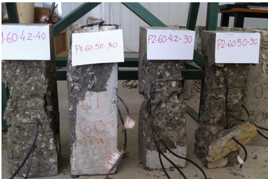
Figura 4.76– Pilares de 60 MPa e espaçamento de 30mm.
