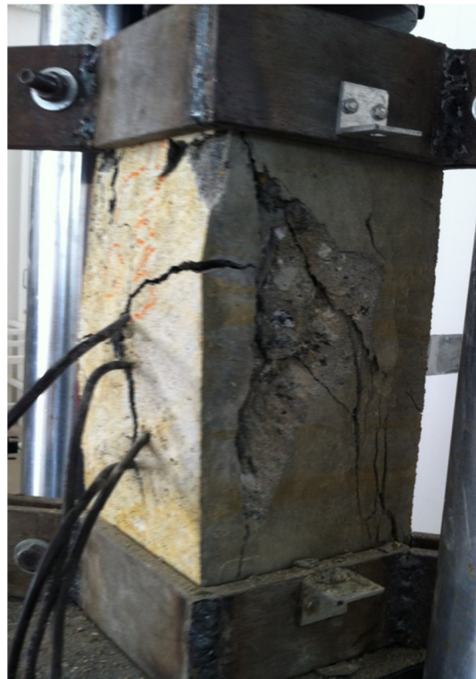
Figura 4.73– Padrão de ruptura do pilar P2-60-4,2-120.
