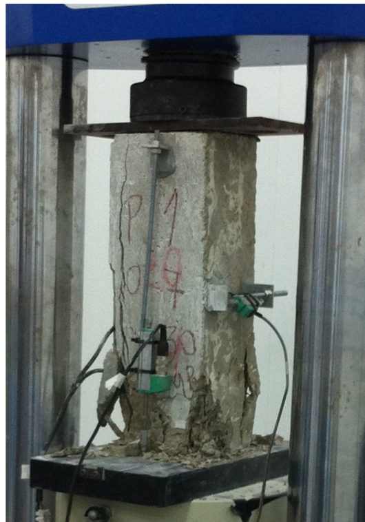
Figura 4.31– Padrão de ruptura final do pilar P1-30-4,2-100.
