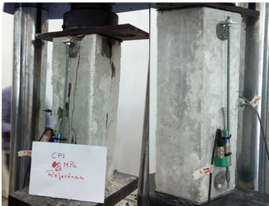
Figura 4.2– Ensaio dos pilares de referência do concreto de 60 MPa.
