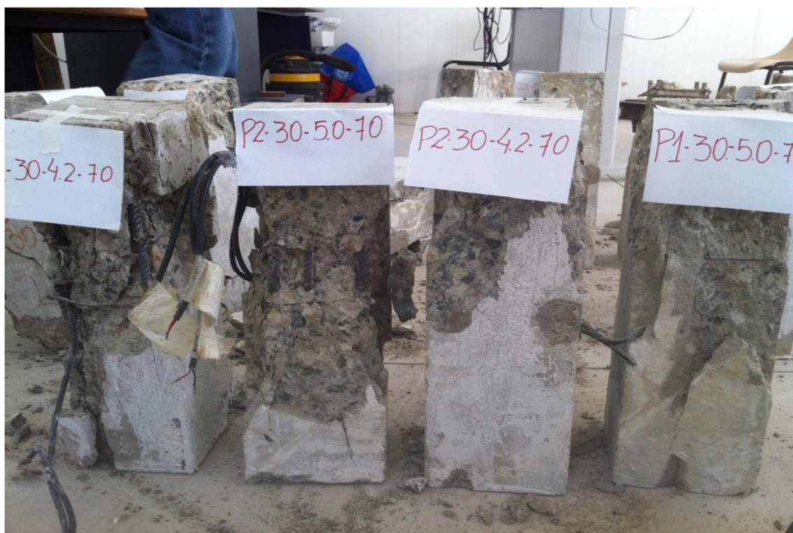
Figura 4.81– Pilares de 30 MPa e espaçamento de 70 mm.
