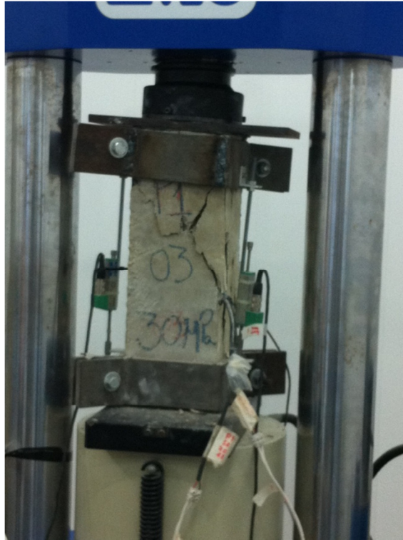
Figura 4.25– Padrão de ruptura do pilar P1-30-5,0-70.
