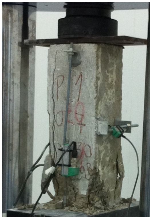
Figura 4.6– Pilar P1-30-4,2-100 após a ruptura sem colar metálico.
