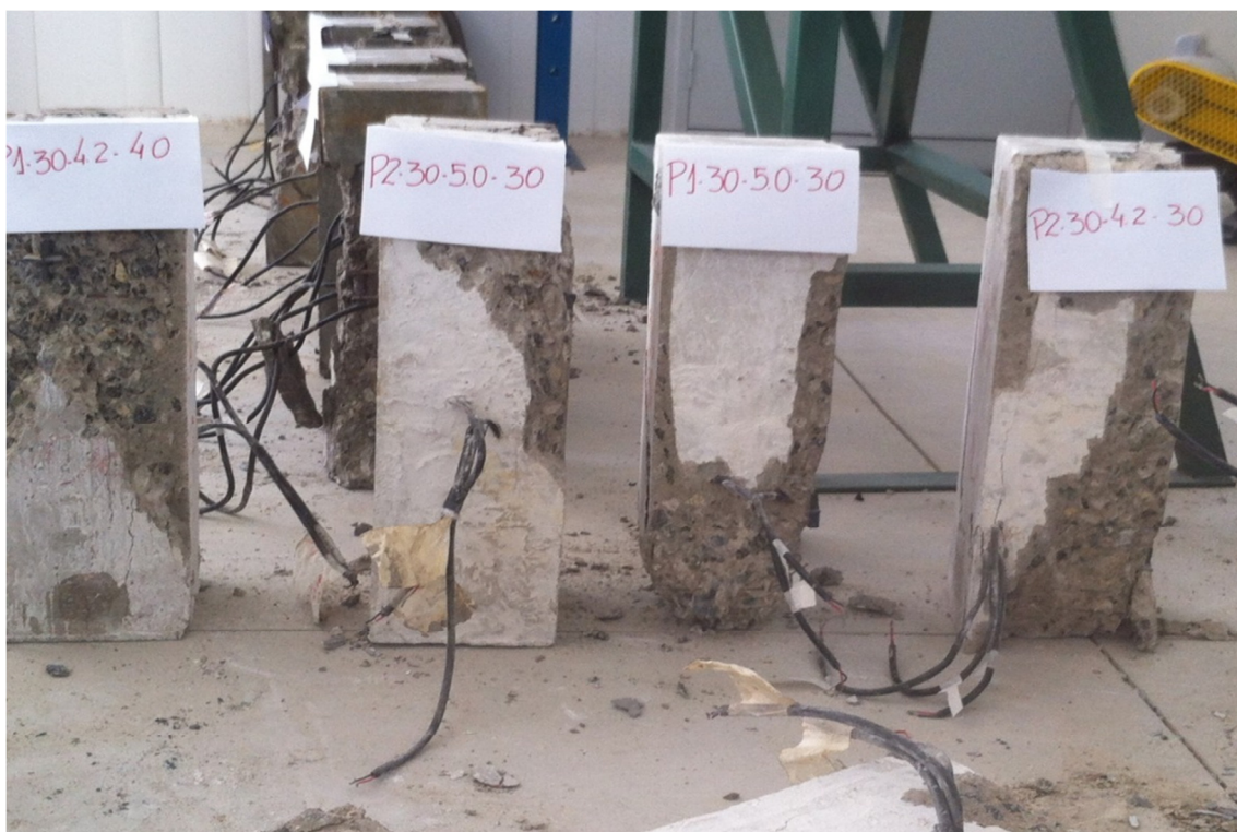
Figura 4.80– Pilares de 30 MPa e espaçamento de 30 mm.
