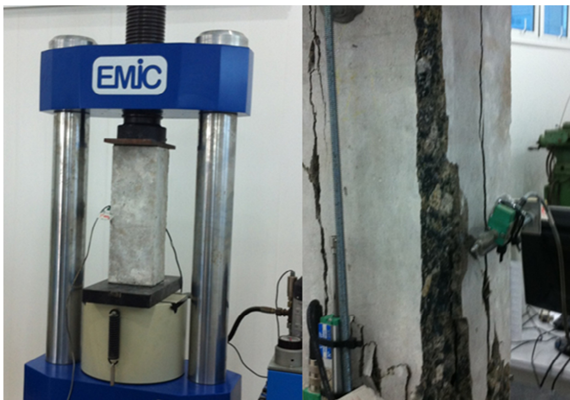
Figura 4.3– Ensaio do pilar de referência do concreto de 30 MPa.
