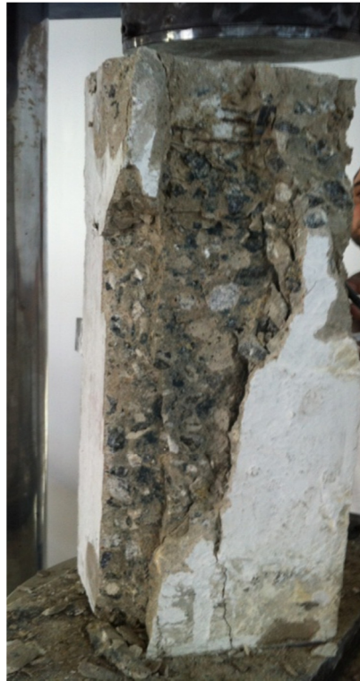
Figura 4.39– Padrão de ruptura final do pilar P1-30-4,2-120.
