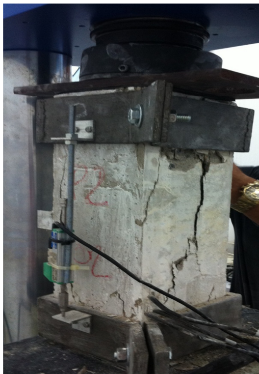
Figura 4.48– Padrão de ruptura do pilar P2-30-4,2-30.
