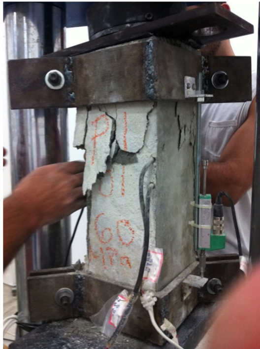
Figura 4.17– Padrão de ruptura do pilar P1-60-5,0-30.
