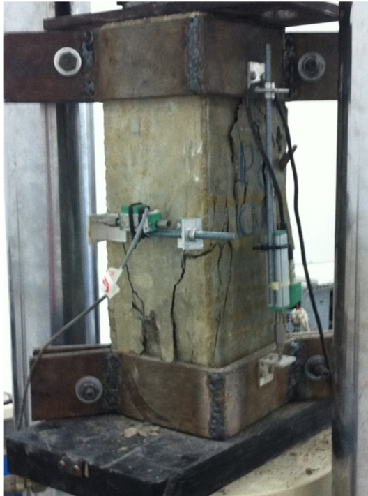
Figura 4.65– Padrão de ruptura do pilar P2-60-4,2-100.
