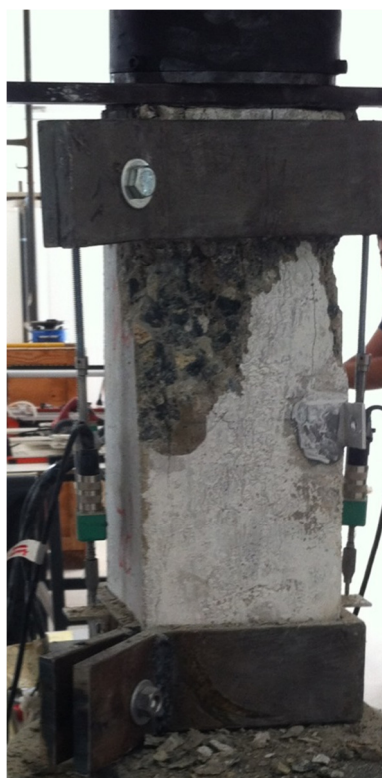
Figura 4.56– Padrão de ruptura do pilar P2-30-4,2-70.
