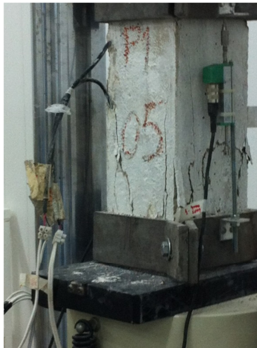
Figura 4.33– Padrão de ruptura final do pilar P1-30-5,0-100.
