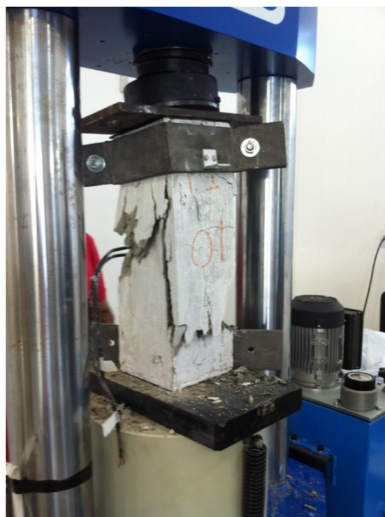
Figura 4.22– Padrão de ruptura do pilar P1-30-4,2-70.
