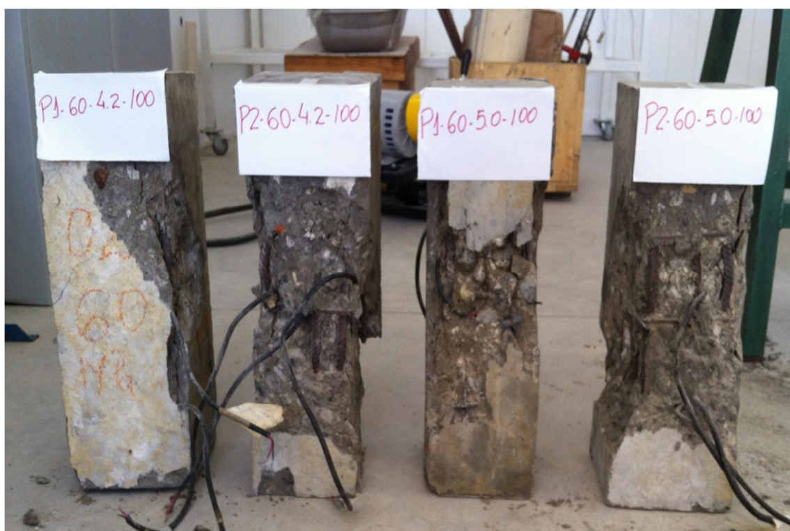
Figura 4.78– Pilares de 60 MPa e espaçamento de 100 mm.
