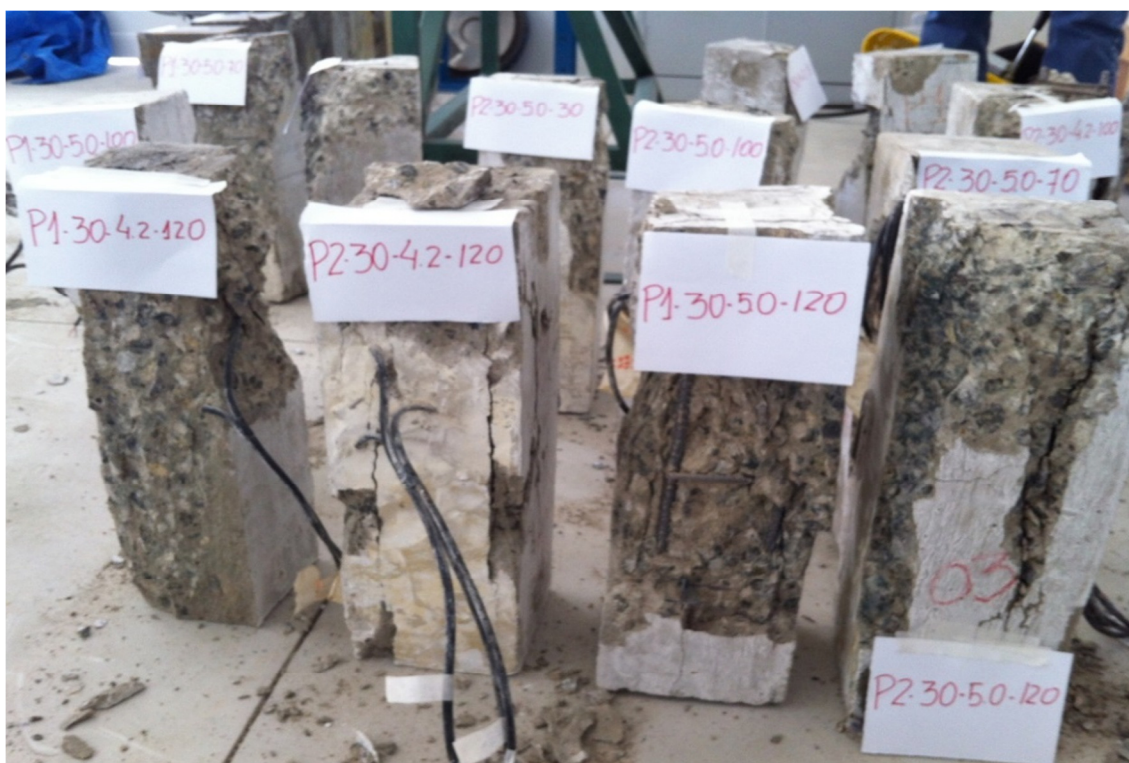
Figura 4.83– Pilares de 30 MPa e espaçamento de 120 mm.
