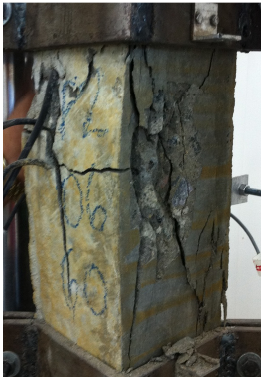
Figura 4.59– Padrão de ruptura do pilar P2-60-5,0-70.
