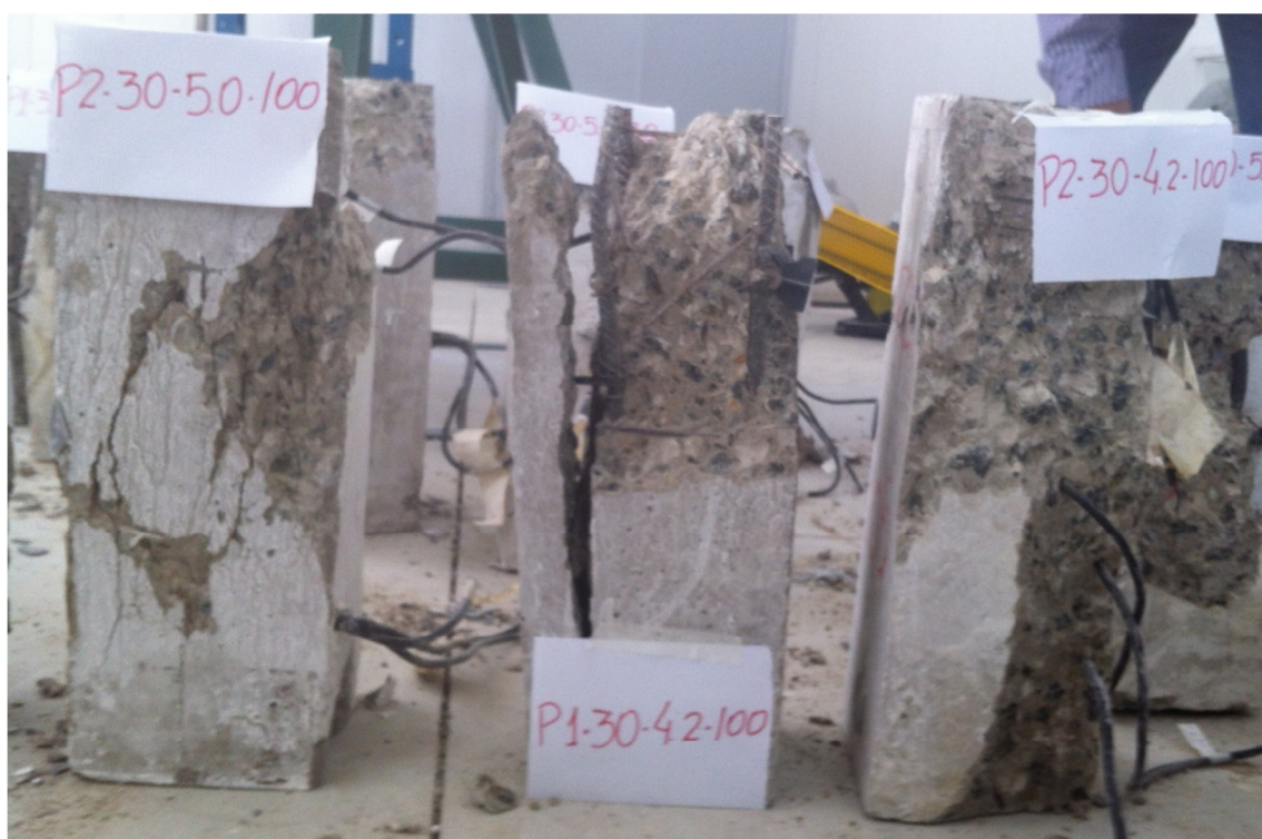
Figura 4.82– de Pilares 30 MPa e espaçamento de 100 mm.
