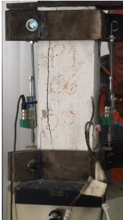
Figura 4.12–Padrão de ruptura do pilar P1-30-4,2-30.
