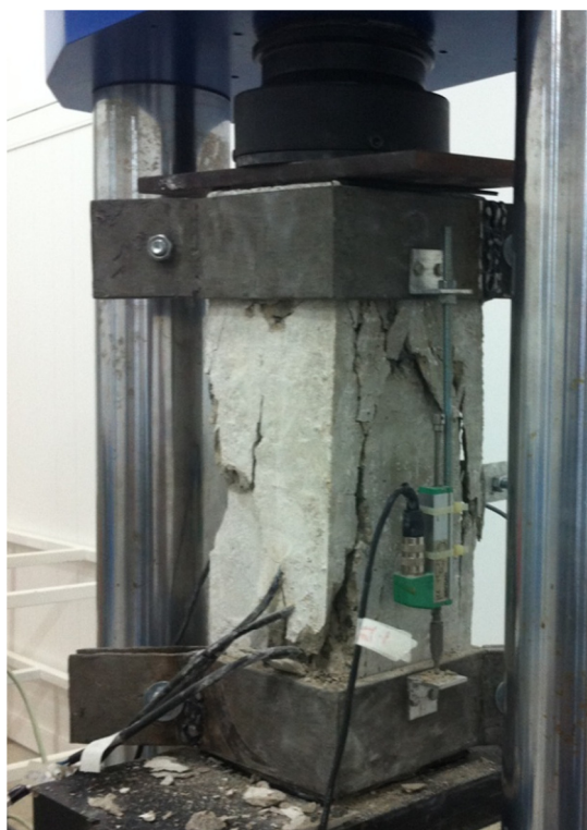
Figura 4.64– Padrão de ruptura do pilar P2-30-4,2-100.
