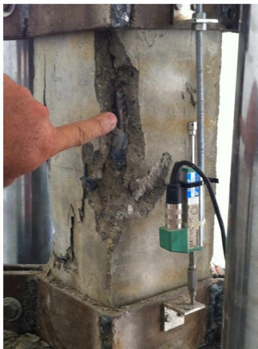
Figura 4.34– Padrão de ruptura final do pilar P1-60-5,0-100.
