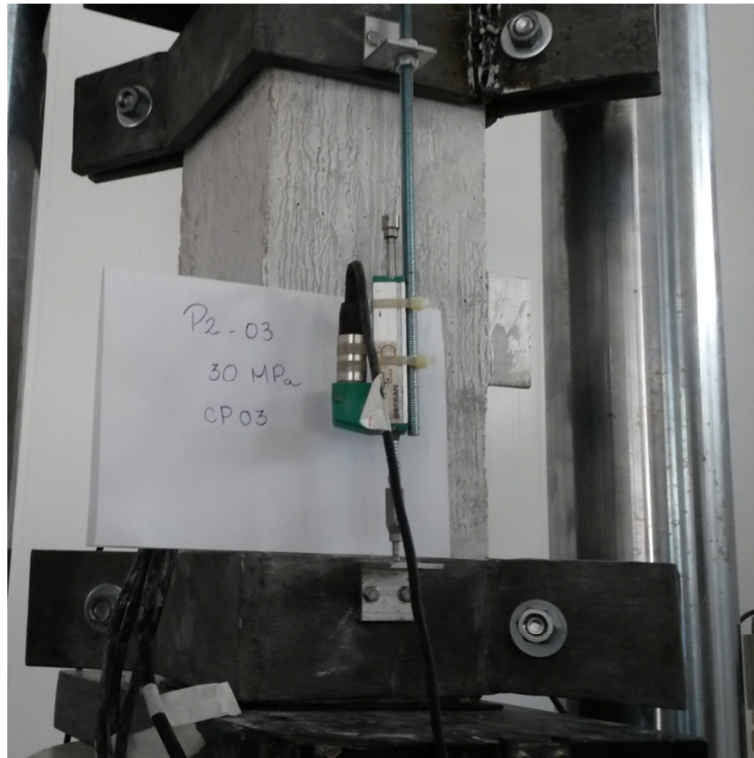
Figura 3.17 – Pilar instrumentado com o colar metálico.
