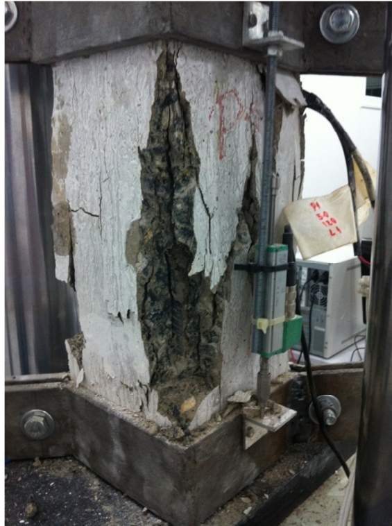
Figura 4.41– Padrão de ruptura final do pilar P1-30-5,0-120.
