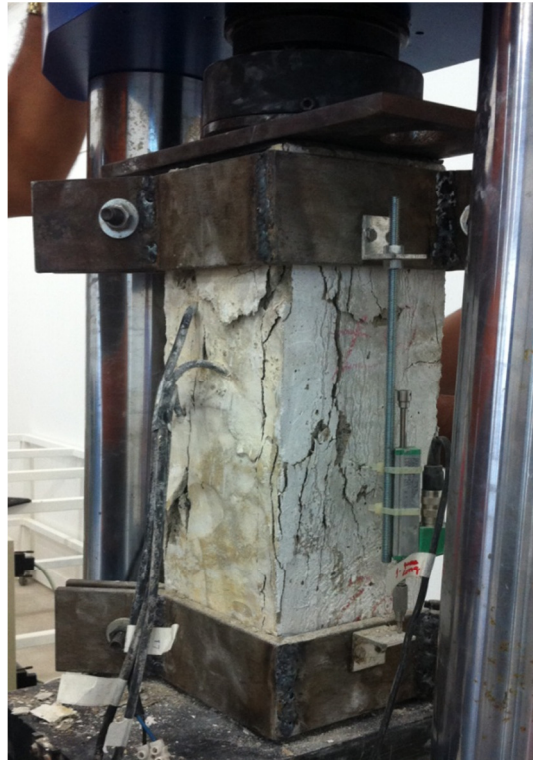
Figura 4.72– Padrão de ruptura do pilar P2-30-4,2-120.
