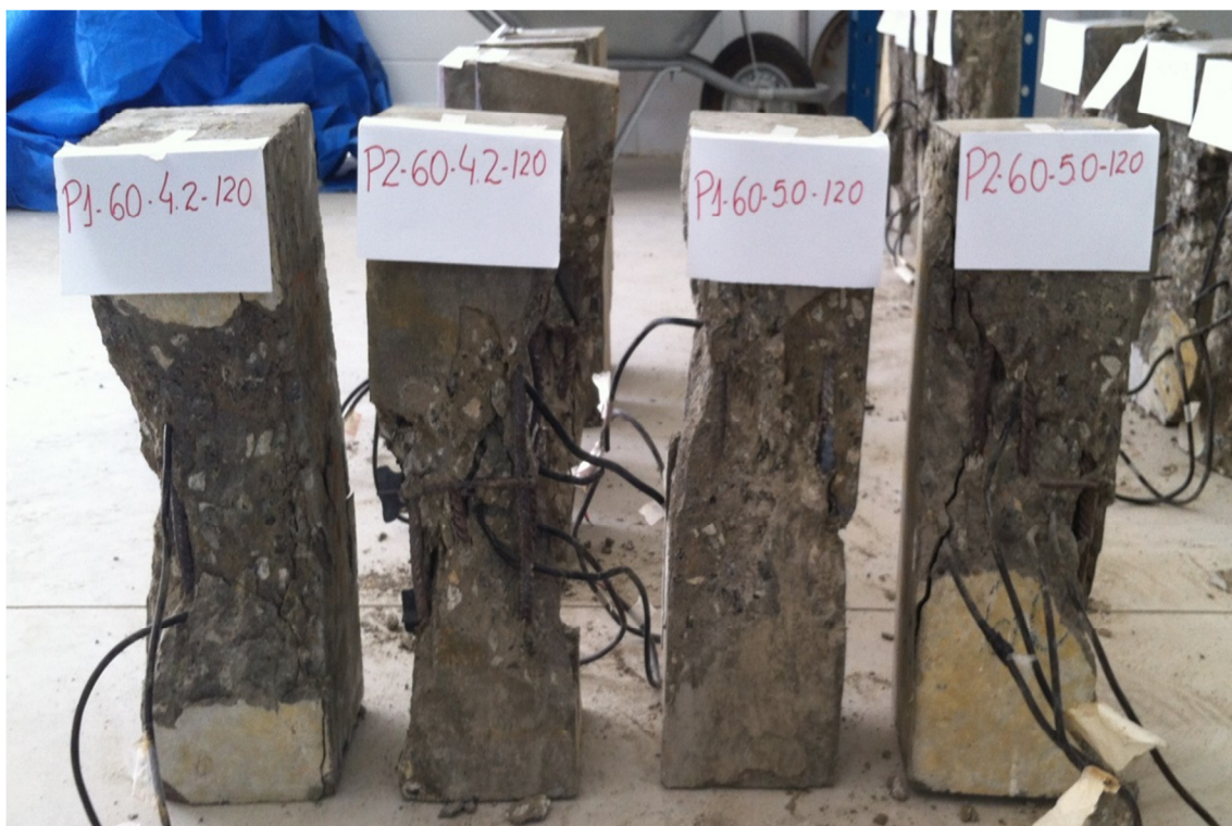
Figura 4.79– Pilares de 60 MPa e espaçamento de 120 mm.
