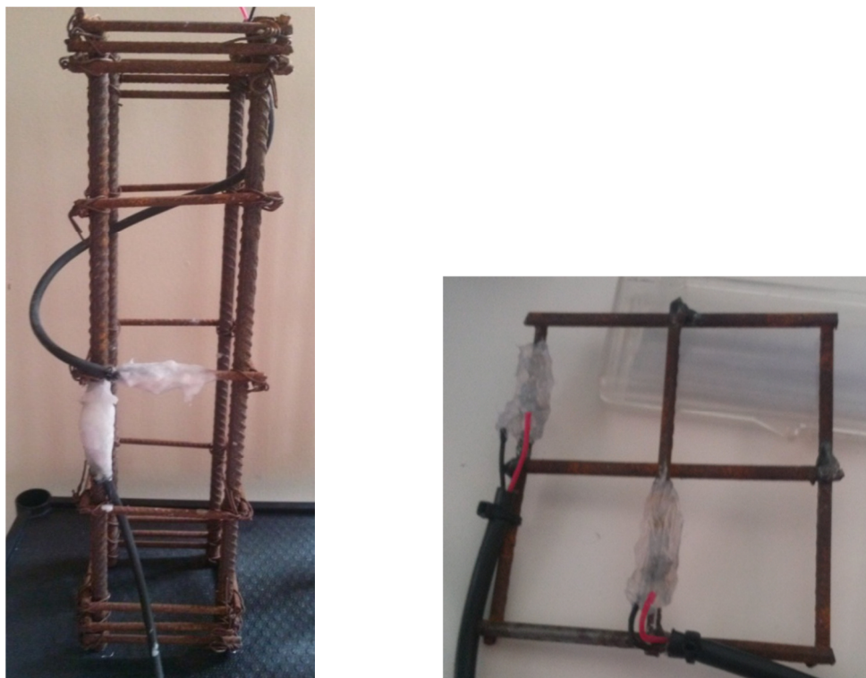
Figura 3.16– Posicionamento dos strain gage longitudinais e transversais.
