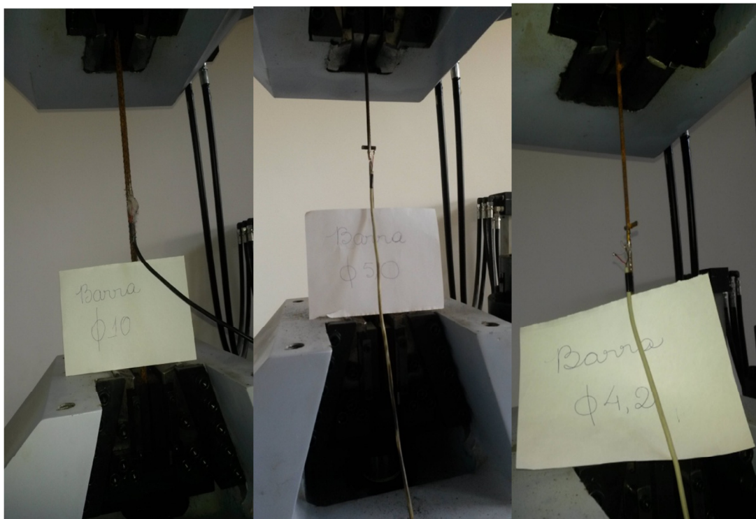
Figura 3.5– Ensaio das armaduras
