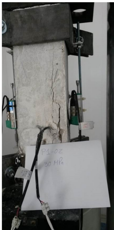
Figura 4.16– Padrão de ruptura do pilar P1-30-5,0-30.
