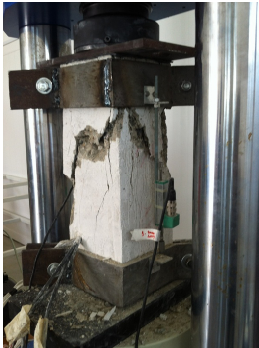
Figura 4.66– Padrão de ruptura do pilar P2-30-5,0-100.
