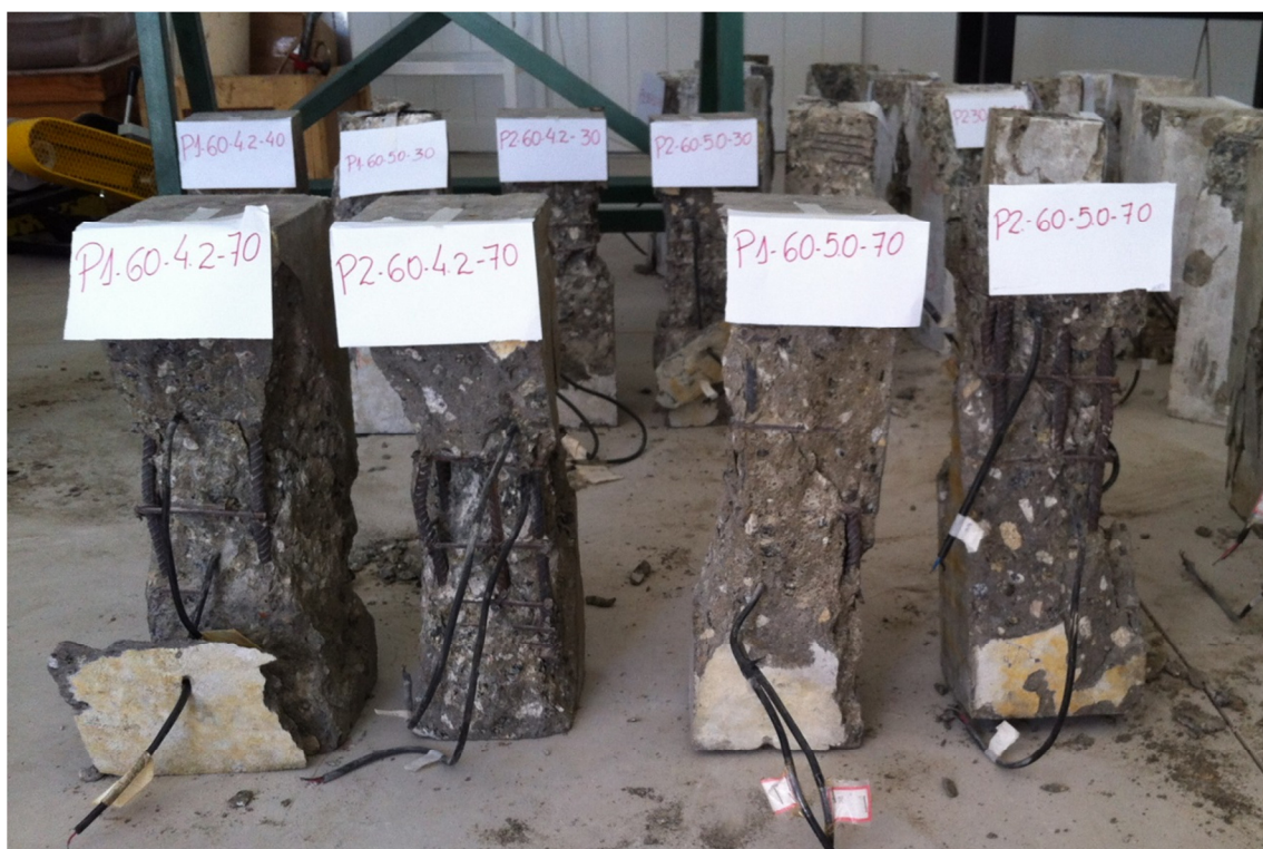
Figura 4.77– Pilares de 60 MPa e espaçamento de 70mm.
