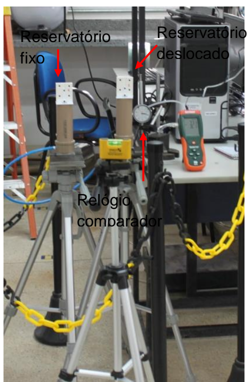
Figura 3. 12 - Sistema instalado no laboratório simulando situação na obra.
