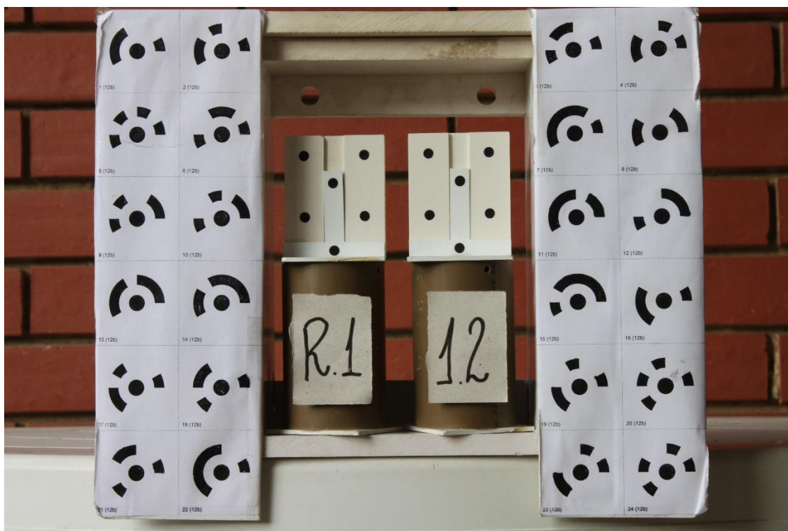
Figura 3. 19 - Calibração do sistema no laboratório para determinação do erro de montagem.
