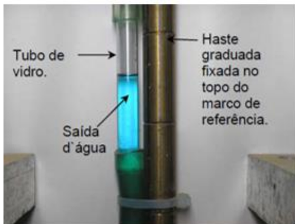
a) Haste metálica e saída d'água no marco de referência.
