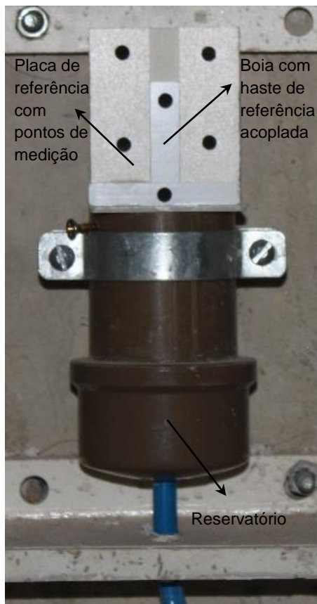
a) Projeto de sistema desenvolvido para monitoramento de recalque.
