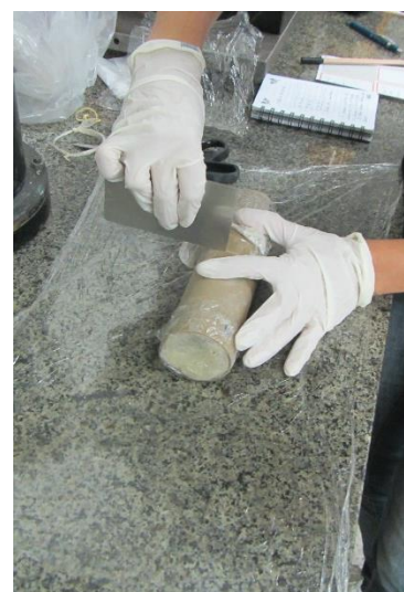
c) Introdução da chapa de aço fina para separação do material dos amostradores.
