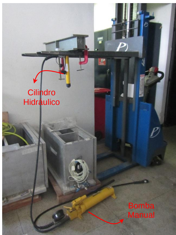
Figura 40: Macaco hidráulico posicionado para cravação dos amostradores
