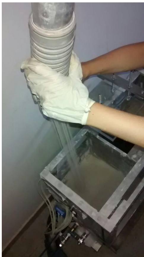
Figura 32: Pluviação do material da camada drenante superior e sobrecarga.
