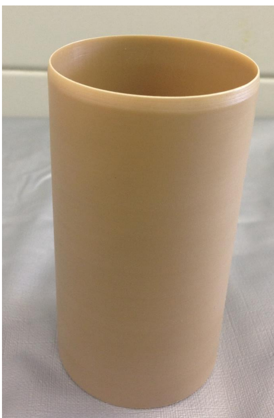
Figura 38: Tubo amostrador de PVC de parede fina
