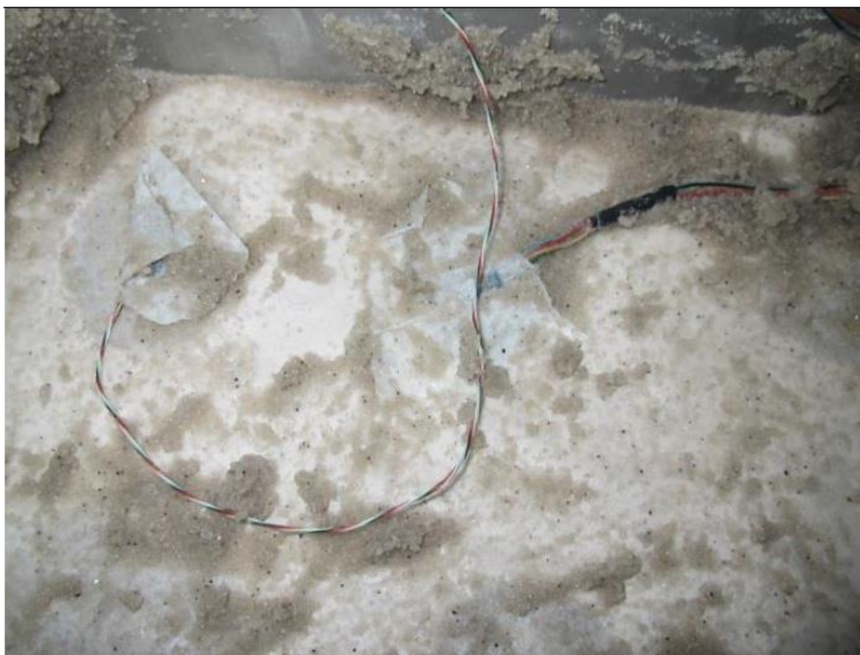
Figura 35: Posicionamento dos transdutores de tensão total.
