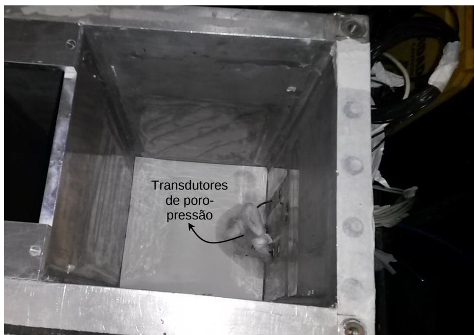
Figura 25: Transdutores de poro-pressão inseridos no container.
