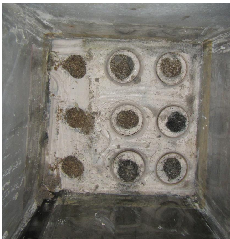
Figura 45: Amostradores cravados na matriz argilosa.
