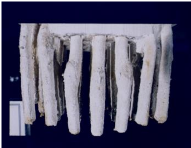
Figura 17: Exumação de colunas de brita de modelos reduzidos de colunas de brita (Hu, 1995)
