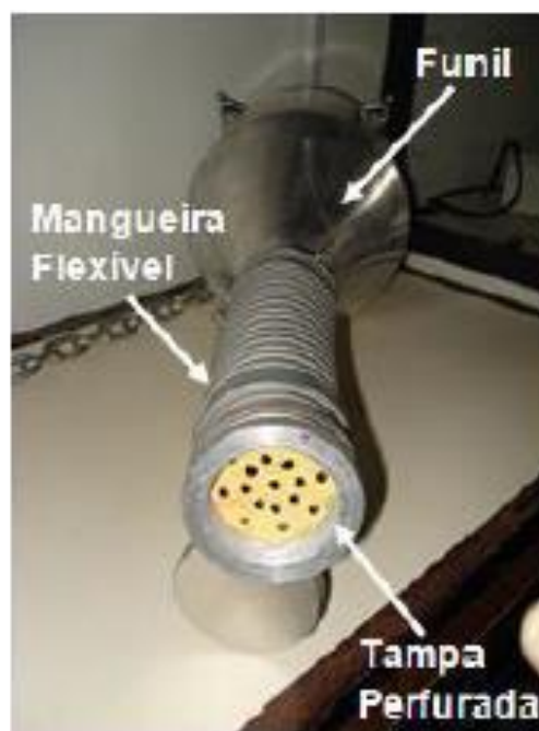
Figura 33: Pluviador desenvolvido na UENF (adaptada de Cardoso, 2010)
