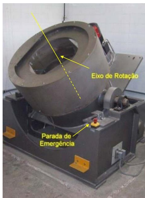
Figura 14: Centrífuga geotécnica de tambor (COPPE).
