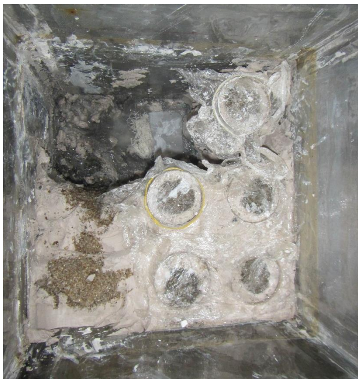
Figura 46: Prevenção de perda de umidade das amostras com utilização de filme de PVC e elástico.
