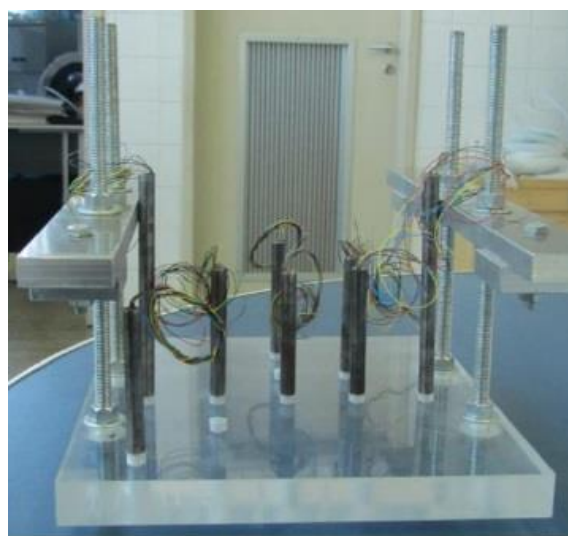
b) Suporte para os LVDTs
