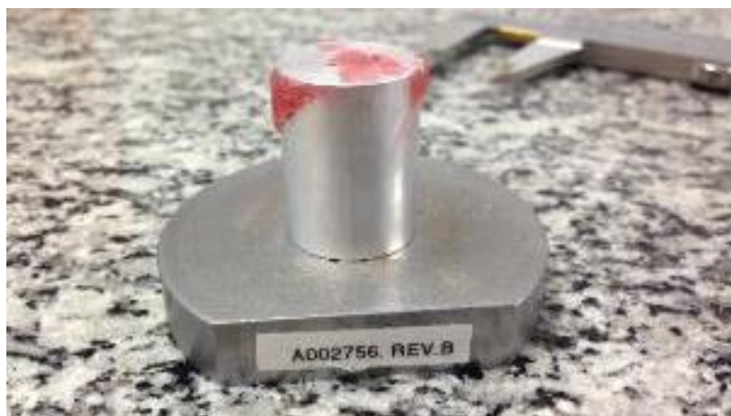
Figura 51: Base de encaixe no tomógrafo.
