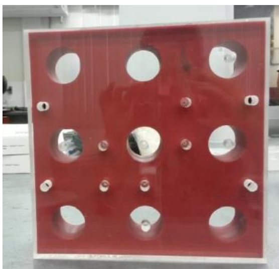
a) Posicionamento dos LVDTs com referência da guia utilizada na construção das colunas
