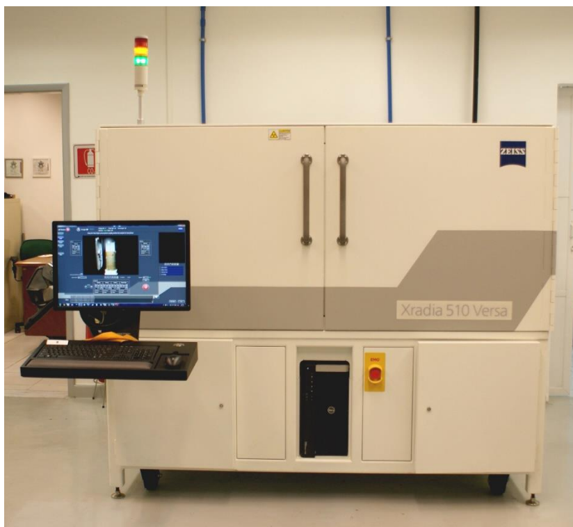
a) Fotografia do tomógrafo e unidade operacional.
