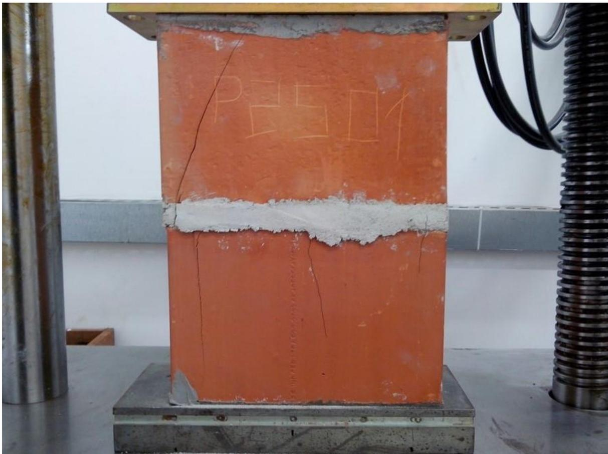
Figura 3.18 – Exemplo de um prisma P25 após a ruptura.
