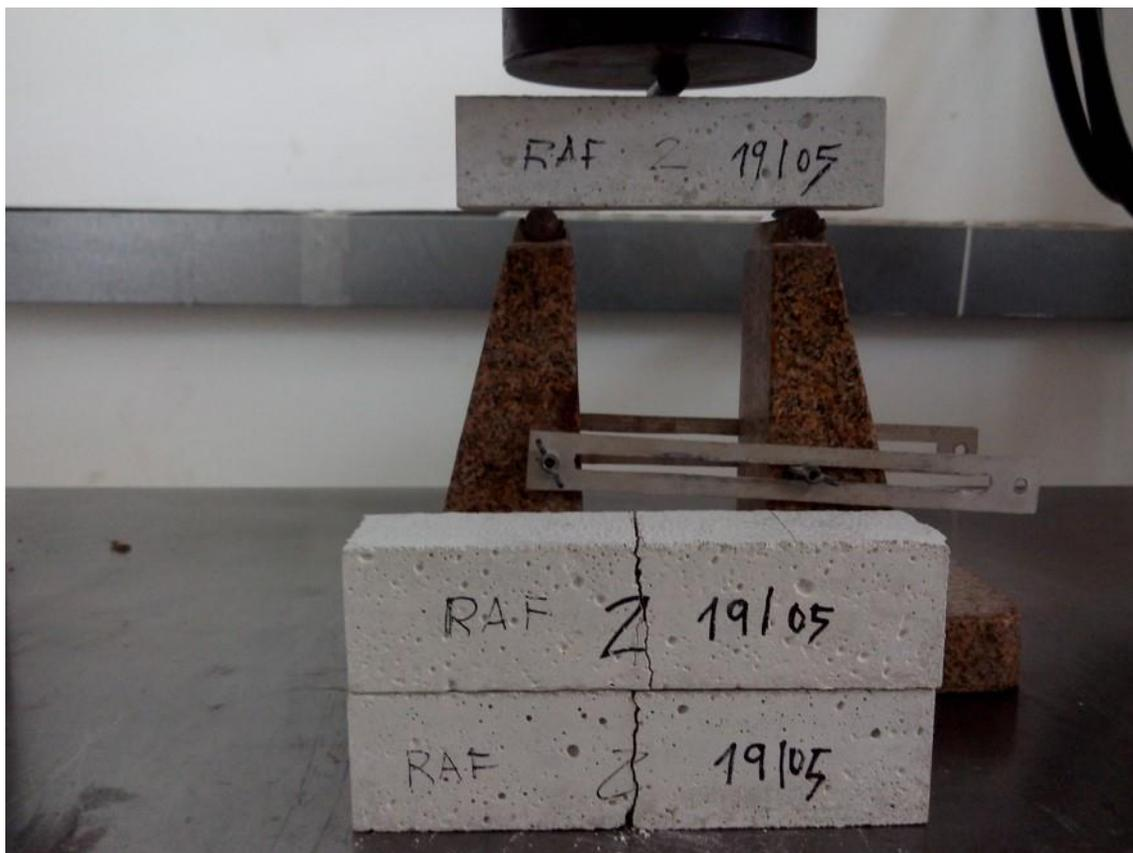
Figura 3.9 – Corpos-de-prova de argamassas submetidos à tração na flexão.
