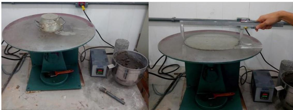
Figura 3.8 – Procedimento de determinação do índice de consistência.
