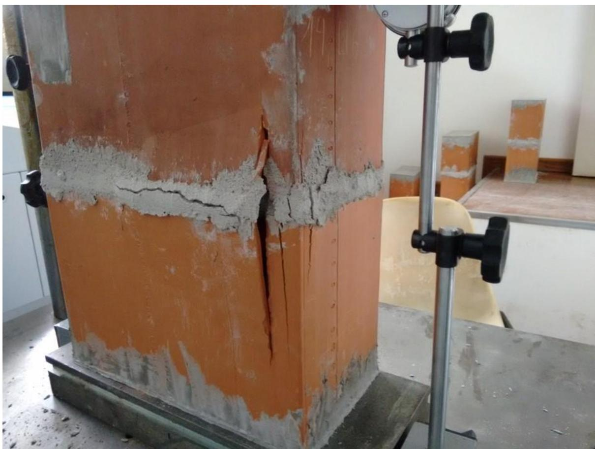
Figura 3.19 – Exemplo de um prisma P210 após a ruptura.
