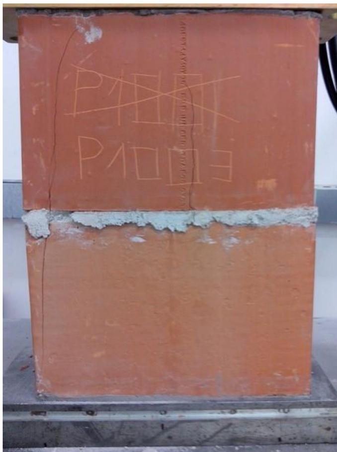
Figura 3.15 – Exemplo de um prisma P10 após a ruptura.
