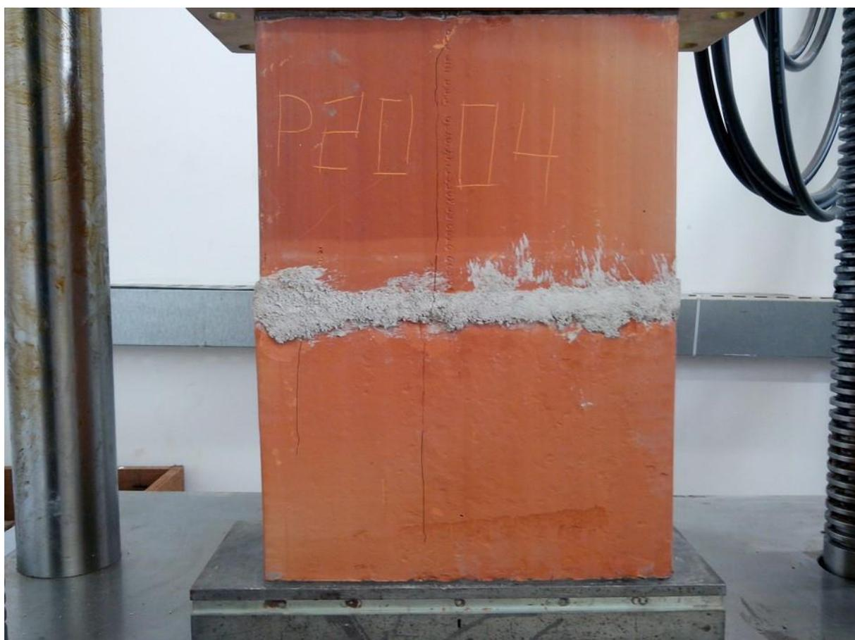
Figura 3.17 – Exemplo de um prisma P20 após a ruptura.
