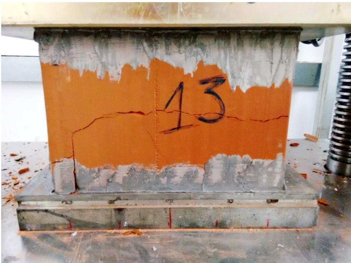
Figura 3.6 – Exemplo do bloco após a ruptura.
