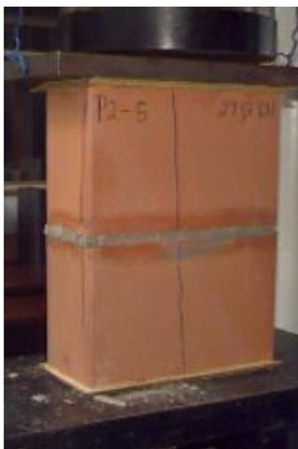
Figura 2.7 – Modo de ruptura de prismas de 2 blocos. (MACHADO *et al.*, 1999 *apud* GARCIA e RAMALHO, 2007)
