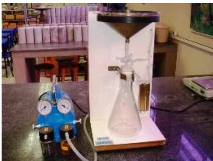
Figura 3.11 – Sistema de filtração forçada com um funil de Büchner. (UDESC JOINVILLE, 2015)
