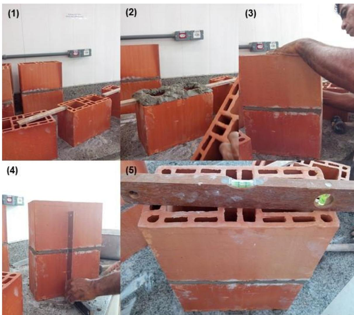
Figura 3.12 – Preparo do prisma: (1) posicionamento das taliscas; (2) espalhamento da argamassa; (3) acomodação do bloco superior; (4) verificação do prumo; (5) verificação do nível.
