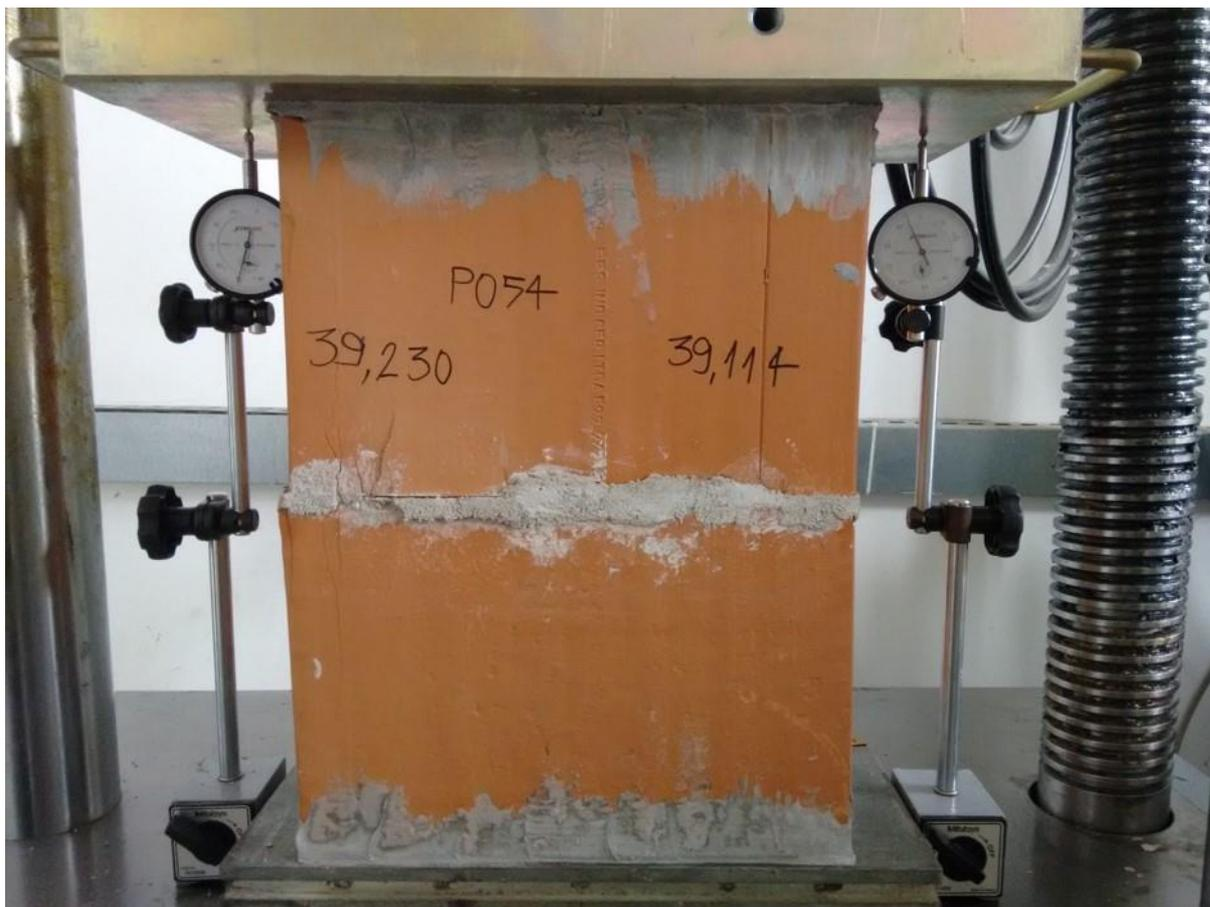
Figura 3.13 – Prisma P10504 com instrumentação para a determinação do módulo de deformação ( $E_p$ ).
