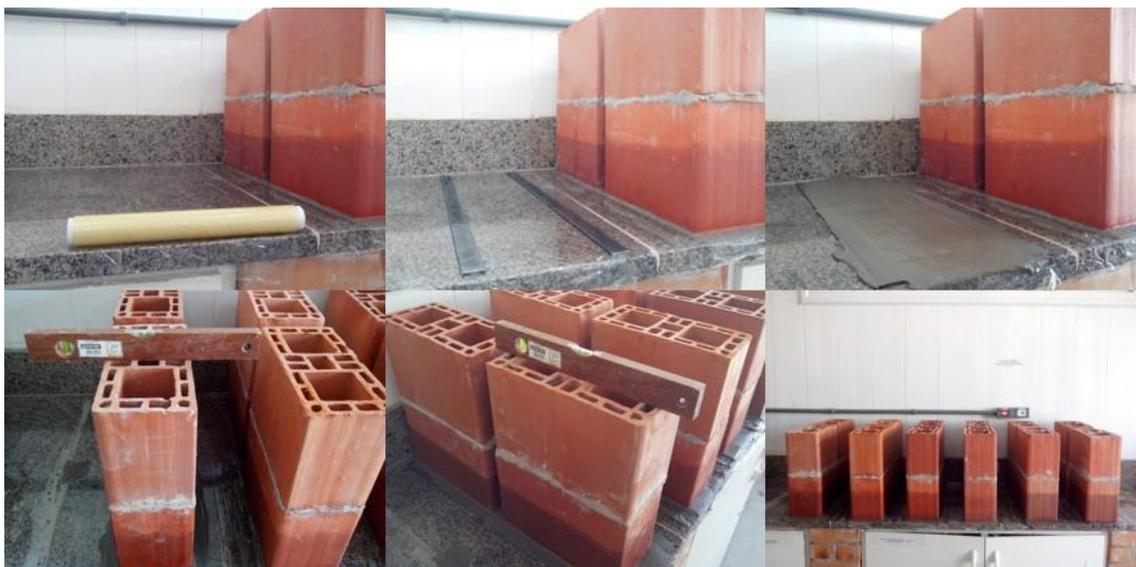
Figura 3.5 – Etapas de capeamento dos corpos-de-prova.
