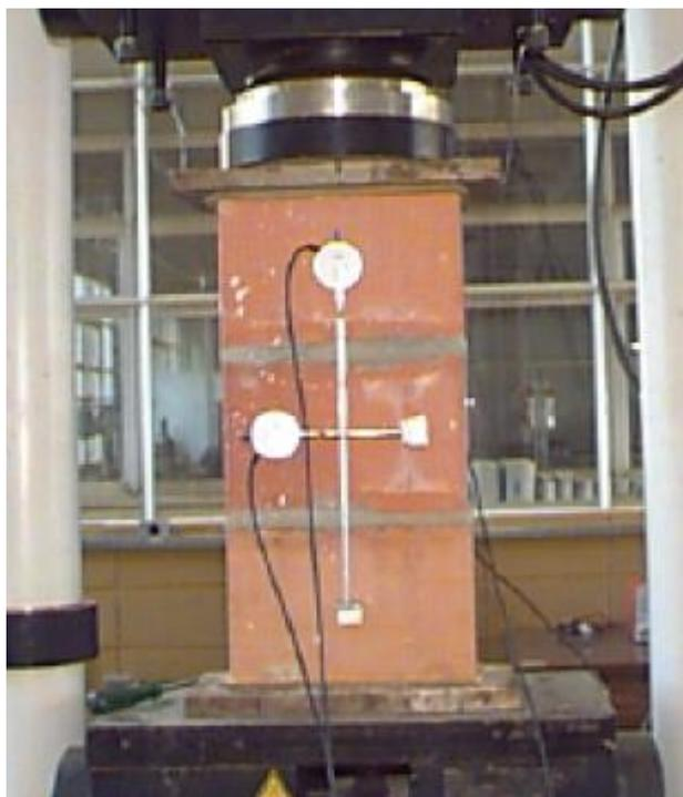
Figura 2.10 – Instrumentação do prisma de três blocos. (GARCIA, 2000)
