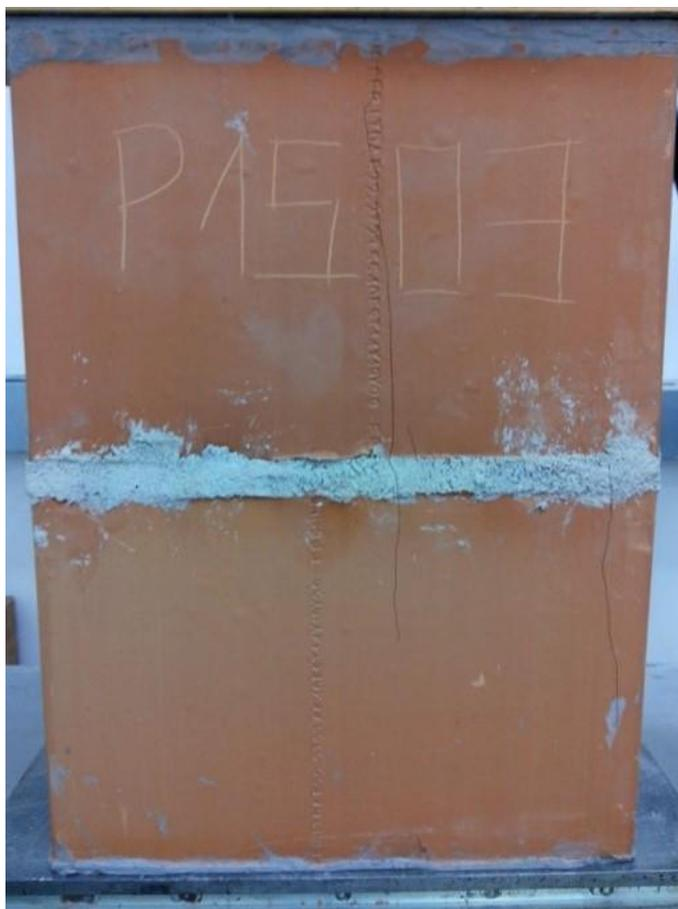
Figura 3.16 – Exemplo de um prisma P15 após a ruptura.
