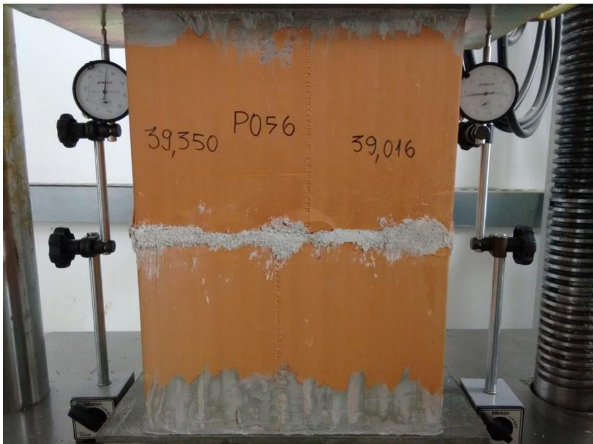
Figura 3.14 – Exemplo de um prisma P05 após a ruptura.
