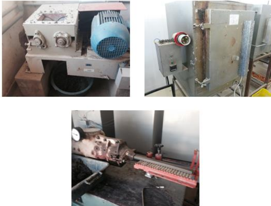
Figura 3.4 – Laminadora, forno e extrusora utilizados na fabricação dos corpos de prova
