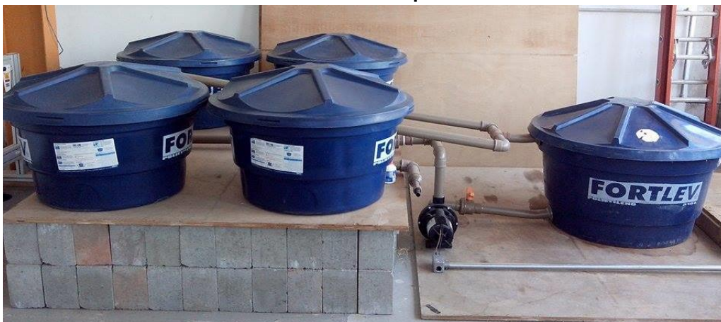
Figura 3.14 – Vista lateral do esquema de bombeamento do vinhoto entre as caixas d'água.
