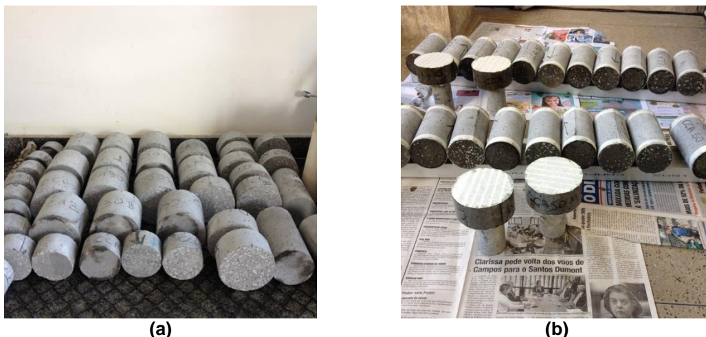
Figura 3.10 – Corte (a) e pintura (b) das bases dos concretos antes do ataque ácido.
