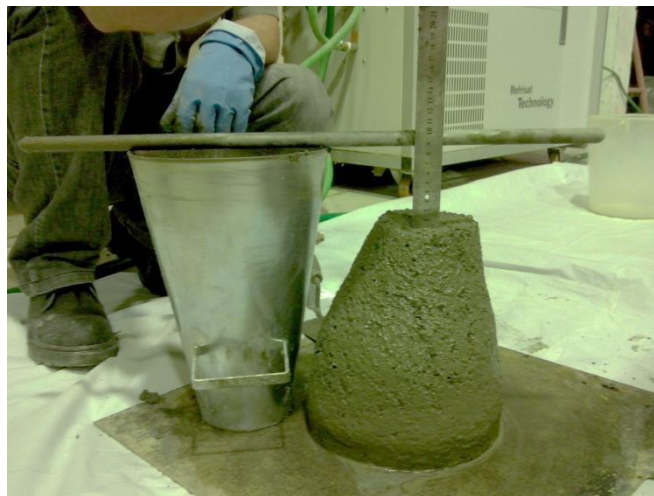
Figura 3.7 – Ensaio de abatimento do tronco de cone do REF55.
