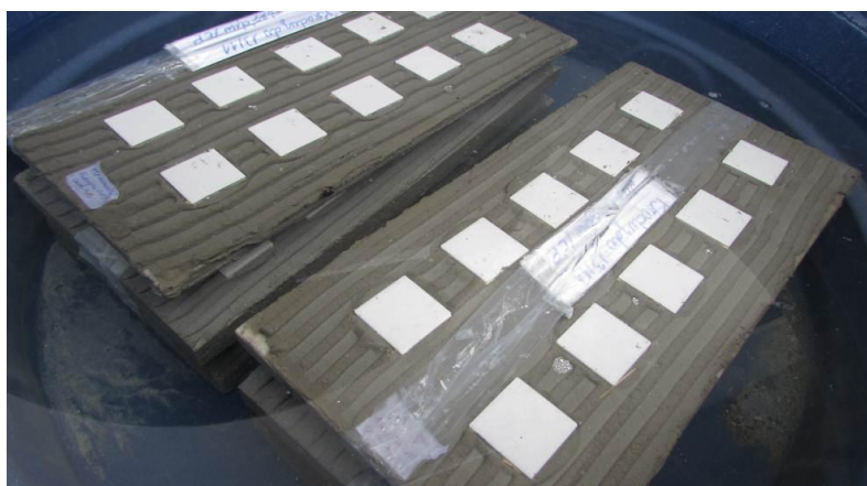
Figura 3.21 - Substrato padrão com a argamassa aplicada e pastilhas cerâmicas em cura submersa em água.
