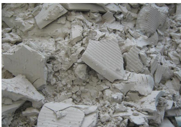
Figura 0.8 - Aspecto do resíduo após a passagem pelo filtro prensa (Viminas, 2013).
