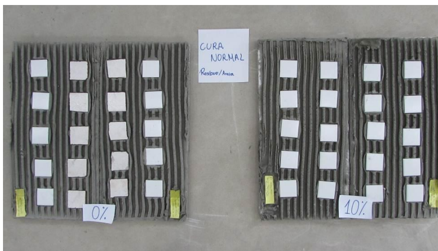
Figura 3,20 - Substrato padrão com a argamassa aplicada e pastilhas cerâmicas em cura normal.
