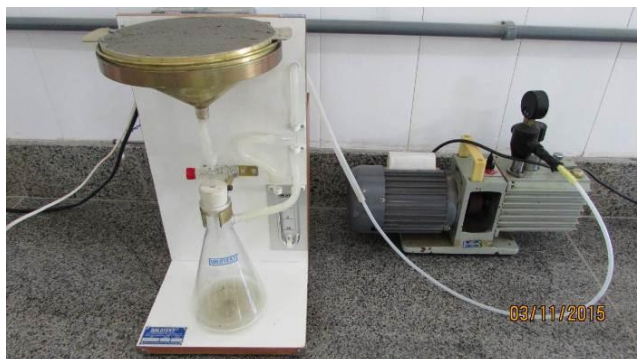
Figura 3.15 - Ensaio de Retenção de água
