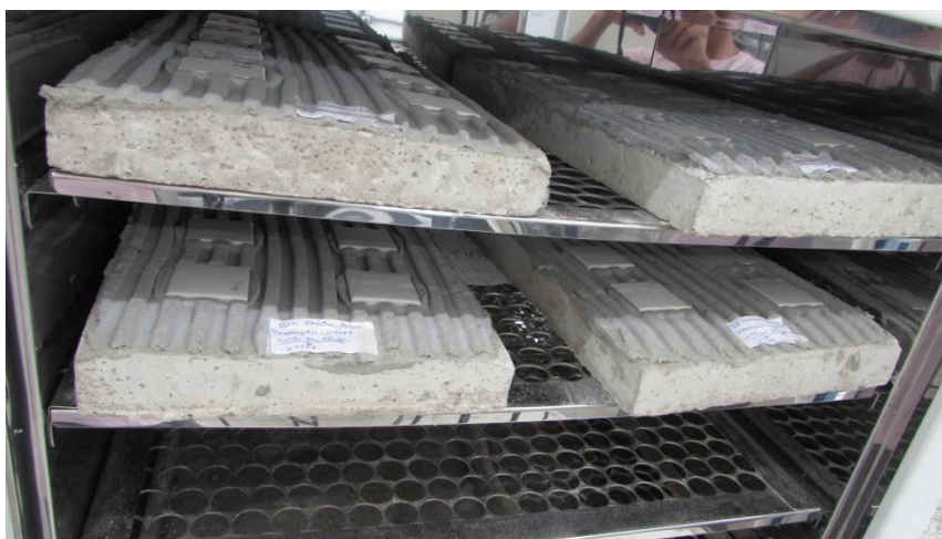
Figura 3.22- Substrato padrão com a argamassa aplicada e pastilhas cerâmicas em cura em estufa ( 70^\circ\text{C} ).
