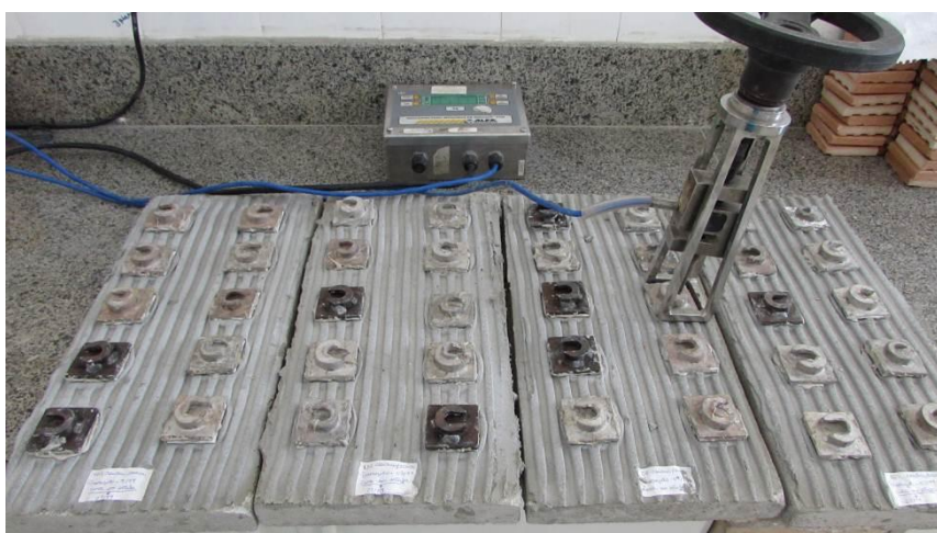
Figura 3.23 – Ensaio de arrancamento
