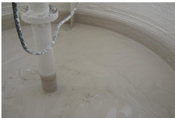
Figura 0.7 - Resíduo proveniente do silo de decantação depositado no tanque agitador, para evitar ressecamento da lama (Viminas, 2013 ).
