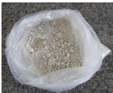
Figura 3.4 - Resíduo seco e destorroado.
