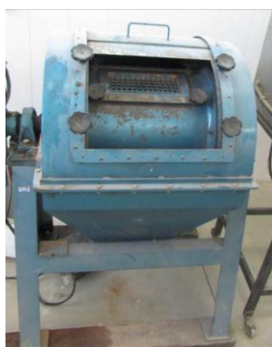
Figura 3.3 - Equipamento utilizado para destorroar o resíduo.
