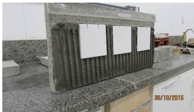
Figura 3.17 - Posicionamento das placas cerâmicas no substrato padrão.
