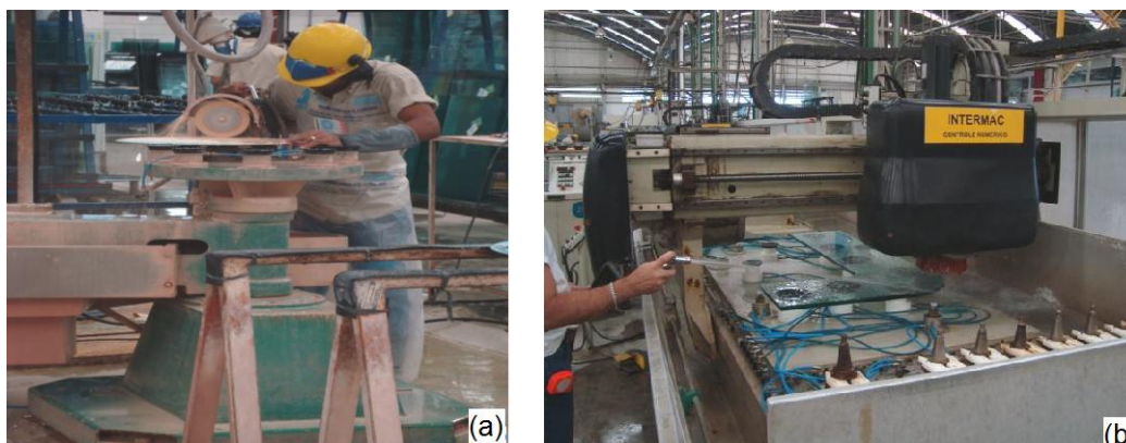
Figura 0.5 - Maquinário para diferentes tipos de lapidação de chapas de vidro. (a) processo manual de lapidação, para confecção de peças circulares, totalmente moldadas pelo funcionário operador do maquinário; (b) equipamento para cortes, furos e lapidação.
