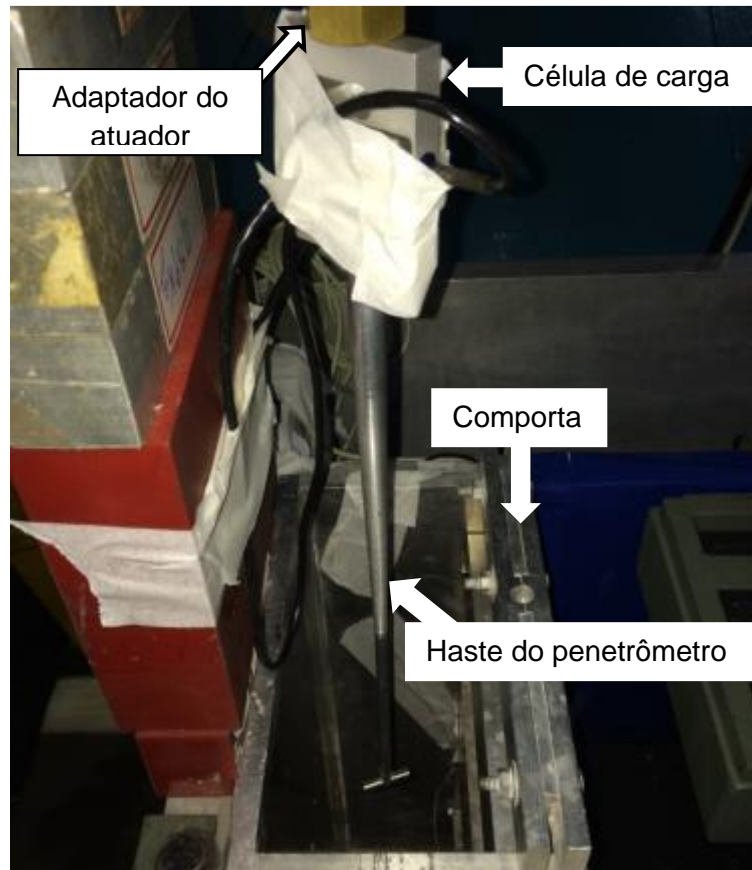
Figura 3.10: Vista em detalhe do penetrômetro barra-T já acoplado à célula de carga e ao atuador elétrico.
