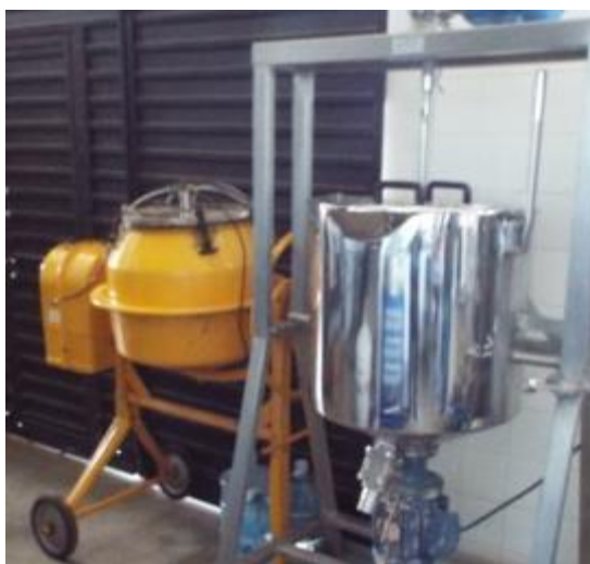
Figura 3.5: À direita, o misturador coloidal do laboratório da centrífuga geotécnica do LECIV.
