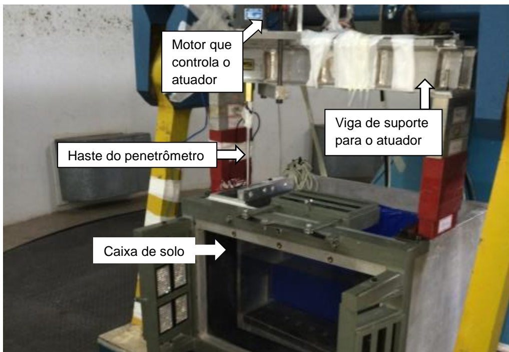
Figura 3.11: Estrutura montada para a execução do ensaio de cravação do penetrômetro barra-T.
