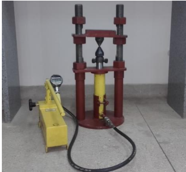
Figura 4.12 – Equipamento para os ensaios de carregamento pontual
