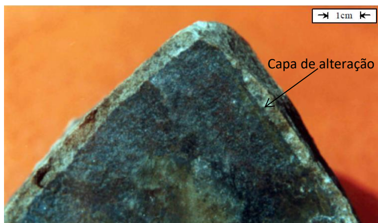
Figura 5.26 - Capa de alteração- basalto de Marimbondo, Maia(2001)
