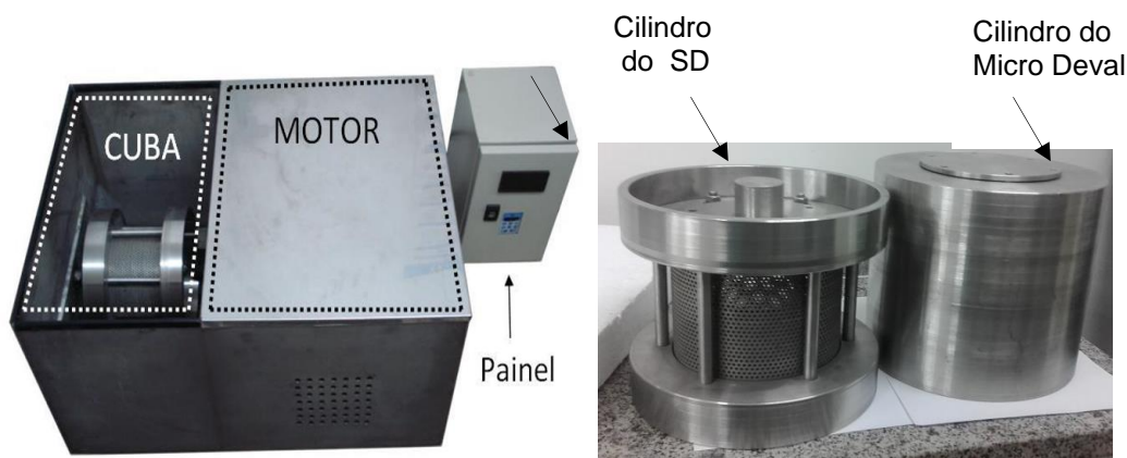
Figura 4.8 - Equipamento para ensaio de durabilidade e Micro-Deval
