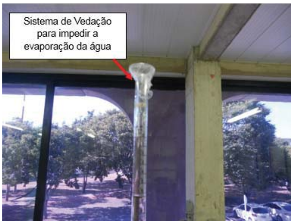
Figura 34 - Detalhe do sistema de vedação utilizado para o ensaio de adensamento com medida de permeabilidade.
