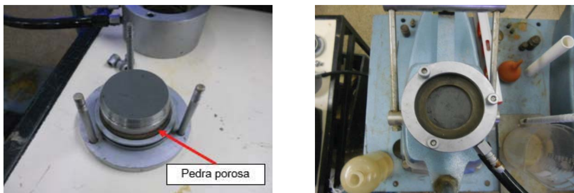
Figura 32 – Ilustração da montagem do ensaio de adensamento.
