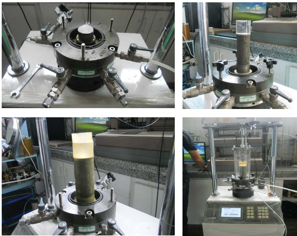
Figura 37 - Procedimentos da montagem do ensaio triaxial
