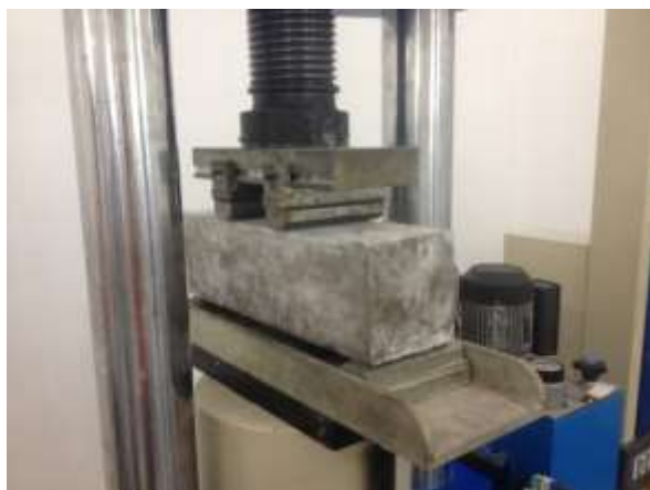
Figura 27 - Configuração do ensaio de resistência à tração na flexão
