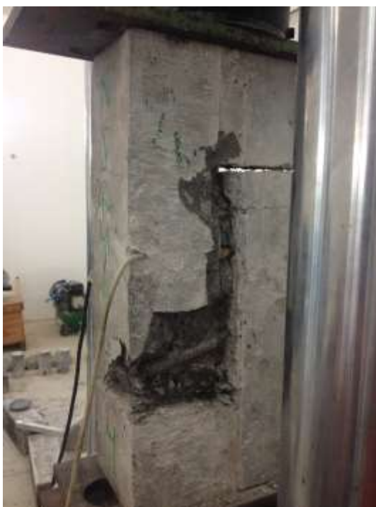
Figura 36 - Corpo de prova após ruptura
