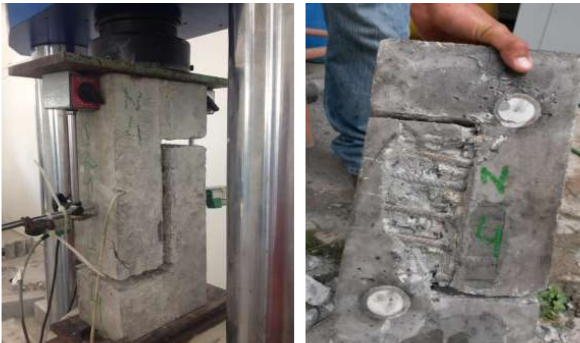
Figura 70 - Corpo de prova N-PO-1-10,20 no momento do ensaio e após a ruptura
