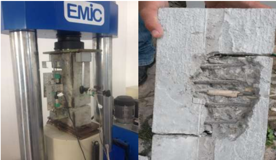
Figura 94 - Corpo de prova N-PO-2-12,71 no momento do ensaio e após ruptura
