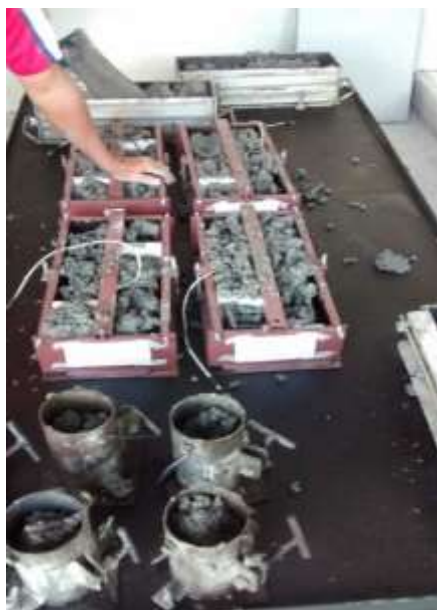
Figura 25 - Concretagem utilizando mesa vibratória
