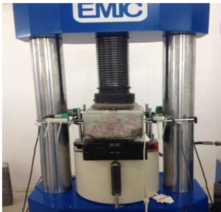
Figura 84 - Pré-fissuração do corpo de prova N-PO-2-7,64
