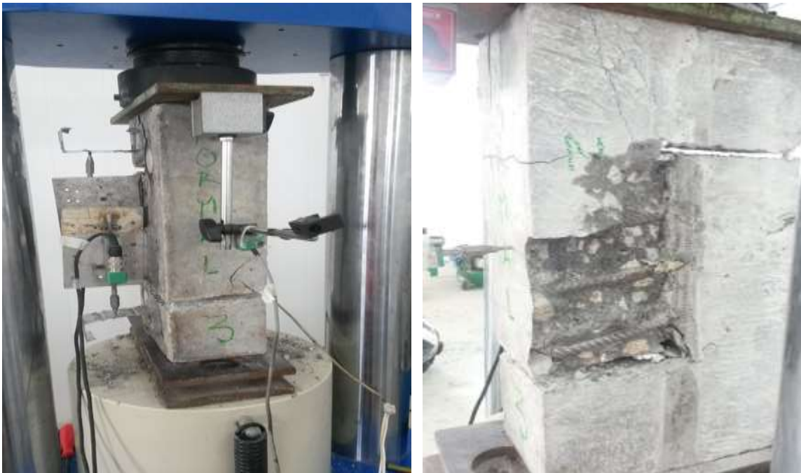
Figura 66 - Corpo de prova N-PO-1-7,64 no momento do ensaio e após ruptura
