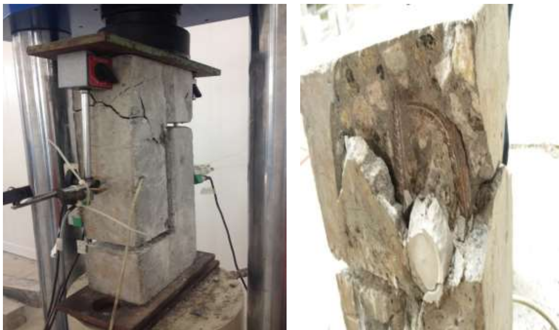
Figura 75 - Corpo de prova N-PO-1-12,71 no momento do ensaio e após ruptura
