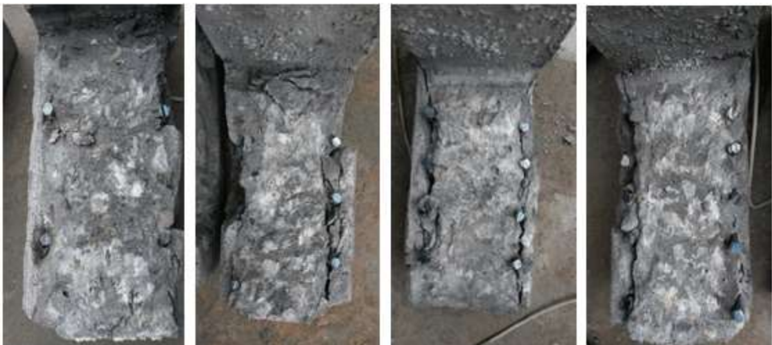
Figura 119 - Superfície de ruptura dos corpos de prova da série C
