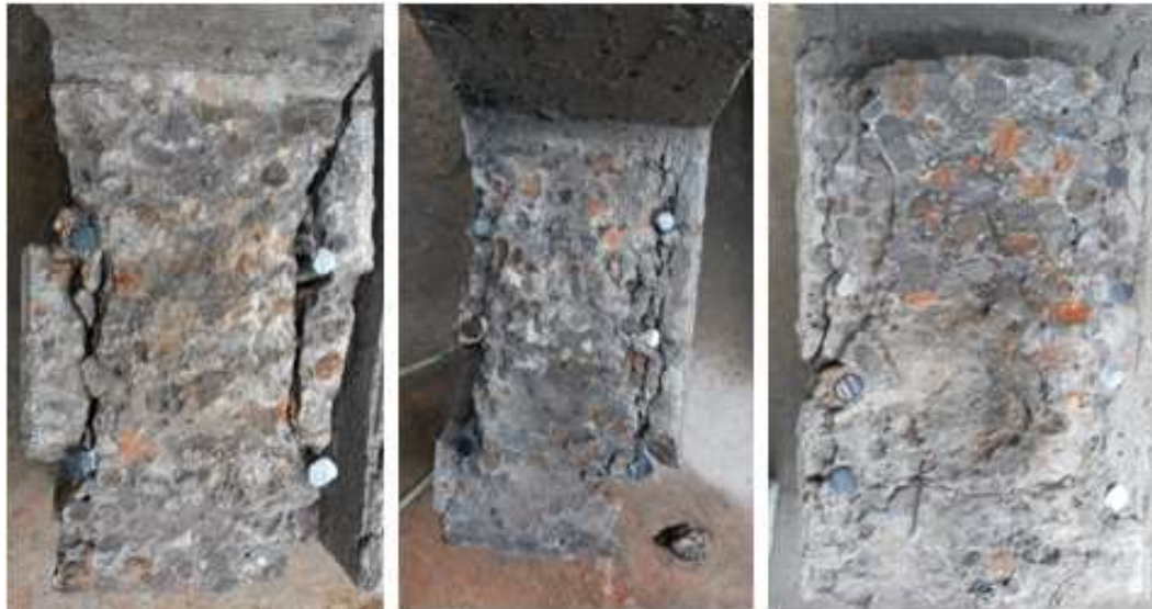
Figura 117 - Superfície de ruptura dos corpos de prova da série A
