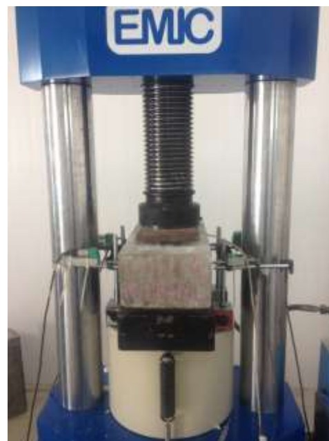
Figura 30 - Esquema e ensaio de pré-fissuração.
