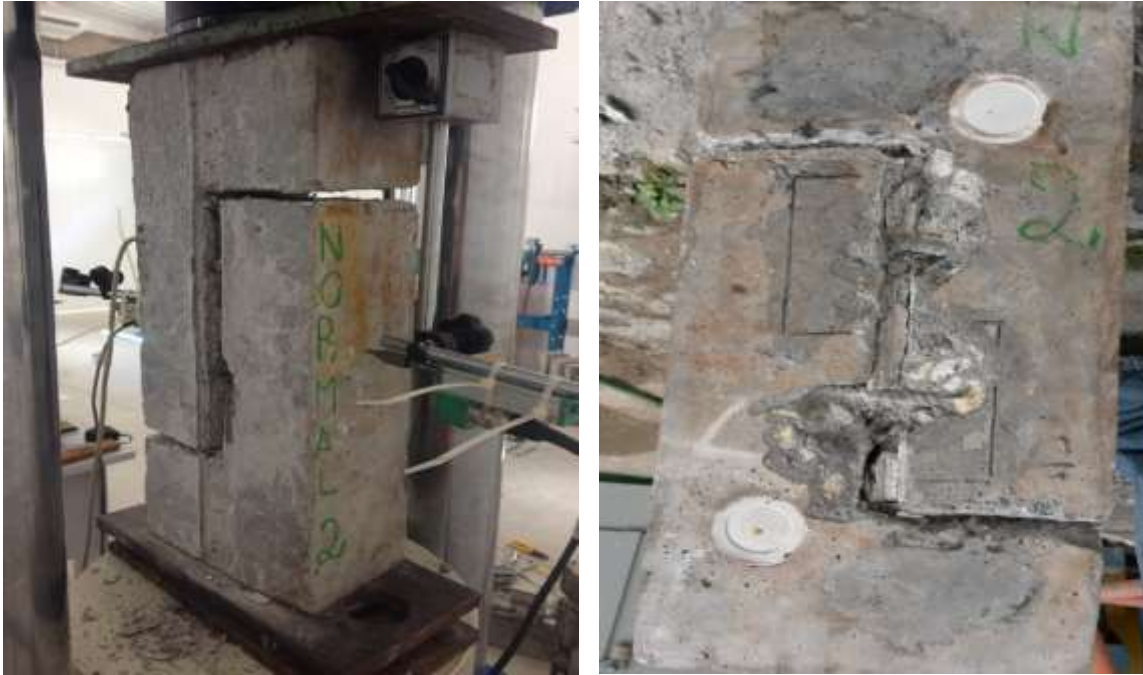
Figura 61- Corpo de prova N-PO-1-4,79 no momento do ensaio e após ruptura
