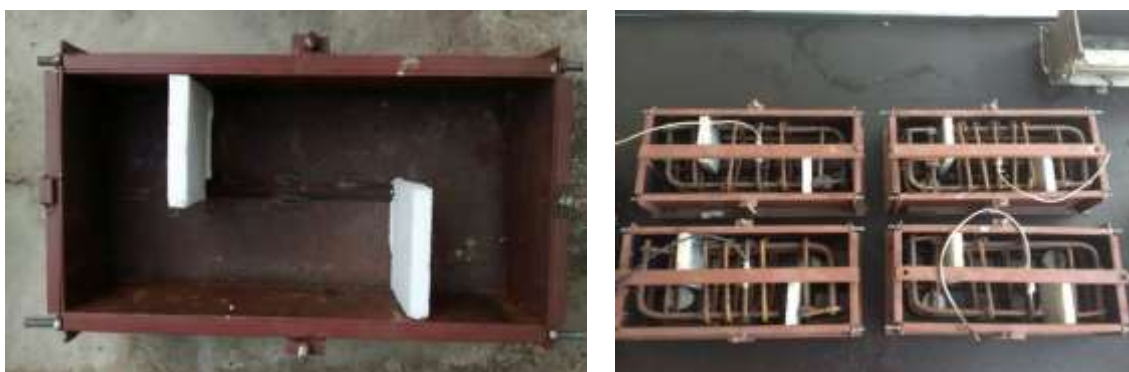
Figura 24 - Forma metálica para produção dos corpos de prova.
