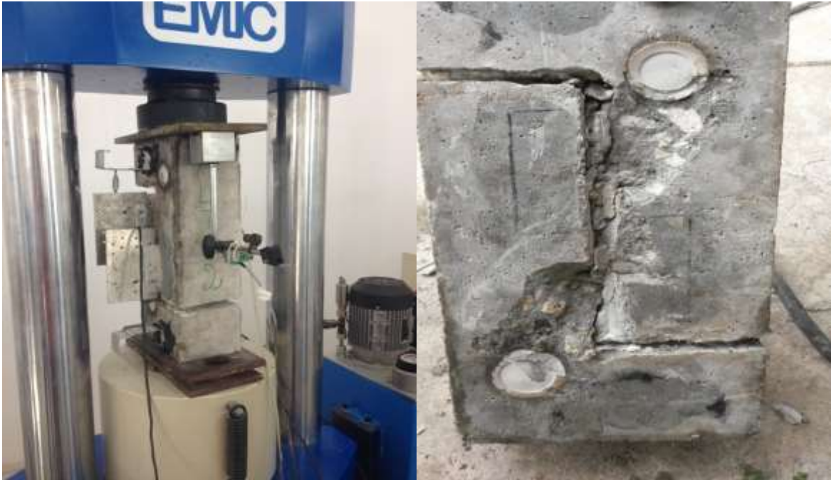
Figura 80 - Corpo de prova N-PO-2-4,79 no momento do ensaio e após ruptura
