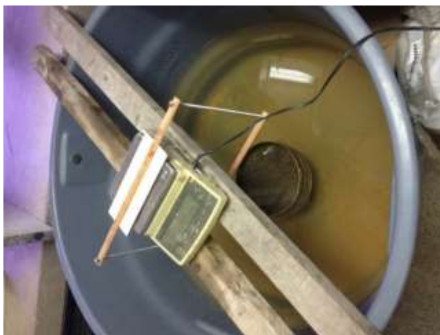
Figura 17 - Esquema de ensaio para avaliação da absorção de água.
