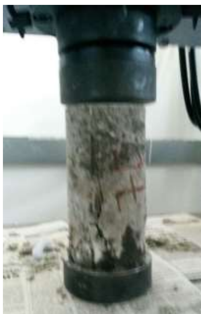
Figura 26 - Ensaio de resistência à compressão
