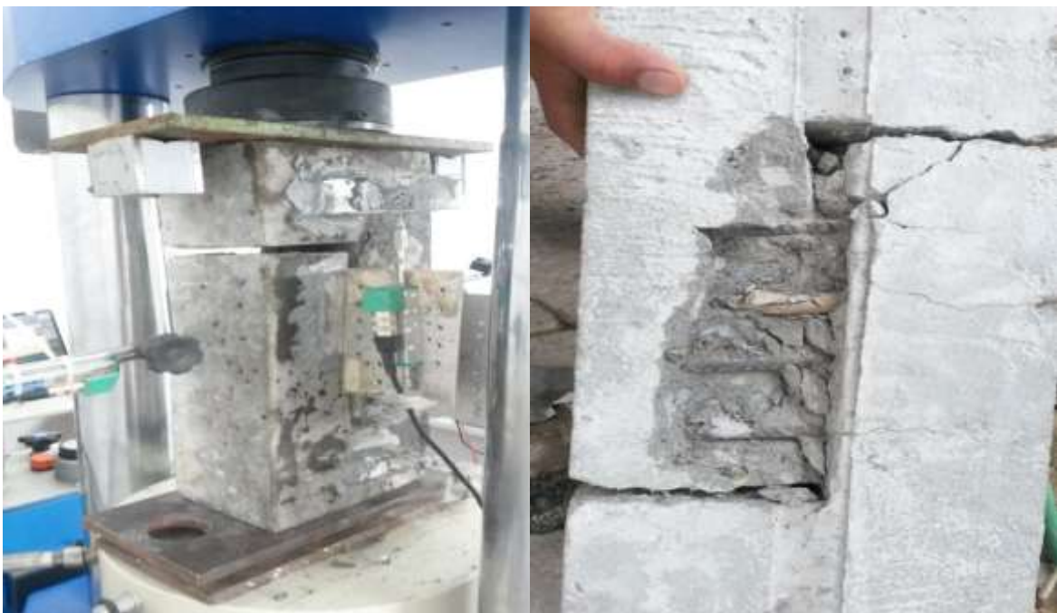
Figura 89 - Corpo de prova N-PO-2-10,20 no momento do ensaio e após ruptura
