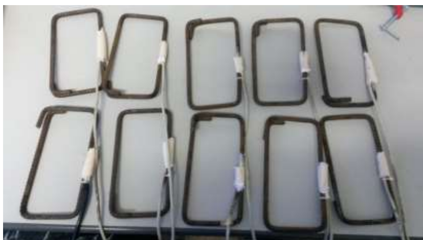
Figura 32 - Estribos instrumentados com strain gage .
