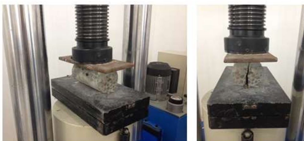
Figura 28 - Disposição do ensaio de resistência à tração indireta
