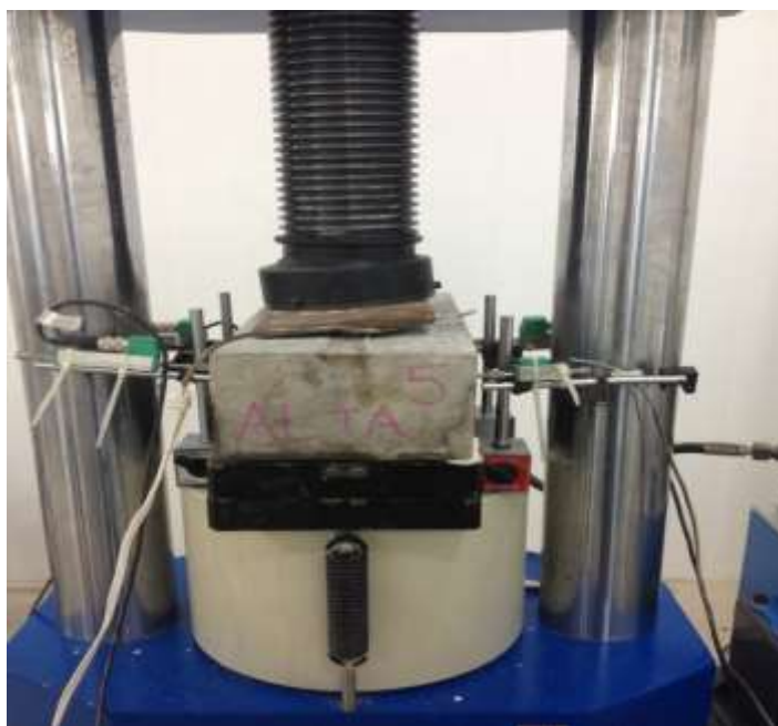
Figura 93 - Pré-fissuração do corpo de prova N-PO-2-12,71
