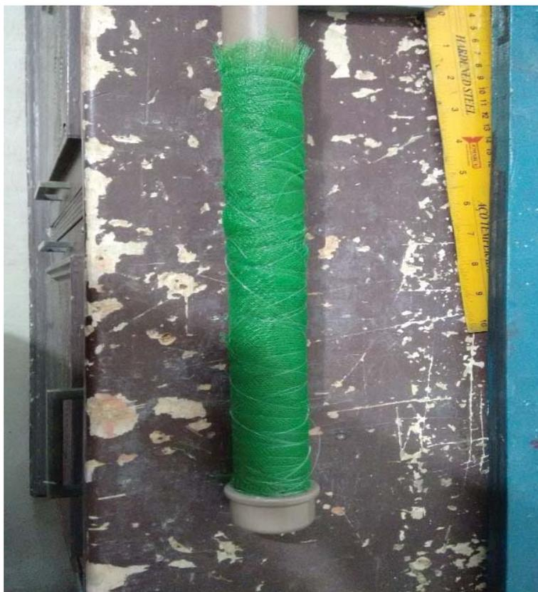
Figura 45 - Detalhe do filtro do piezômetro
