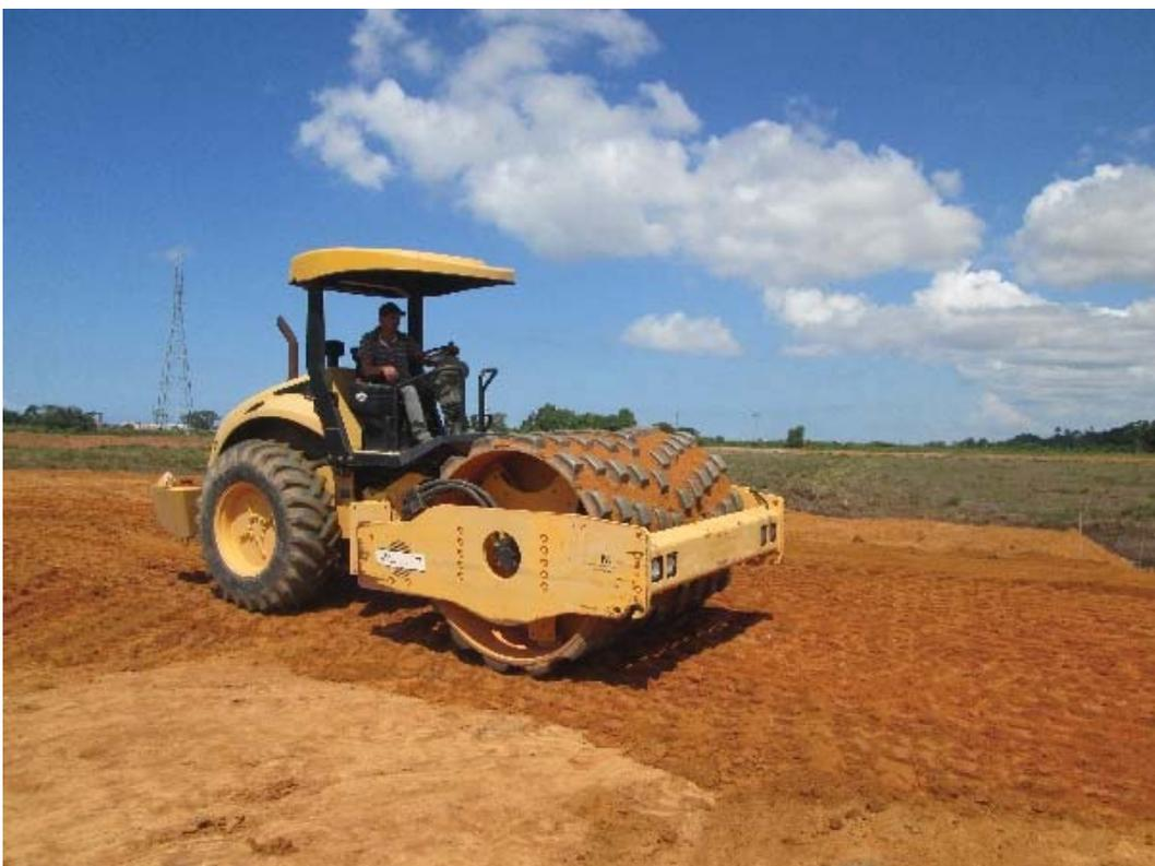
Figura 49 - Rolo vibratório denteado
