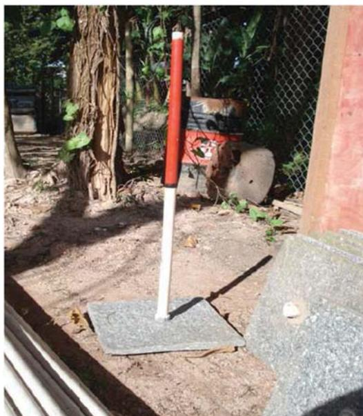
*Figura 9 - Placa de recalque (Teixeira,2012)*
