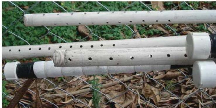
(a) Detalhe dos furos no piezômetro
