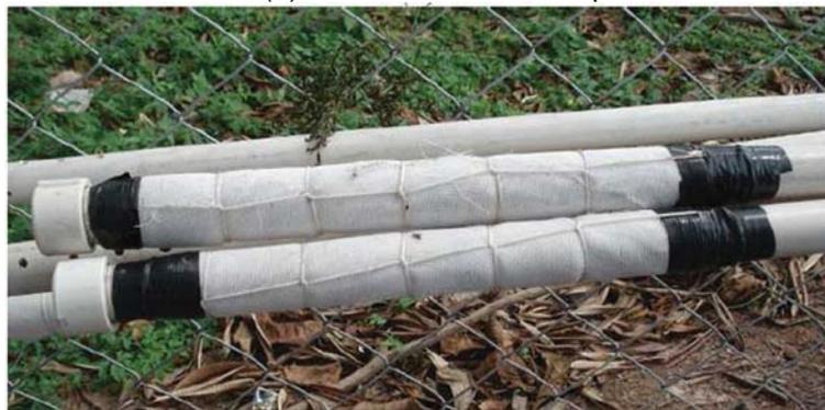
(b) Piezômetros prontos para serem instalados
