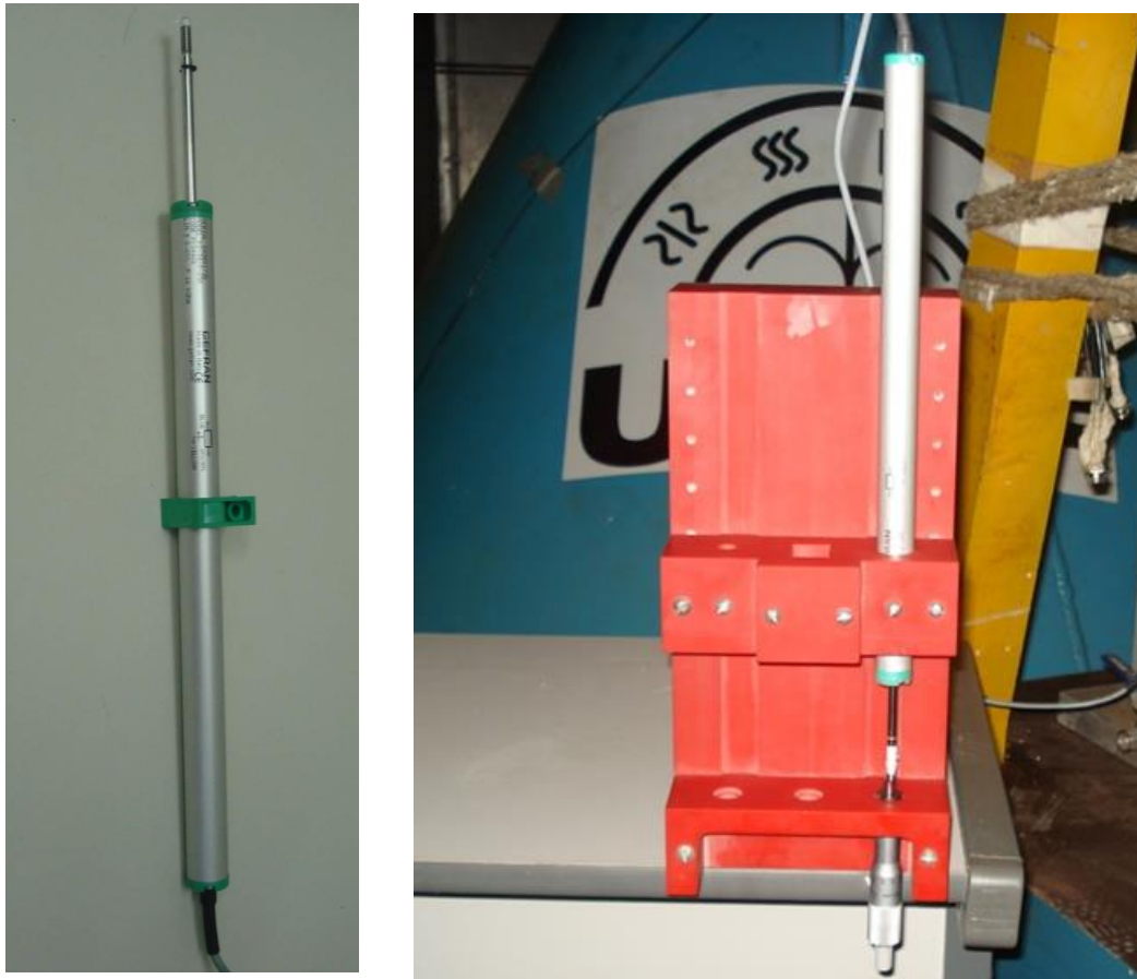
Figura 3.29 - Régua potenciométrica e Aparato utilizado para calibração da régua potenciométrica.
