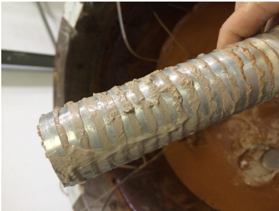
Figura 6.13 – Estaca mais rugosa após o ensaio de arrancamento.
