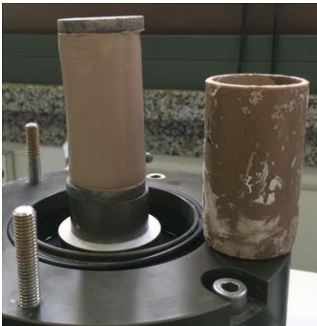
Figura 3.20 – Montagem do ensaio triaxial – corpo de prova.
