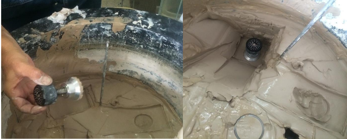
Figura 5.10- Realização do ensaio Torvane após o ensaio de arrancamento.
