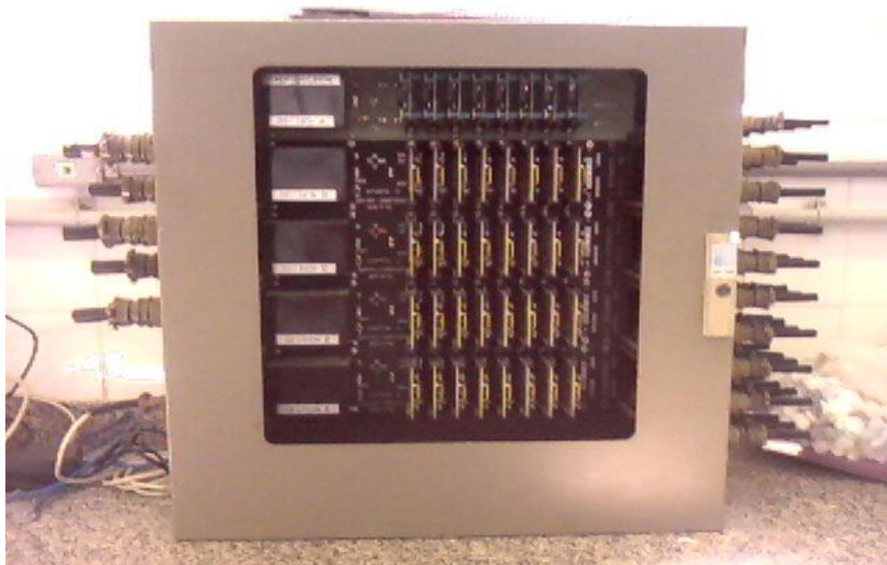
Figura 3.23 - Condicionador de sinais instalado no braço da centrífuga (Brum Junior, 2009).
