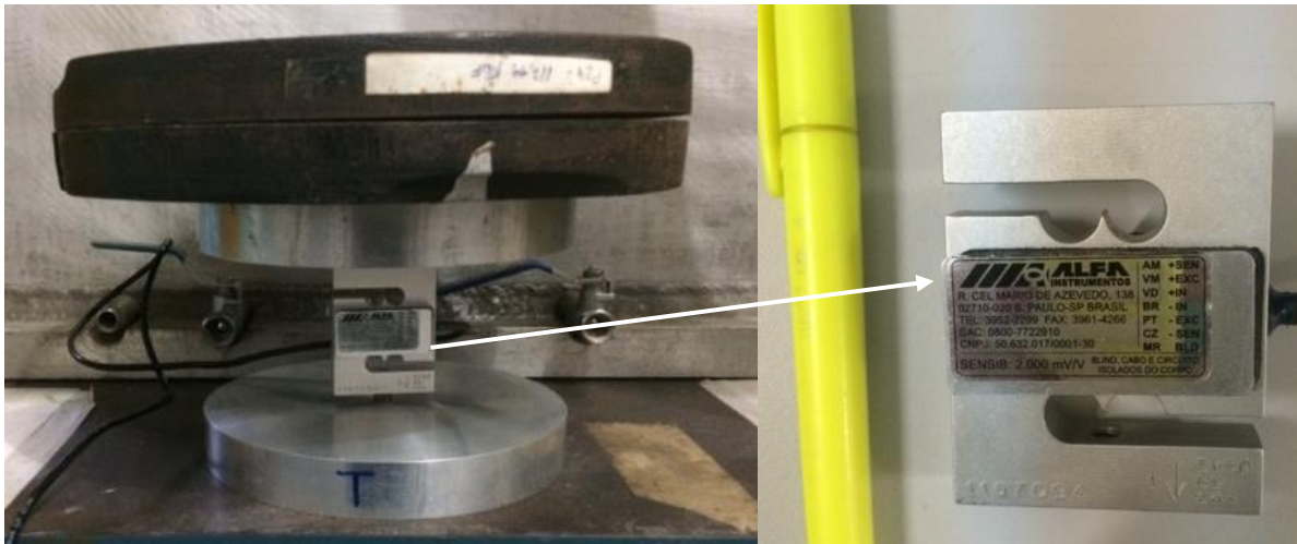
Figura 3.25 – Montagem da calibração da célula de carga.
