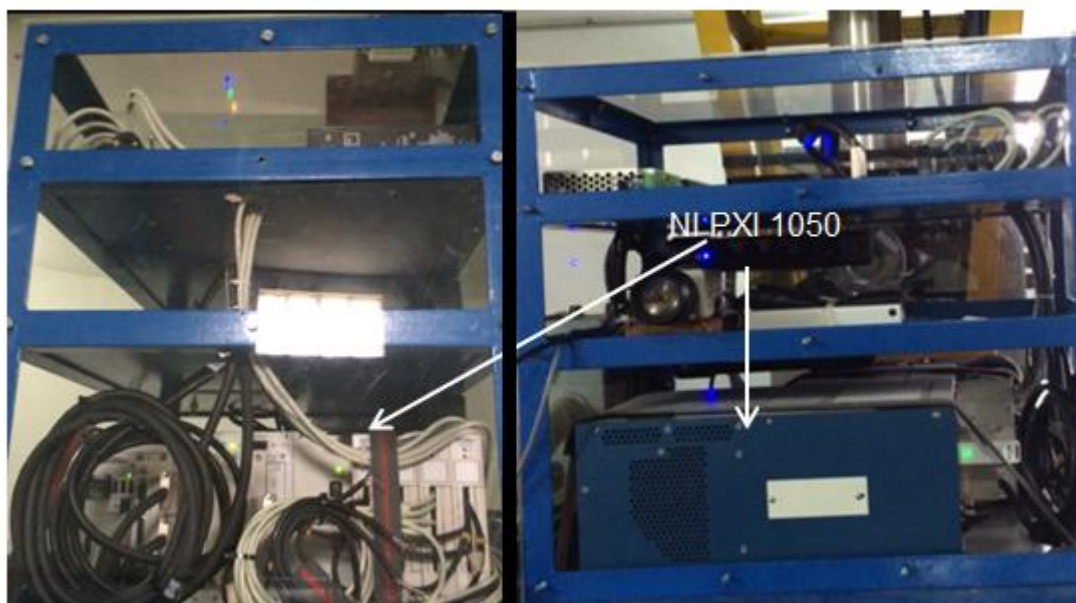
Figura 3.22 – Sistema de aquisição de dados – centrífuga.
