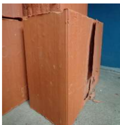
Figura 2-5: Blocos eliminados por defeitos.
