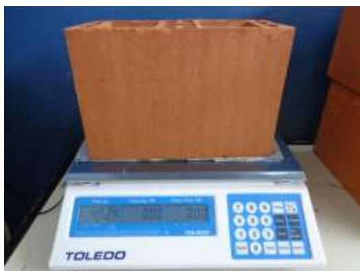
Figura 2-16: Massa de bloco seco estimada em balança eletrônica digital.
