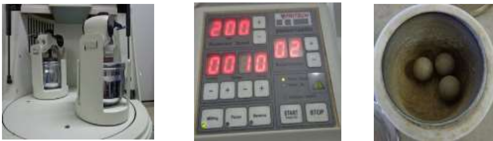
Figura 3-8: Moinho de esferas, painel e argila mais esferas.
