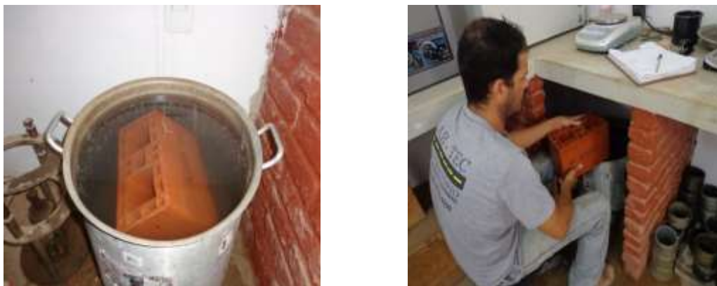
Figura 3-29: Avaliação da massa aparente do bloco.
