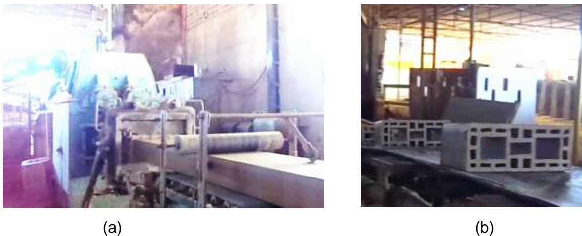
Figura 2-2: (a) Coluna saindo da extrusora; (b) Formato do bloco (14x19x29 cm) depois do corte por fios.
