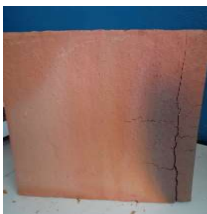
Figura 2-5: Blocos eliminados por defeitos.
