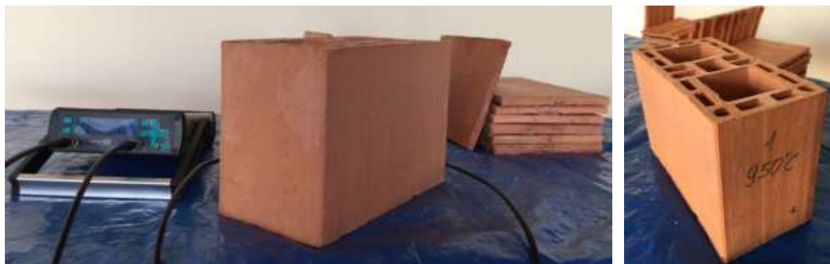
Figura 3-26: PUNDIT LAB + , bloco e septos extraídos de blocos cerâmicos estruturais.
