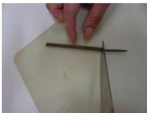
Figura 3-6: Cilindro padrão de 3 mm para o ensaio do limite de plasticidade.
