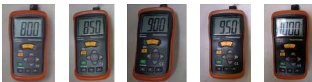
Figura 3-12: Temperaturas de queima dos blocos cerâmicos estruturais.
