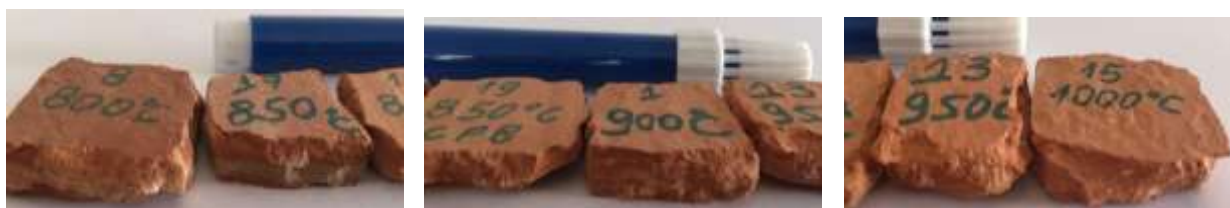
Figura 4-4: Fragmentos de septos externos dos blocos
