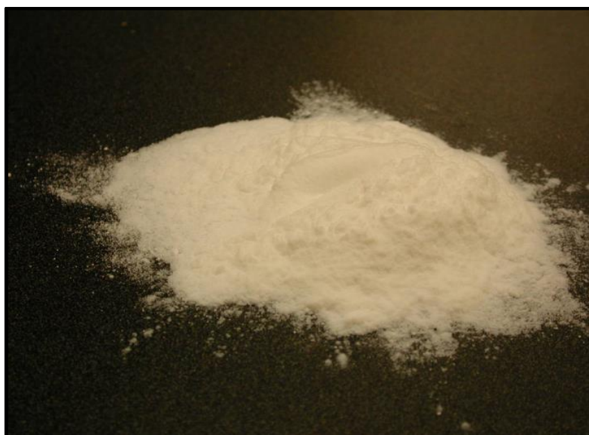
Figura 2.1 - Pó de sílica amorfa (sílica micronizada).
