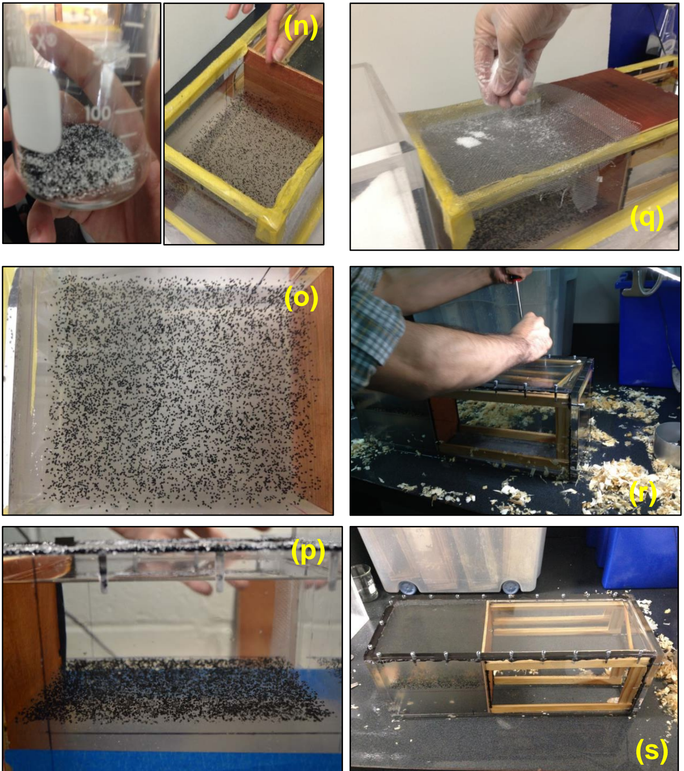
Figura 7.7 - Imagens sequências das etapas de preparação da amostra de solo transparente com a técnica da camada opaca (continuação parte 3).
