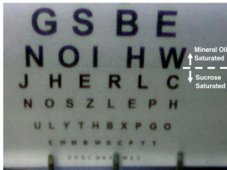
Figura 2.10 - Transparência obtida com o solo transparente com low color sucrose vista ao fundo com um alvo oftalmológico. (Fonte: Guzman et al. 2014).
