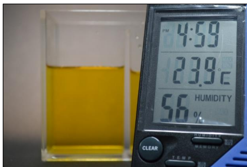
Figura 4.3- Mudança de coloração devido a processo oxidativo.
