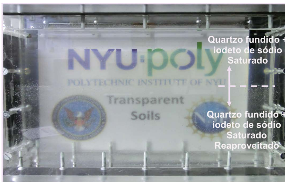
Figura 4.27 – Antigo logotipo da escola politécnica da universidade de NY visto a 5cm através de solo transparente produzido com poro fluido de iodeto de sódio reaproveitado.
