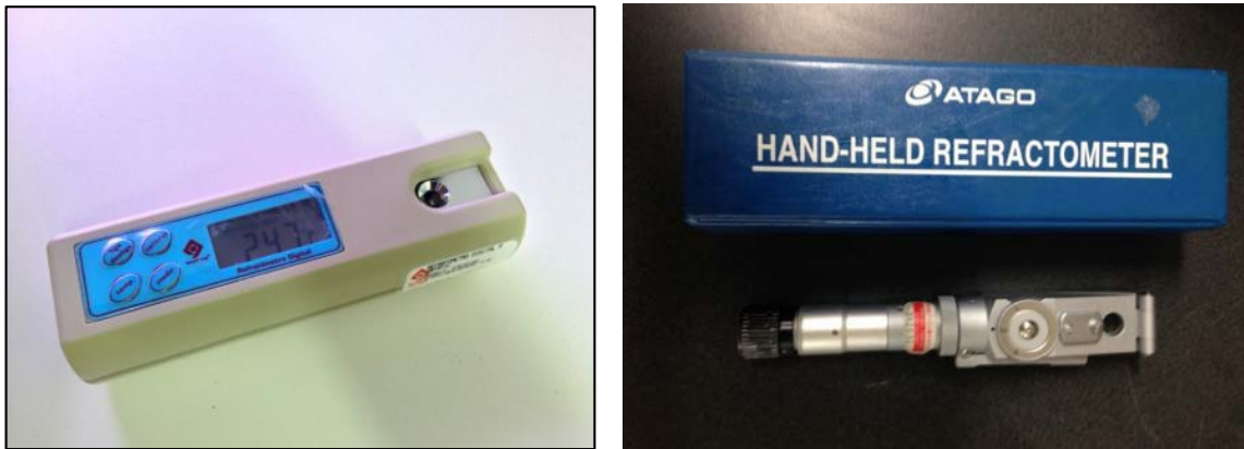
Figura 3.2 - Refratômetros portáteis do laboratório de solos transparentes do LECIV (esquerda) e da NYU (direita).
