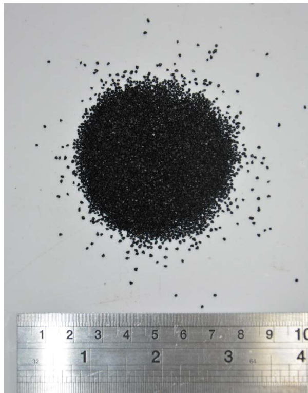
Figura 3.37 – Quartzo fundido tingido com uma tinta não metálica utilizado para ser incorporado no plano opaco da amostra de solo transparente.
