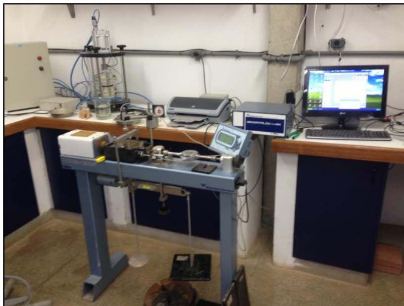
Figura 3.4 - Equipamento de cisalhamento direto do laboratório de solos LECIV/UENF.
