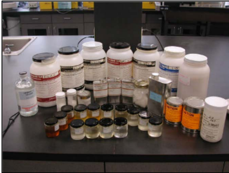
Figura 2.3 - No fundo: óleos minerais utilizados na pesquisa; Na frente: tentativas de produção de solo transparente (algumas amostras se tornaram amareladas com o tempo). (cortesia: Samer Sadek).
