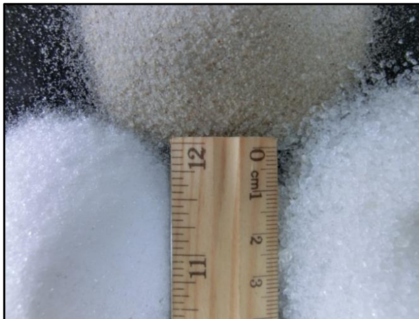
Figura 2.6 – Comparação entre o quartzo fundido grosso (direita), quartzo fundido fino (esquerda) e uma areia padronizada de ottawa (acima).
