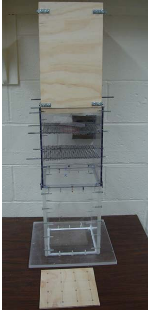
Figura 7.3 – Pluviador para preparação de amostras de solo transparente.
