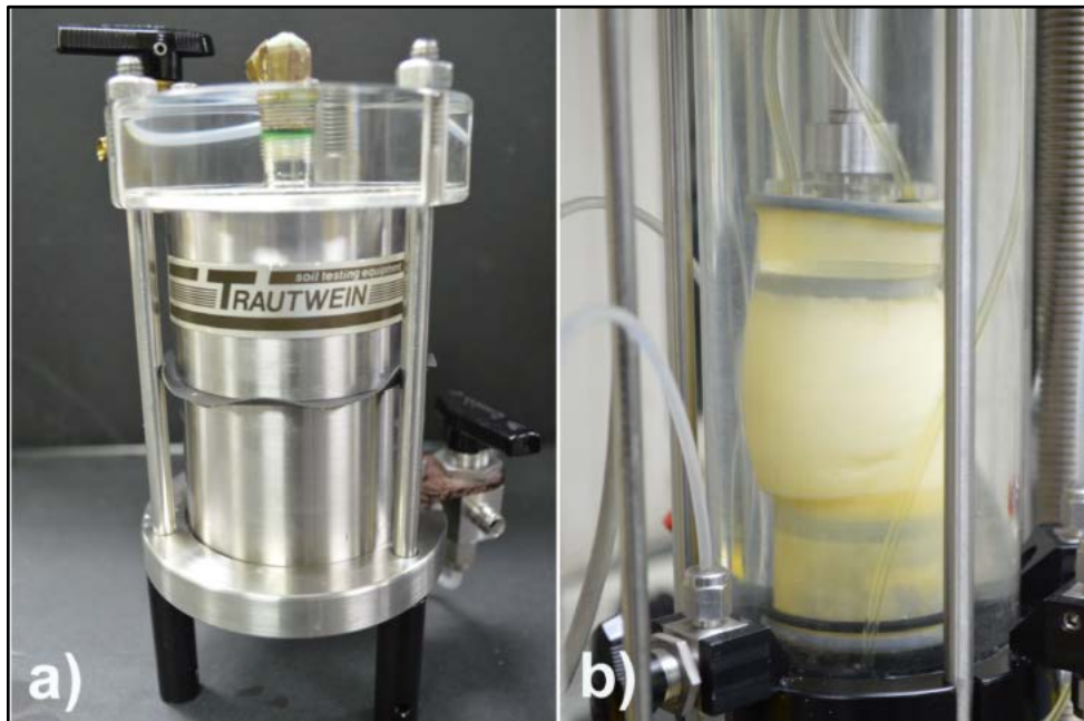
Figura 3.9 – a) Interface tóxica utilizada para saturar o corpo de prova com o poro fluido a ser testado; b) ruptura do corpo de prova ensaiado.
