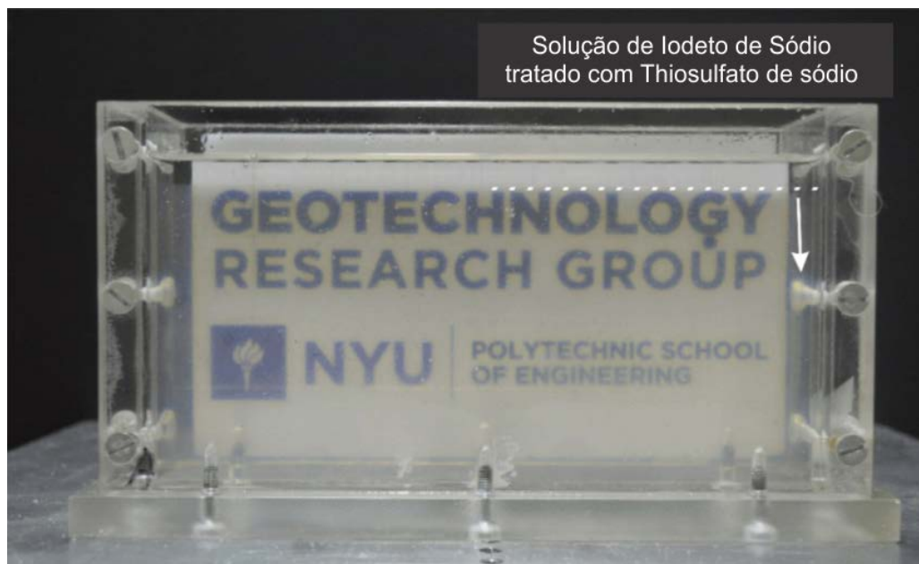
Figura 4.5 - Logotipo do grupo de geotecnologia da NYU visto a 50 mm de espessura em um container com solo transparente composto de quartzo fundido e solução de água com iodeto de sódio tratado com thiosulfato de sódio.
