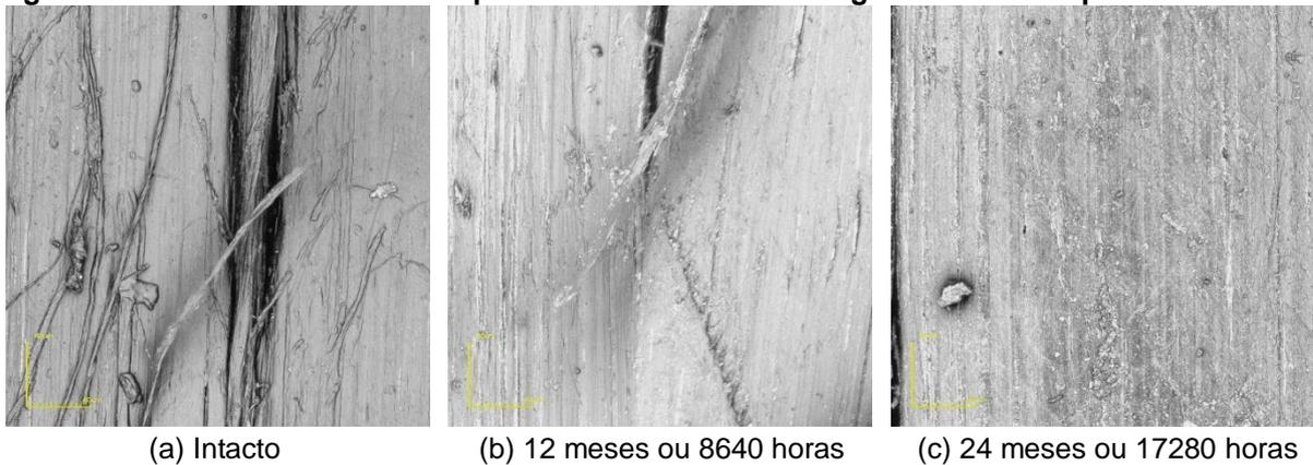
**Figura 66. Detalhes das Microscopias do PET340 Degradado no Laboratório**
