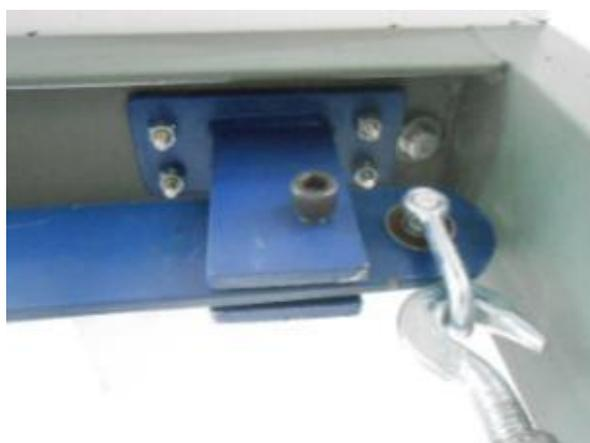
(c) detalhe do apoio da alavanca de tração
