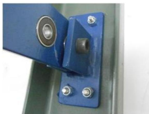
(d) detalhe do apoio da alavanca de punção
