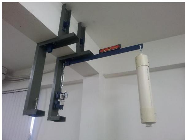
(b) detalhe do peso fixado ao sistema de fluência
