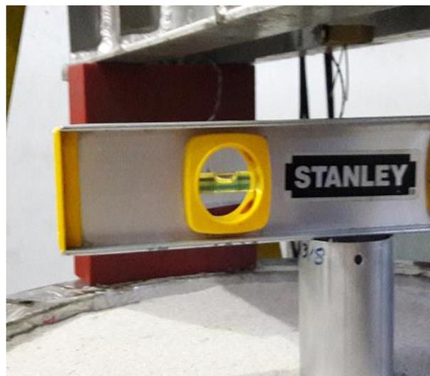
Figura 3.60. Verificação da verticalidade da estaca após o arrancamento.
