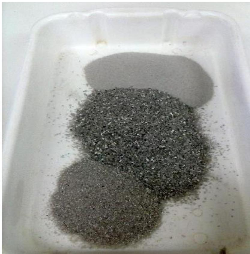
Figura 3.6. Bandeja com areias prontas para serem misturadas para o ensaio de peso específico mínimo e máximo.
