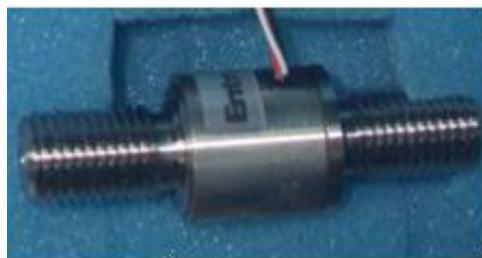
Figura 3.45. Célula de Carga.
