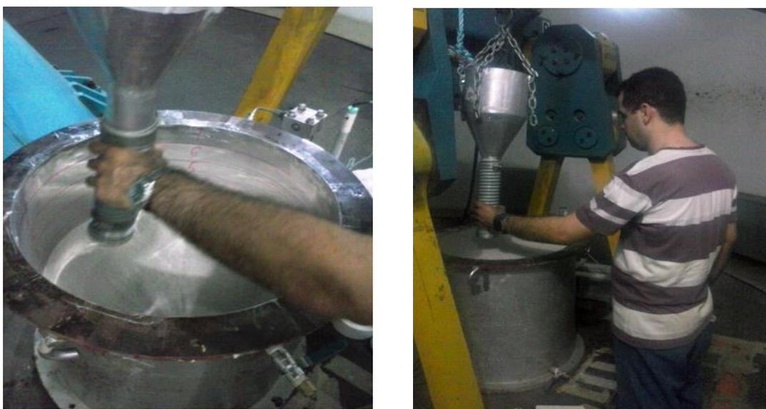
Figura 3.48. Pluviação do container.
