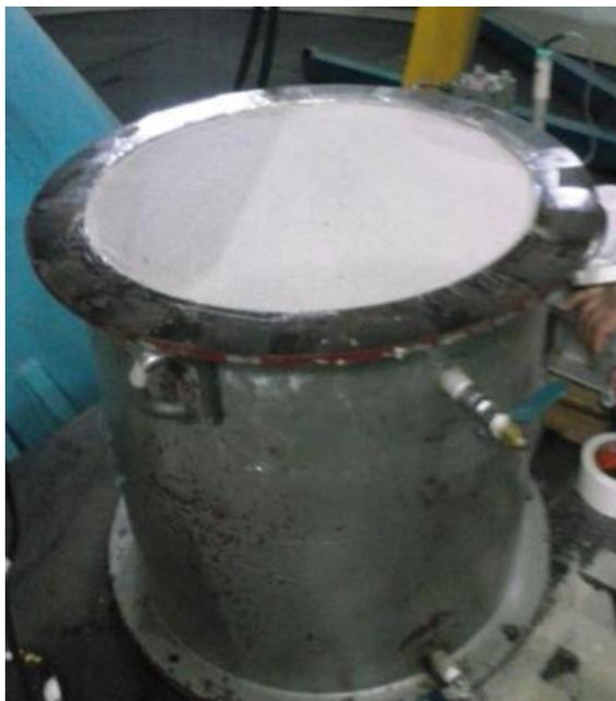
Figura 3.49. Container logo após de ser pluviado
