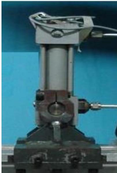
Figura 3.44. Atuador Hidráulico
