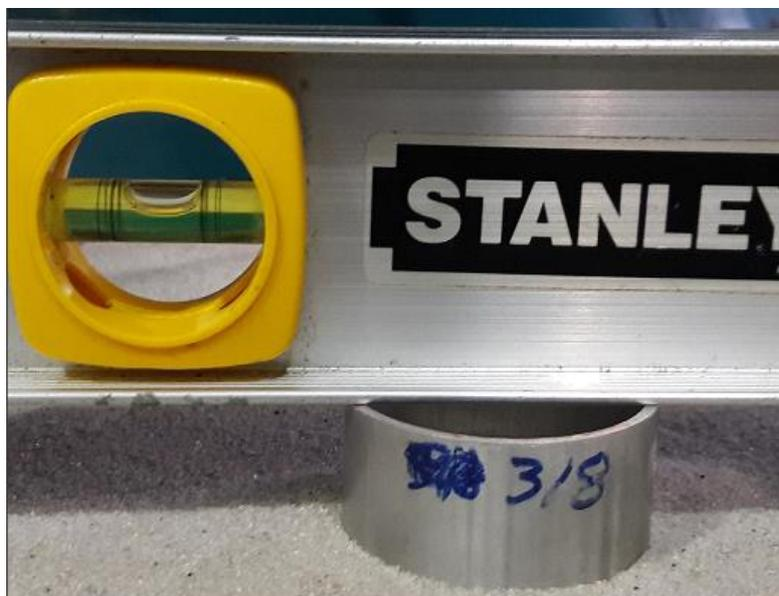
Figura 3.54. Verificação do nivelamento da estaca após o término da cravação.
