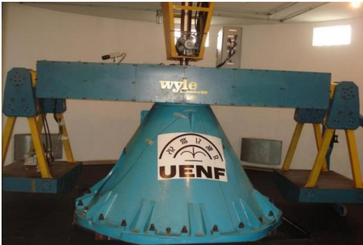
Figura 3.40. Centrífuga geotécnica da UENF.
