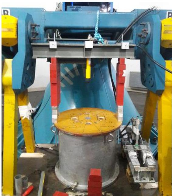
Figura 3.50. Montagem do sistema de cravação da estaca.
