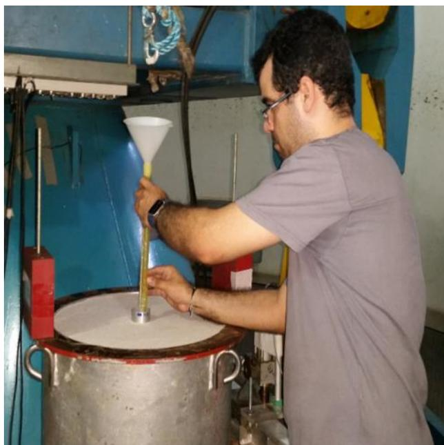
Figura 3.57. Pluviação no interior da estaca.
