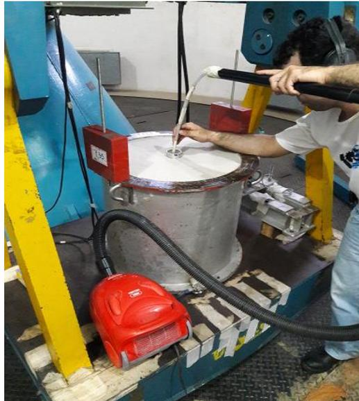
Figura 3.55. Areia sendo retirada de dentro da estaca com o aspirador de pó após a cravação.
