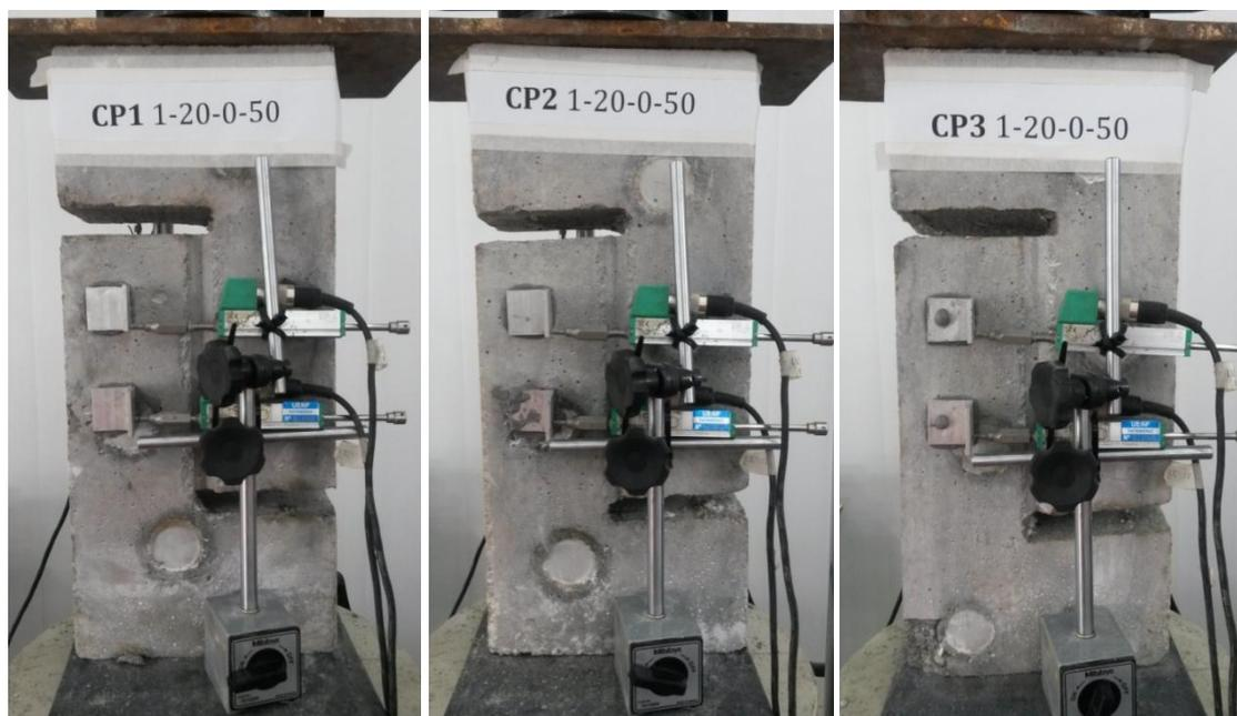
Figura A.7.4: Corpos de prova CPx 1-20-0-50 no momento do ensaio *push-off*.
