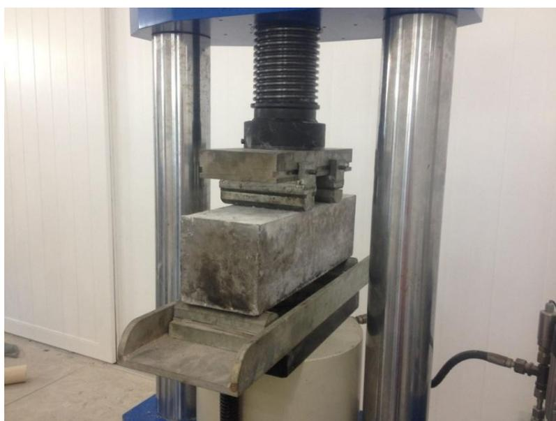
Figura 3.16: Ensaio de tração na flexão.
