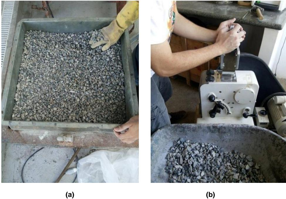
Figura 3.4: (a) Peneiramento, (b) rebitagem do material.
