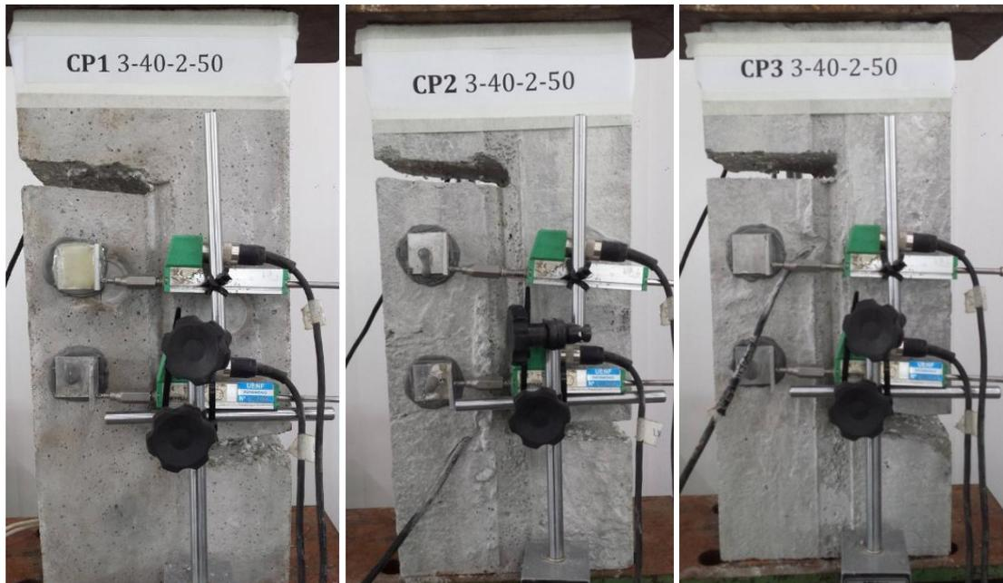
Figura A.7.19: Corpos de prova CPx 3-40-2-50 no momento do ensaio *push-off*.
