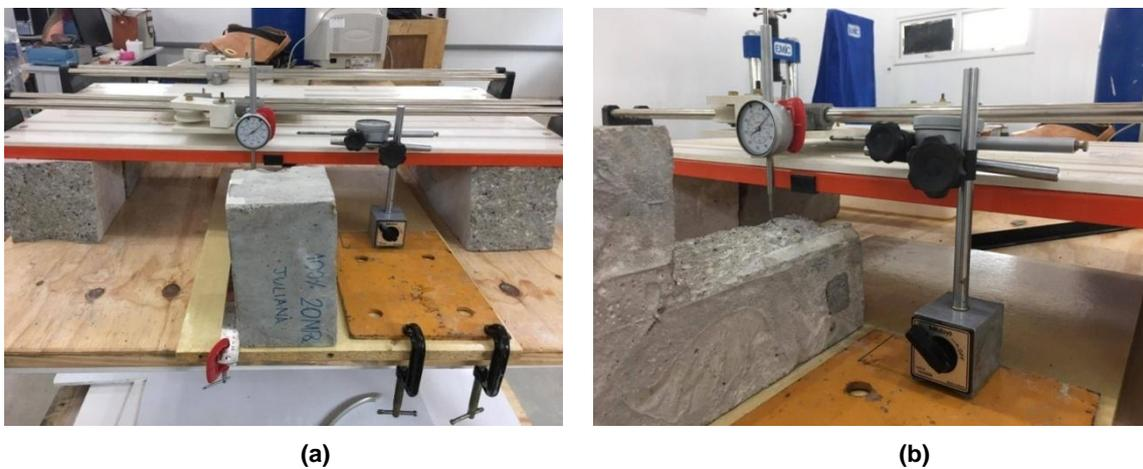
Figura 3.20: *Setup* de medição das coordenadas: (a) vista frontal; (b) vista lateral.
