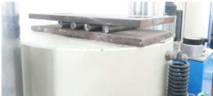
Figura 3.17: Conjunto de placas e rolos utilizados no ensaio *push-off*.
