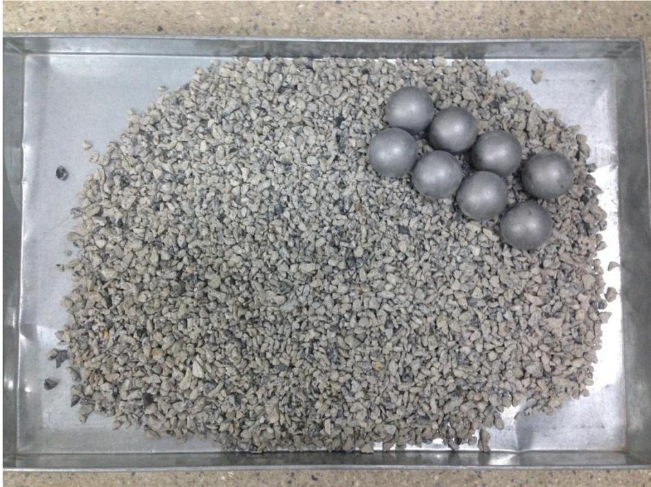
Figura 3.6: Amostra e esferas utilizadas no ensaio de Abrasão Los Angeles.
