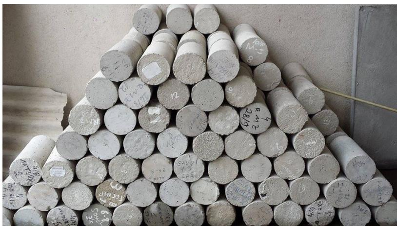
Figura 3.1: Armazenamento do material a ser reciclado.
