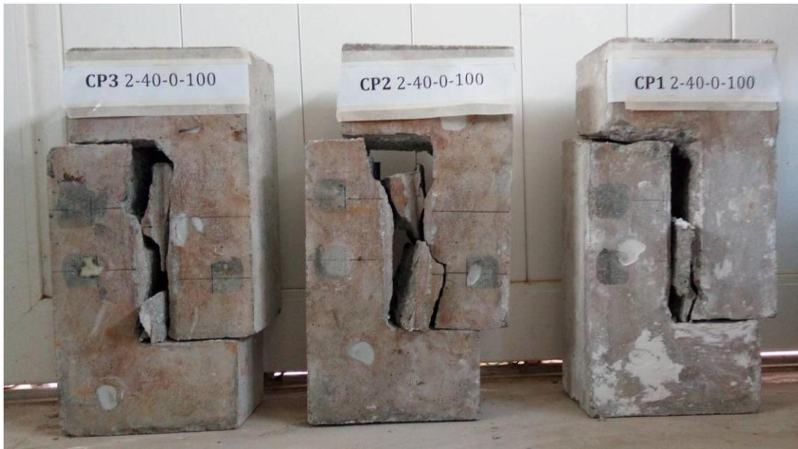
Figura A.7.17: Corpos de prova CPx 2-40-0-100 após o ensaio *push-off*.
