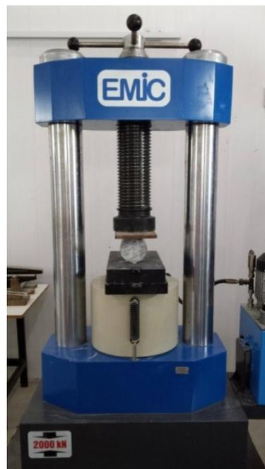
Figura 3.15: Ensaio de tração indireta.
