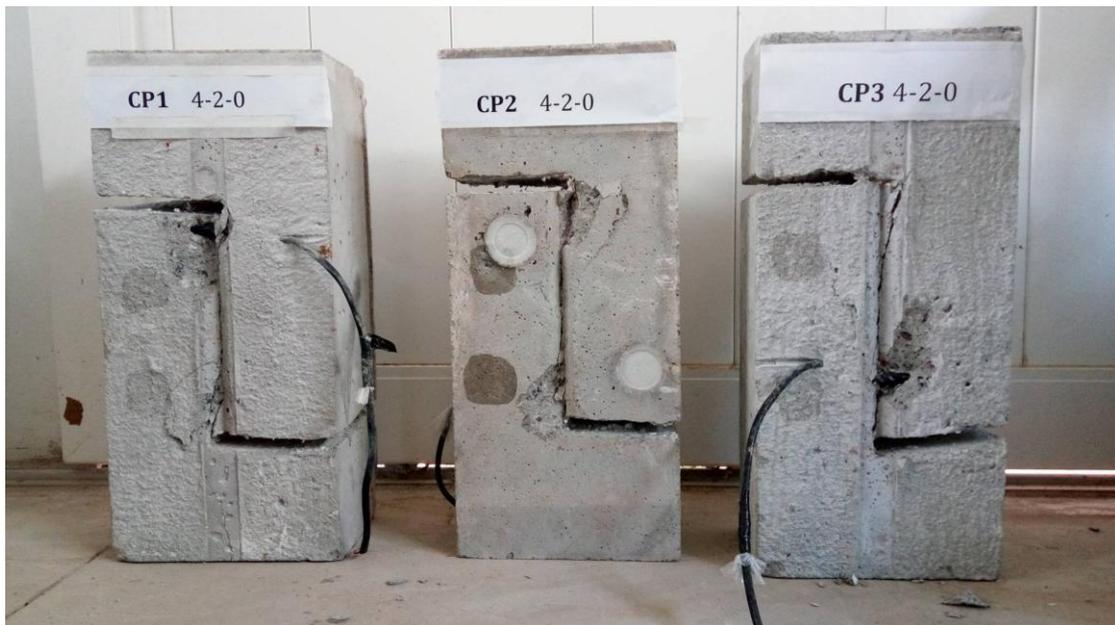
Figura 4.15: Corpos de prova CPx 4-2-0 após o ensaio *push-off*.
