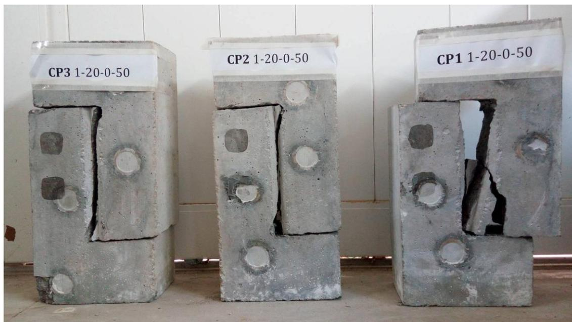
Figura A.7.5: Corpos de prova CPx 1-20-0-50 após o ensaio *push-off*.
