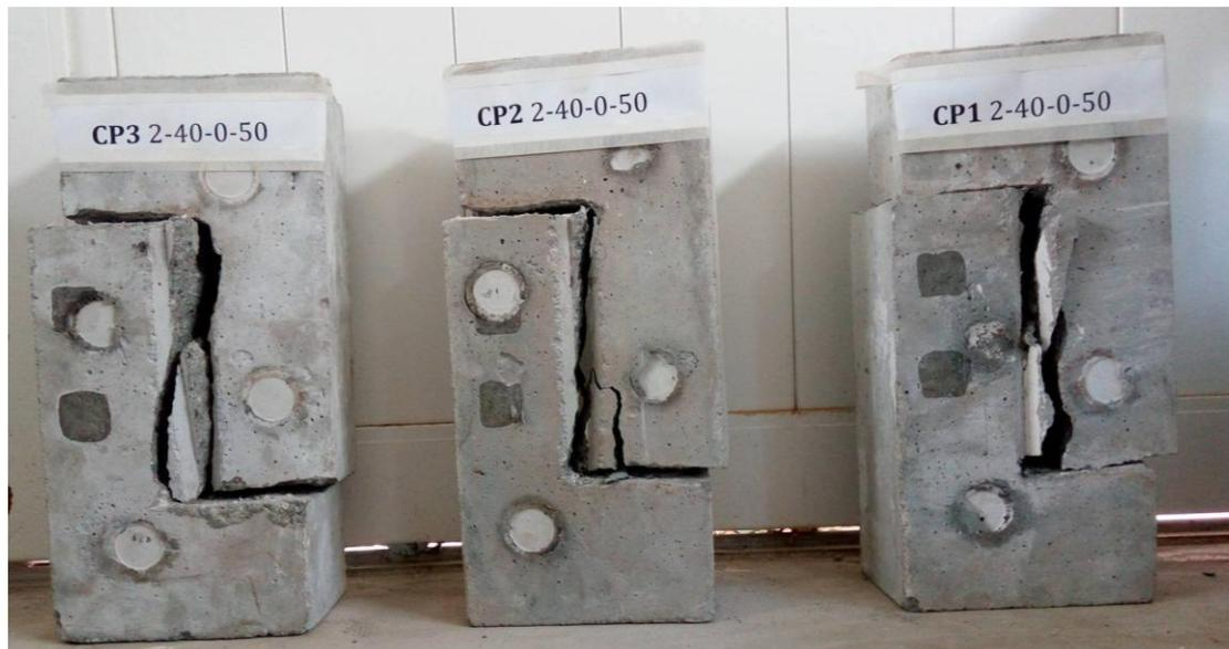
Figura A.7.14: Corpos de prova CPx 2-40-0-50 após o ensaio *push-off*.
