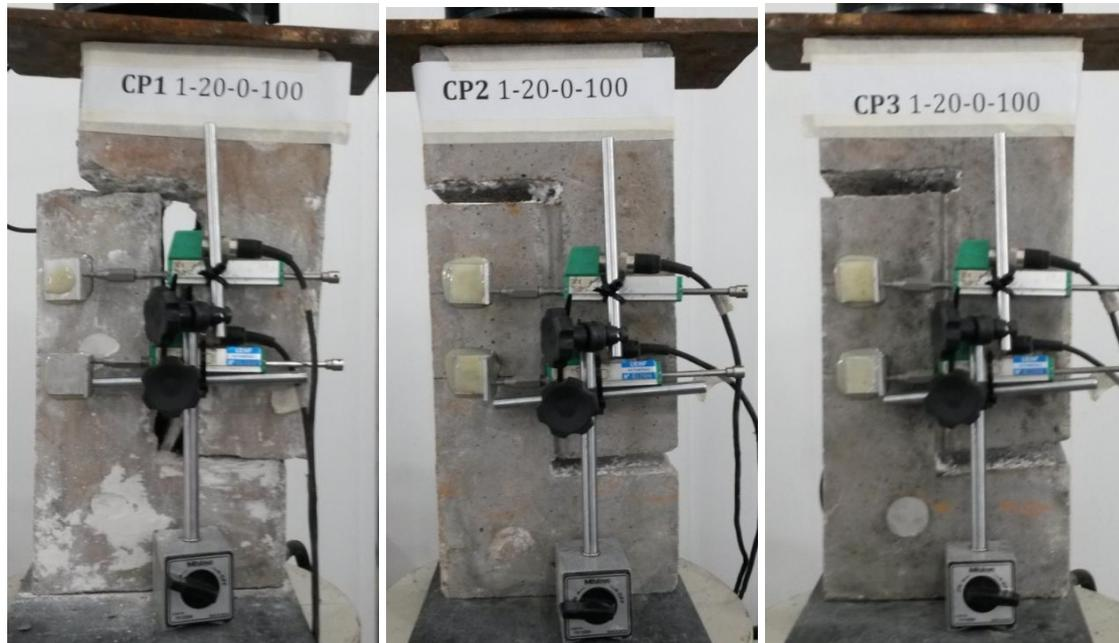
Figura A.7.7: Corpos de prova CPx 1-20-0-100 no momento do ensaio *push-off*.
