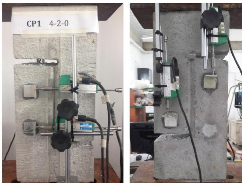
Figura 3.19: Vista frontal e posterior do CP1 4-2-0 no momento do ensaio.
