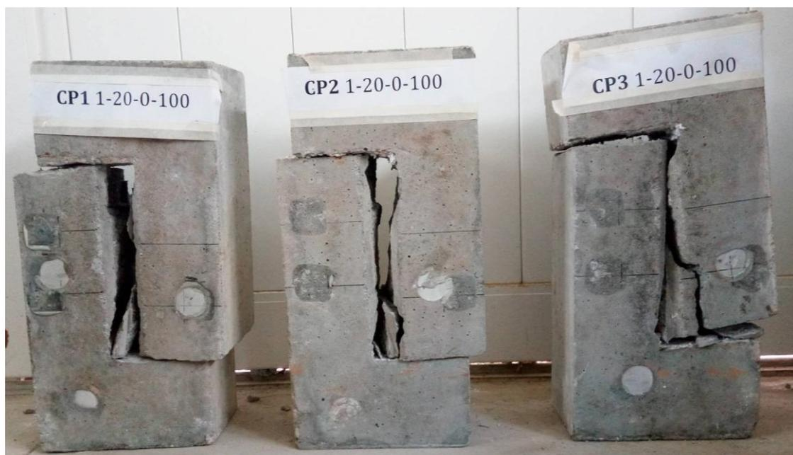
Figura A.7.8: Corpos de prova CPx 1-20-0-100 após o ensaio *push-off*.
