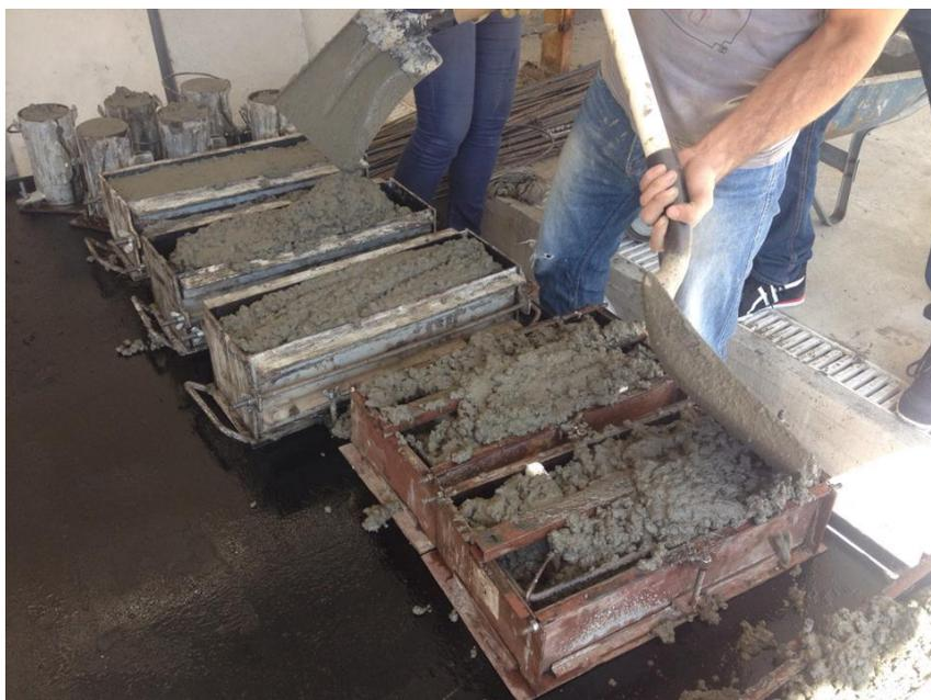
**Figura 3.12: Moldagem dos corpos de prova na mesa vibratória.**
