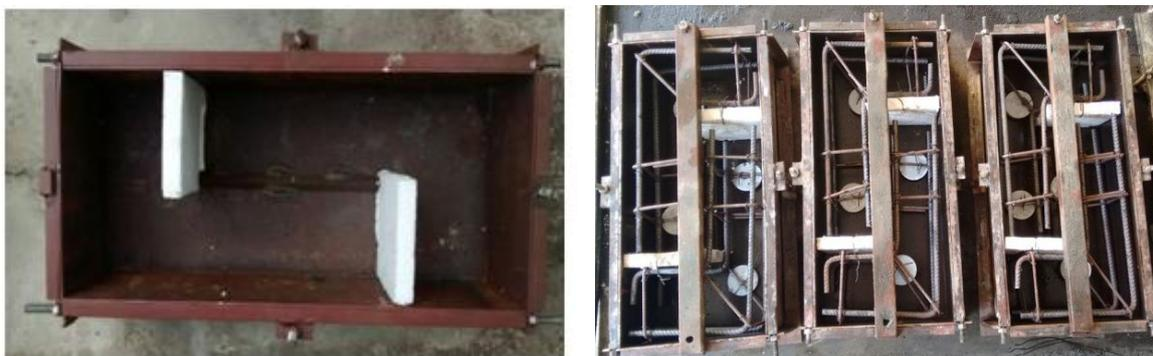
**Figura 3.11: Fôrma e armadura para a produção dos corpos de prova *push-off*.**
