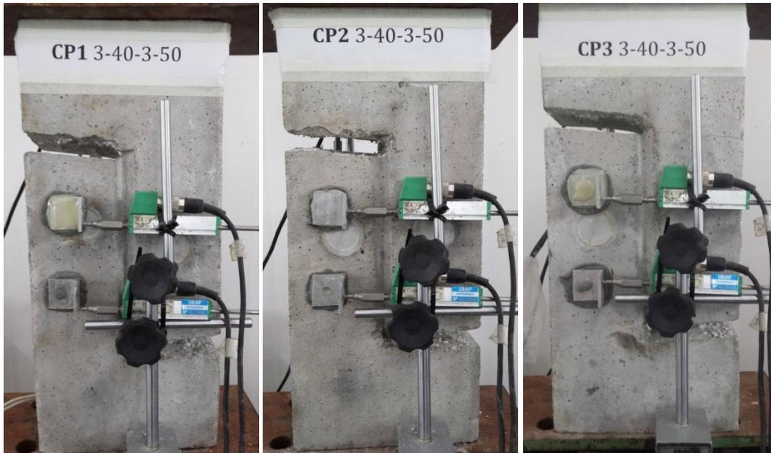
Figura A.7.22: Corpos de prova CPx 3-40-3-50 no momento do ensaio *push-off*.
