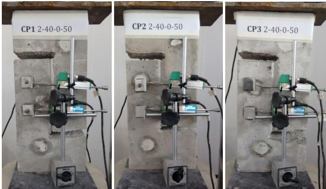
Figura A.7.13: Corpos de prova CPx 2-40-0-50 no momento do ensaio *push-off*.
