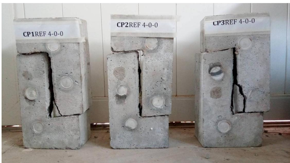
Figura 4.12: Corpos de prova CPx 4-0-0 após o ensaio *push-off*.
