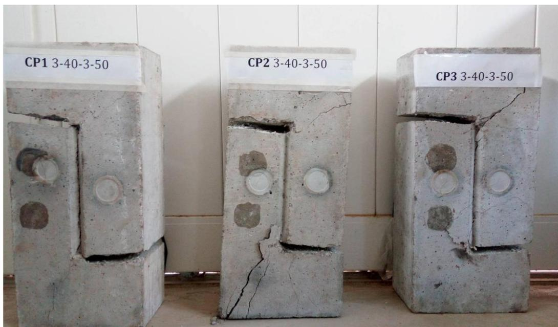
Figura A.7.23: Corpos de prova CPx 3-40-3-50 após o ensaio *push-off*.
