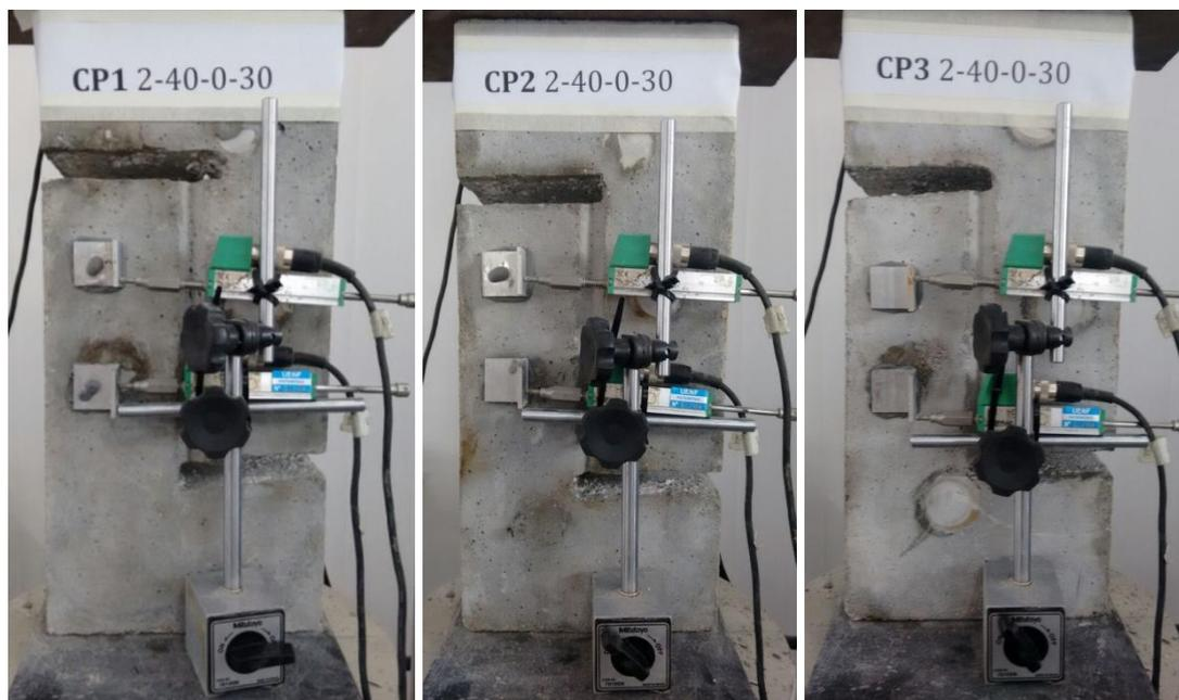
Figura A.7.10: Corpos de prova CPx 2-40-0-30 no momento do ensaio *push-off*.
