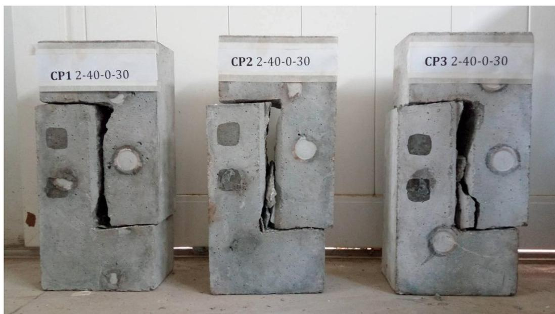
Figura A.7.11: Corpos de prova CPx 2-40-0-30 após o ensaio *push-off*.
