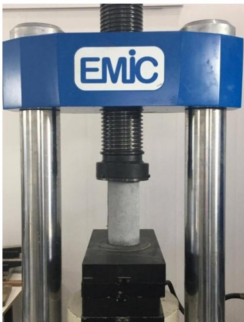
Figura 3.14: Ensaio de compressão.
