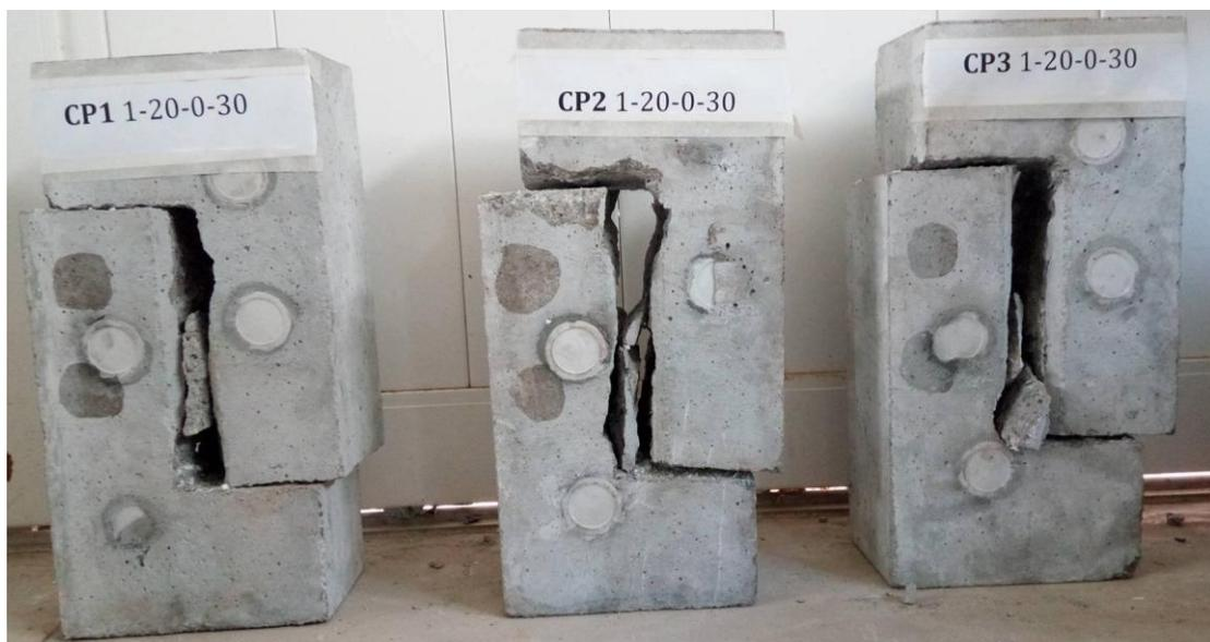
Figura A.7.2: Corpos de prova CPx 1-20-0-30 após o ensaio *push-off*.
