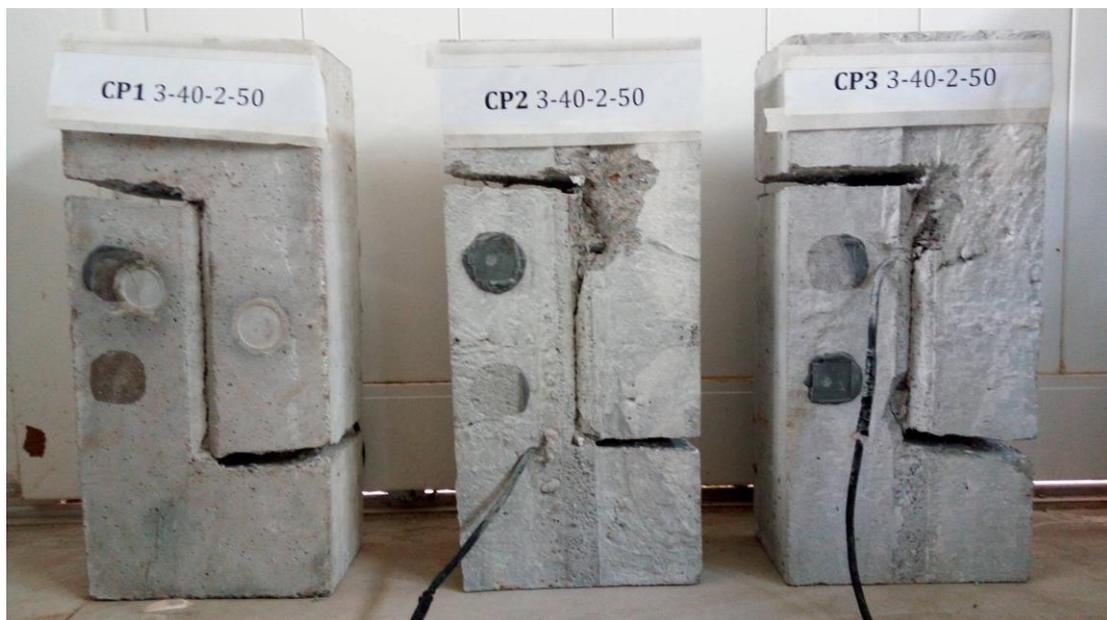
Figura A.7.20: Corpos de prova CPx 3-40-2-50 após o ensaio *push-off*.
