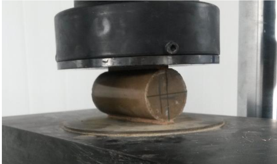
Figura 4.16 - Ensaio de resistência à tração indireta da resina geopolimérica.
