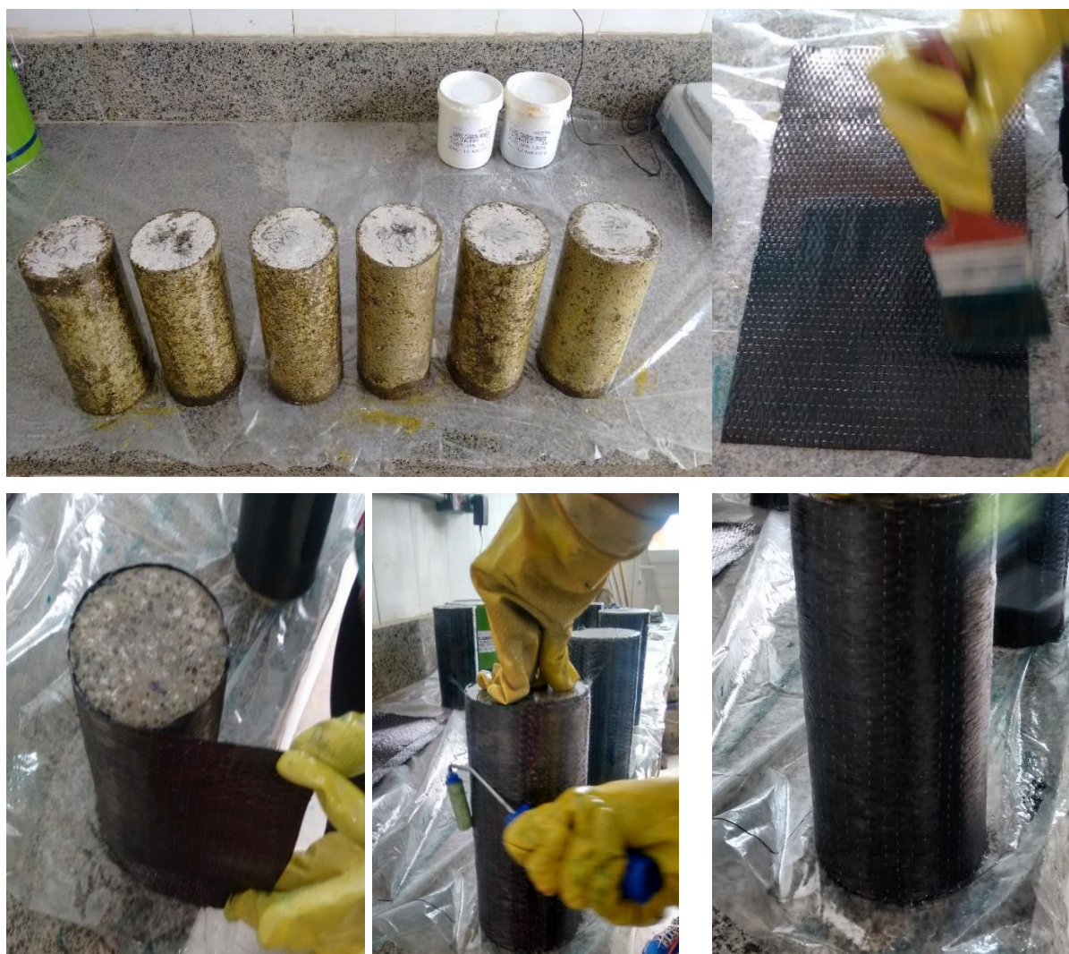
Figura 4.12 - Realização do sistema com uma camada de reforço com compósito de fibra de carbono e resina epóxi.
