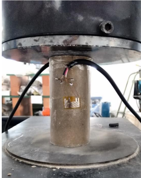
Figura 4.9 - Instrumentação do corpo de prova de resina geopolimérica ensaiada aos 28 dias.
