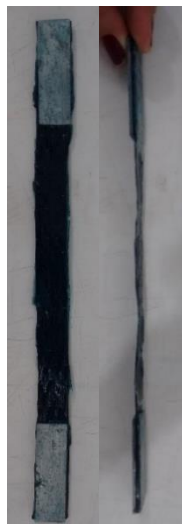
Figura 4.19 - Corpo de prova do compósito de resina epóxi e uma camada de fibra de carbono para o ensaio de tração direta.
