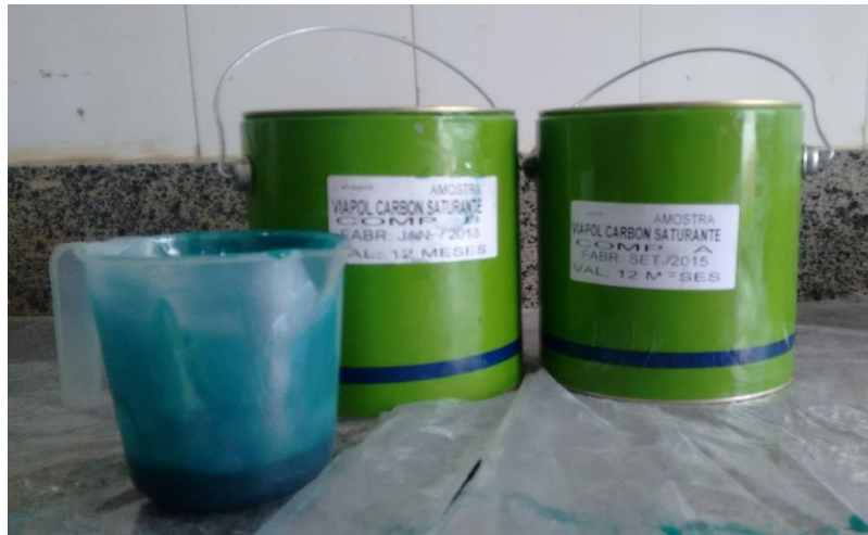
Figura 4.3 - Viapol Carbon saturante (resina de impregnação).
