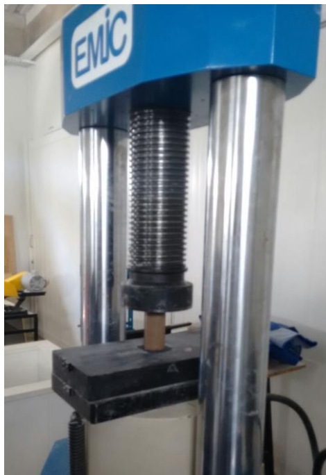
Figura 4.15 - Ensaio de resistência à compressão axial da resina geopolimérica.
