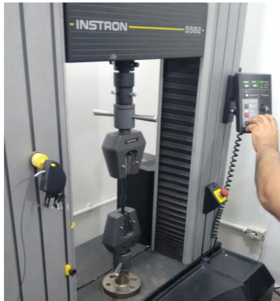
Figura 4.21 - Ensaio de resistência à tração direta do compósito.
