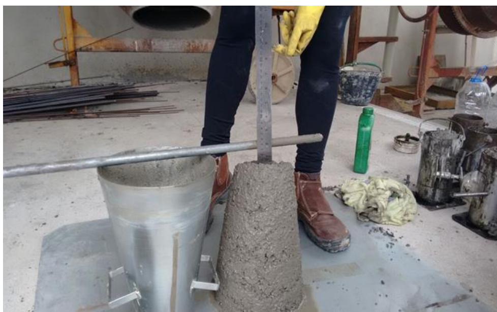
Figura 4.5 - Ensaio do abatimento do tronco do cone.
