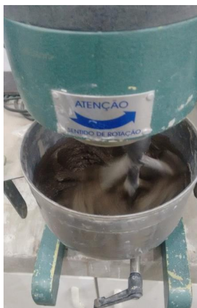
Figura 4.7 - Mistura da resina geopolimérica em argamassadeira.
