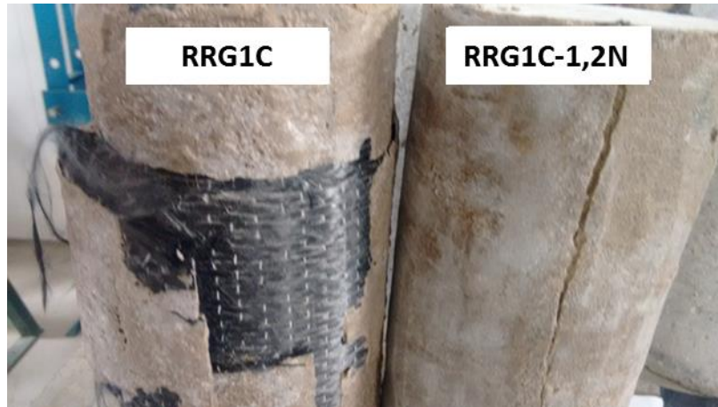
Figura 5.22 – Aspecto pós ruptura do RRG1C e RRG1C-1.2A.
