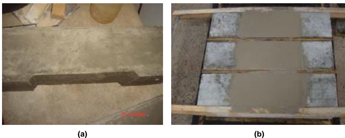
Figura 2.10- (a) Detalhe do entalhe da viga; (b) Reparo/Reforço da viga com geopolímero (MAZZA, 2010).
