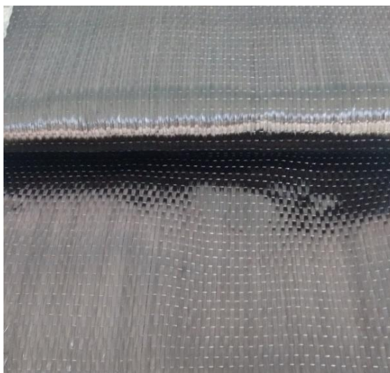
Figura 4.1 - Manta de fibra de carbono da Viapol, Carbon CFW 300.
