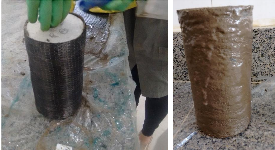
Figura 4.14 - Realização do sistema com uma camada de reforço com compósito de fibra de carbono e resina geopolimérica (continuação).
