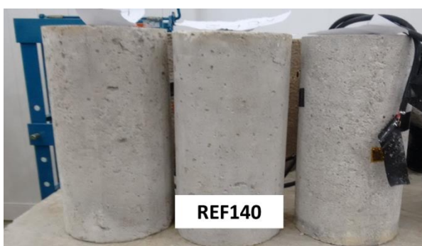
Figura 5.16 – Aspecto pós ruptura do concreto de referência.
