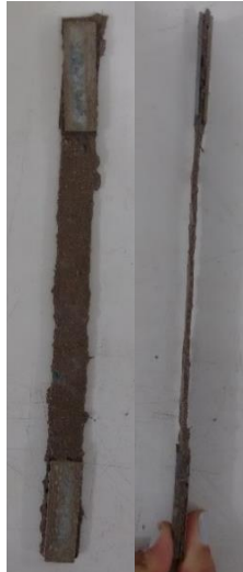
Figura 4.20 - Corpo de prova do compósito de resina geopolimérica e uma camada de fibra de carbono para o ensaio de tração direta.
