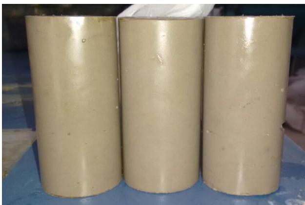
Figura 4.8 - Corpos de prova da resina geopolimérica.
