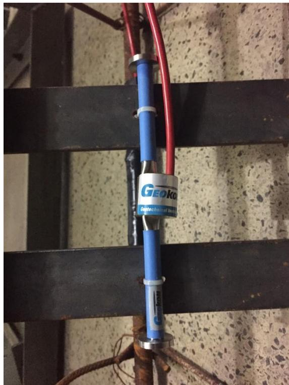
Figura 25: Extensômetro do concreto.
