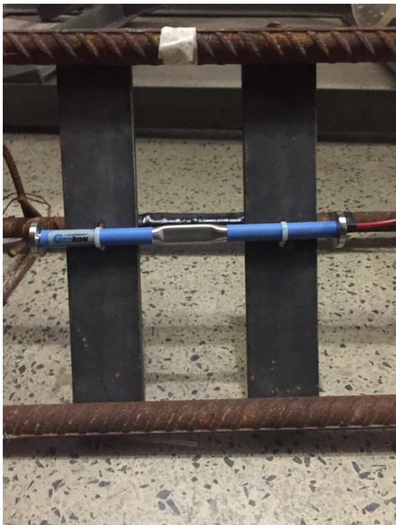
Figura 24: Modo de instalação do extensômetro do concreto.
