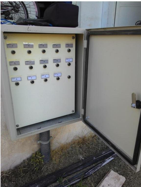
Figura 37: Quadro de medição dos extensômetros e termopares.
