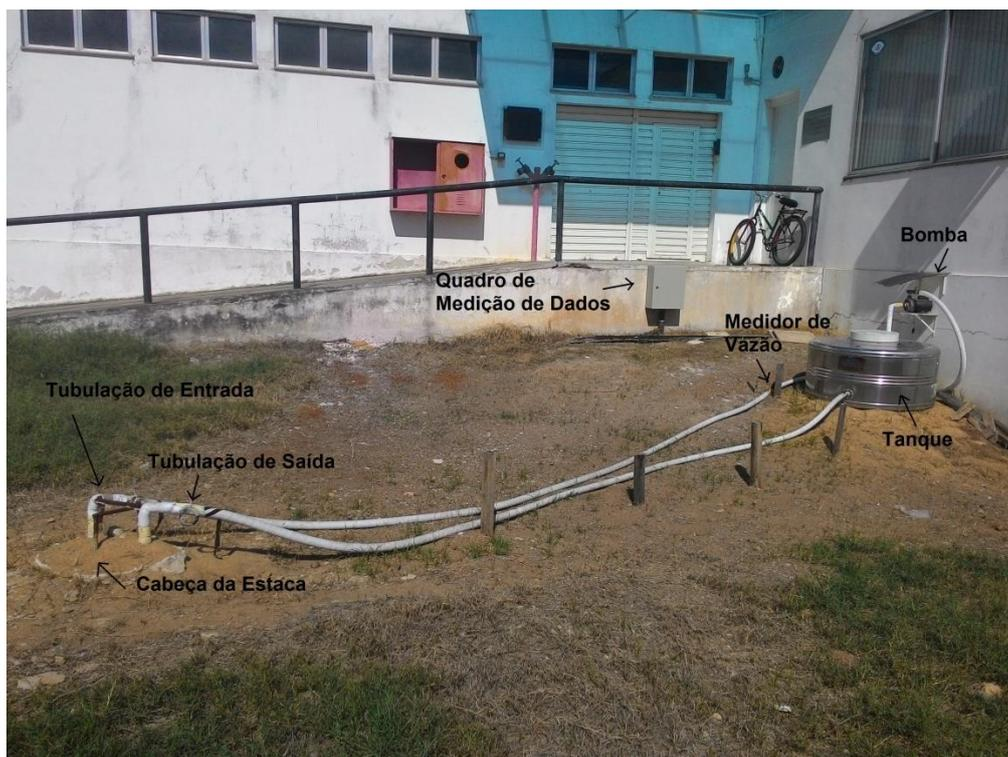
Figura 36: Equipamentos instalados para a realização do Teste de Resposta Térmica.
