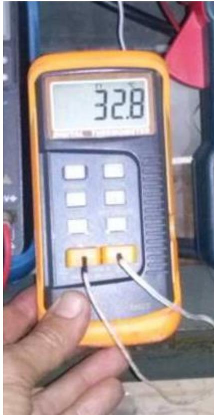
Figura 44: Leitor utilizado para mostrar as temperaturas ambiente e do fluido medidas pelo termopar.
