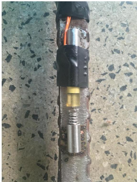
Figura 27: Aparência final do extensômetro da armadura após instalação.
