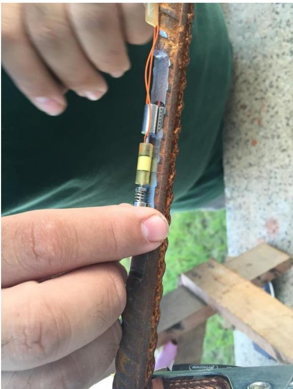
Figura 26: Instalação do extensômetro da armadura.
