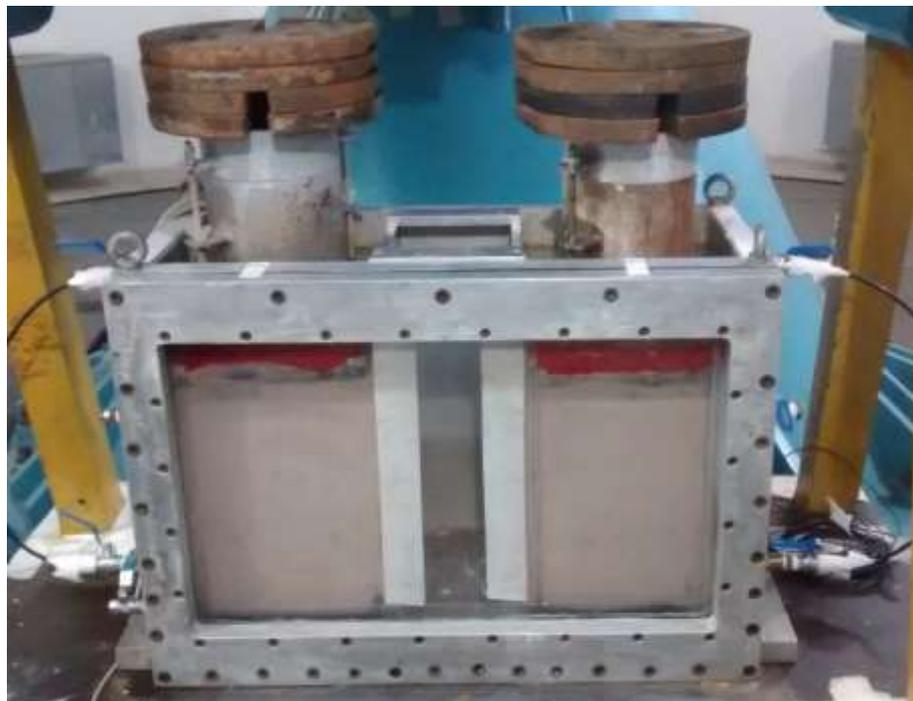
**Figura 39:** Vista da caixa de teste com a sobrecarga sobre o solo mole após uma semana
