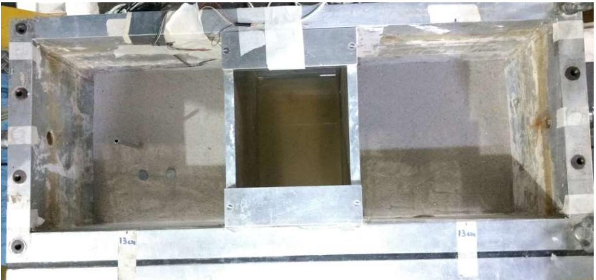
**Figura 65:** Posicionamento das sapatas de apoio das hastes metálicas dos LVDTs no topo do aterro do modelo construído com as colunas
