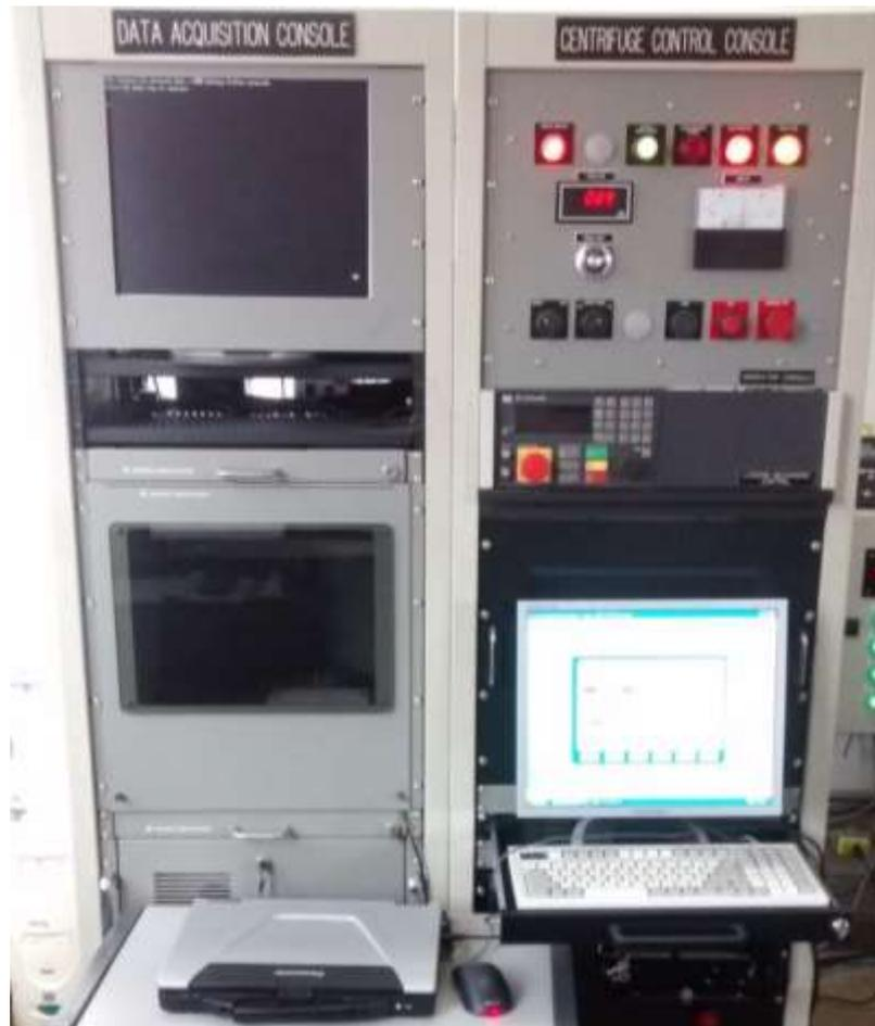
**Figura 16:** Consoles de controle e aquisição de dados da centrífuga geotécnica da UENF
