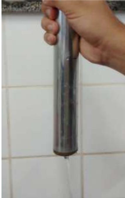
**Figura 57:** Teste de permeabilidade da ponteira porosa
