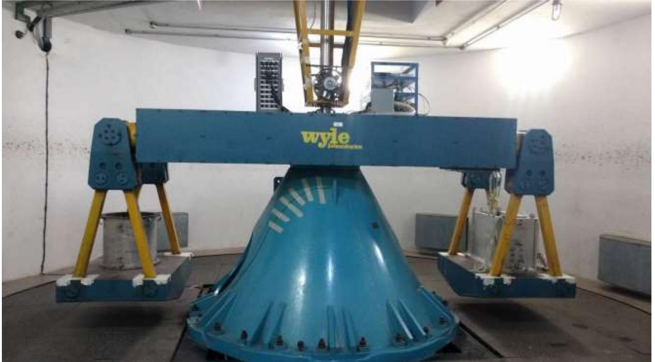
**Figura 15:** Centrífuga geotécnica de viga do Laboratório de Engenharia Civil da UENF
