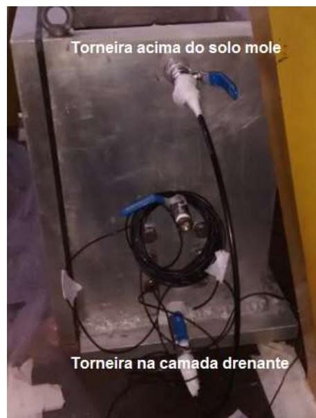
**Figura 37:** Sistema de drenagem da caixa de teste
