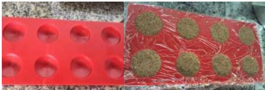
**Figura 56:** Molde utilizado para a fabricação das ponteiros drenantes
