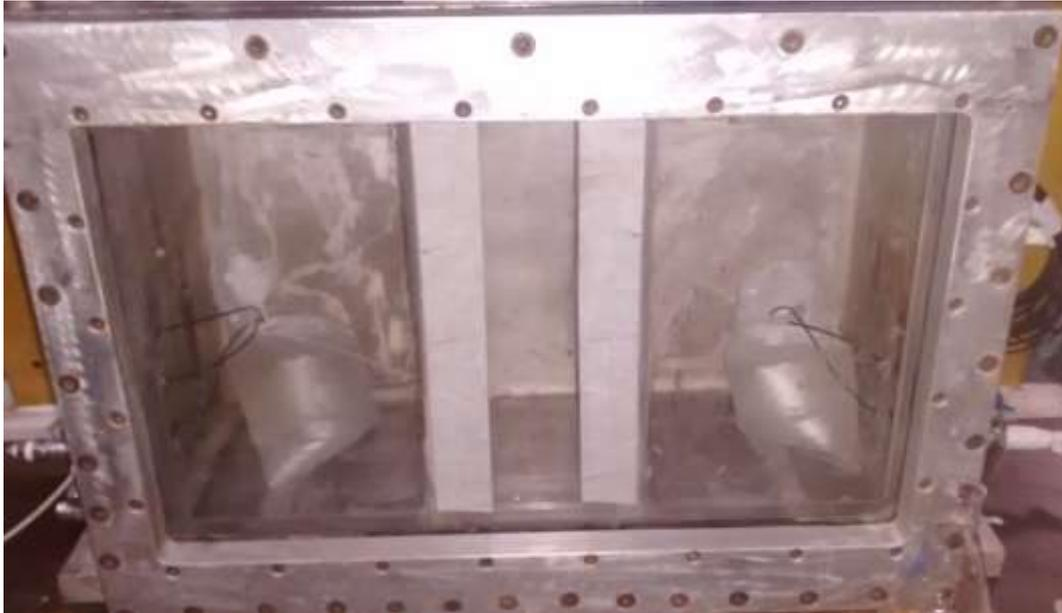
**Figura 33:** Transdutores de poropressão dentro de bolsas com água antes da montagem dos modelos
