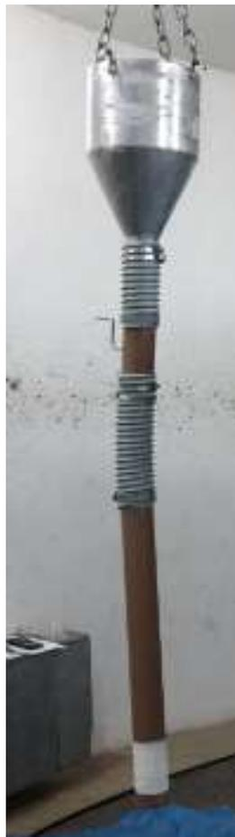
**Figura 61:** Pluviador confeccionado no Laboratório de Engenharia Civil da UENF
