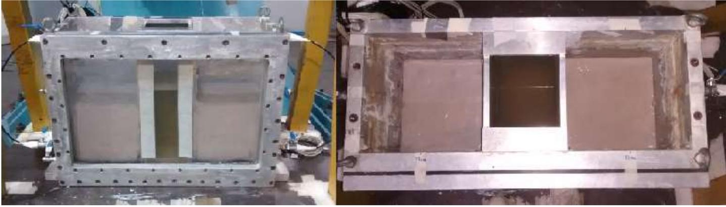
**Figura 53:** Vista da caixa de teste com o solo mole após corte da camada superficial
