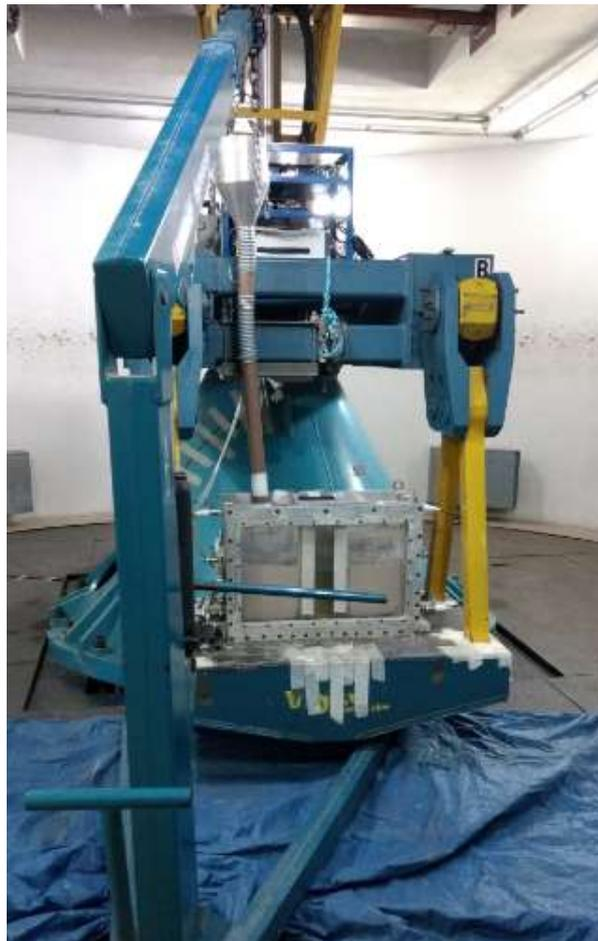
**Figura 63:** Vista do pluviador sobre a caixa de teste
