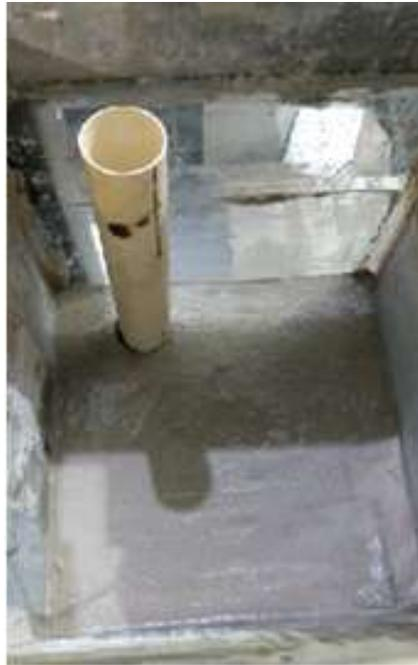
**Figura 73:** Retirada de amostra para determinação do perfil de umidade no modelo sem as colunas
