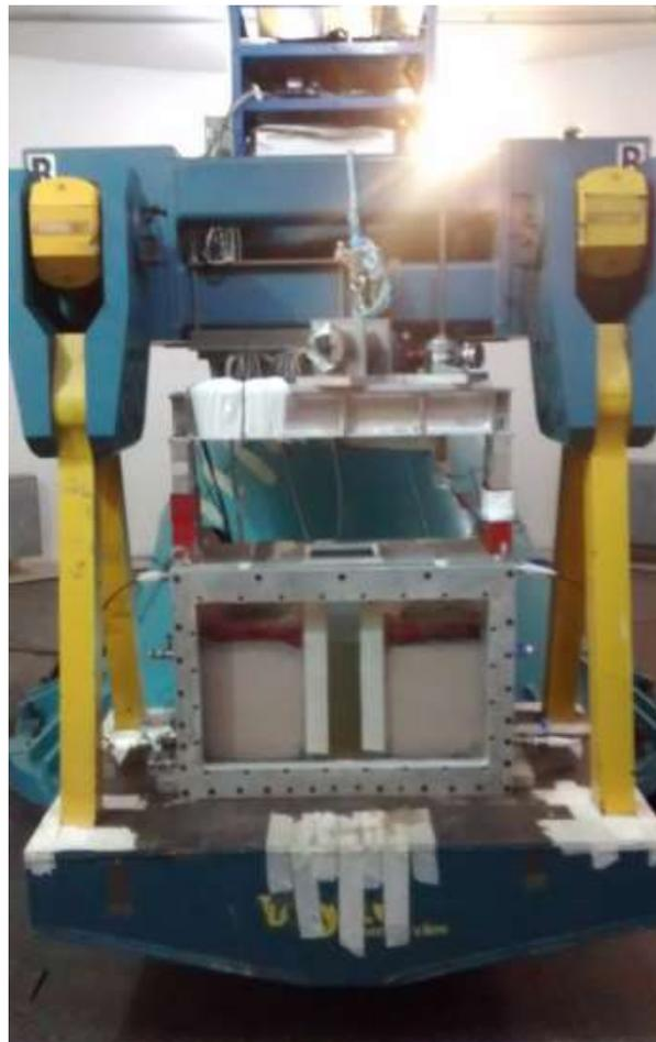
**Figura 40:** Vista do modelo com o solo mole e a sobrecarga na centrífuga geotécnica antes do início do adensamento
