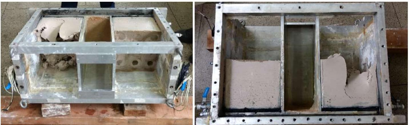
**Figura 74:** Retirada da parte frontal da caixa de teste para exumação do modelo com as colunas
