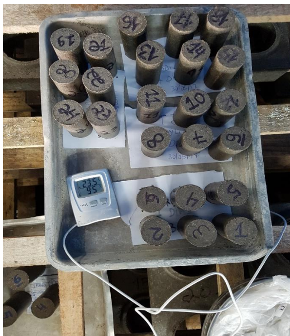
Figura 3.21 – Corpos de prova cilíndricos para ensaio de durabilidade.
