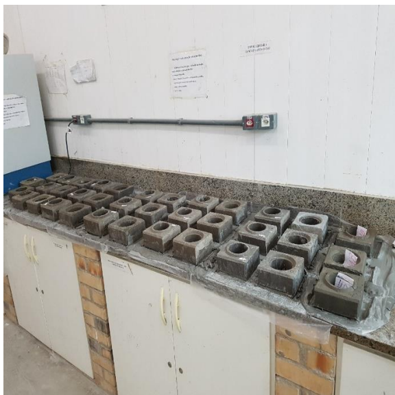
Figura 3.17 – Regularização das superfícies dos tijolos.
