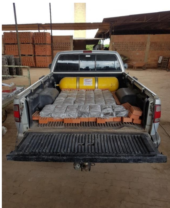
Figura 3.12 – Transporte dos tijolos imediatamente após moldagem.
