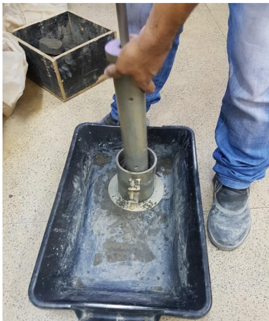
Figura 3.6 – Execução do ensaio de compactação Proctor Normal.
