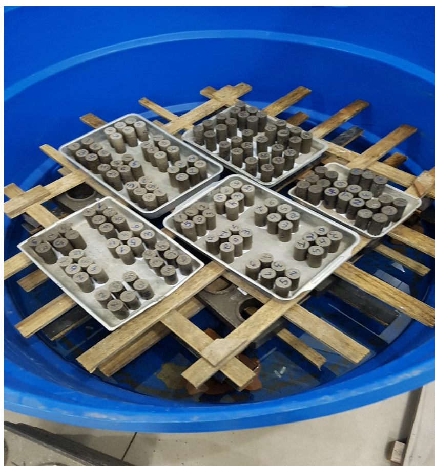
Figura 3.5 – Corpos de prova cilíndricos produzidos com diferentes umidades.
