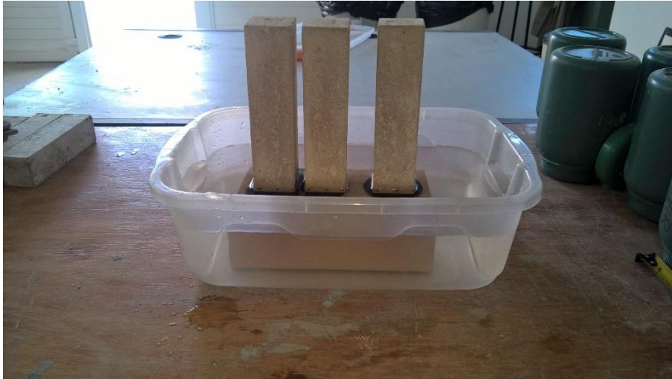
Figura 30. Ensaio de absorção de água por capilaridade.
