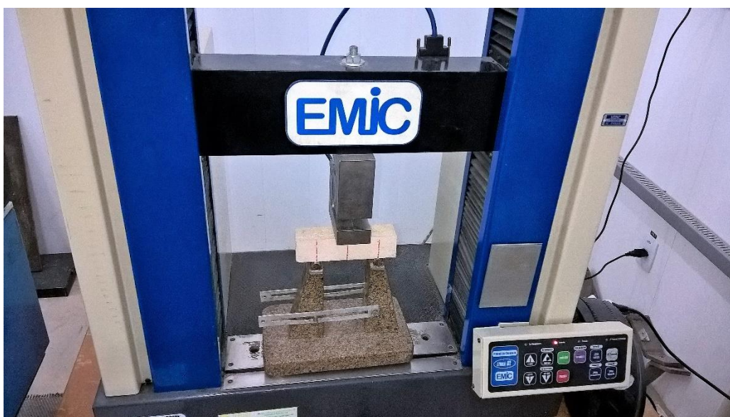
Figura 25. Ensaio para determinação da resistência à tração na flexão.
