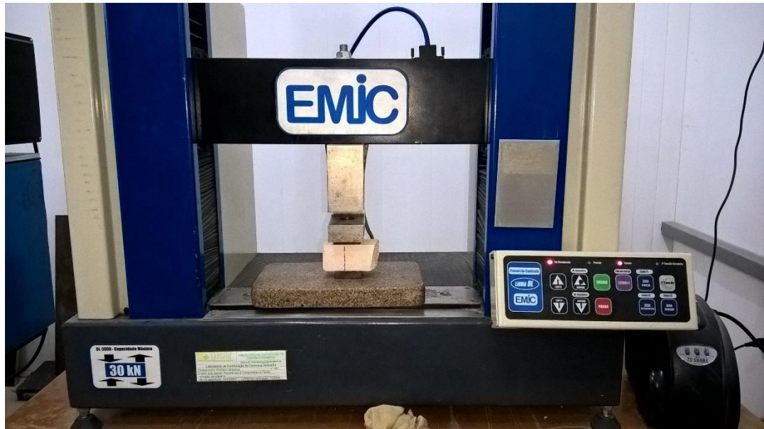
Figura 26. Ensaio para determinação da resistência à compressão axial.
