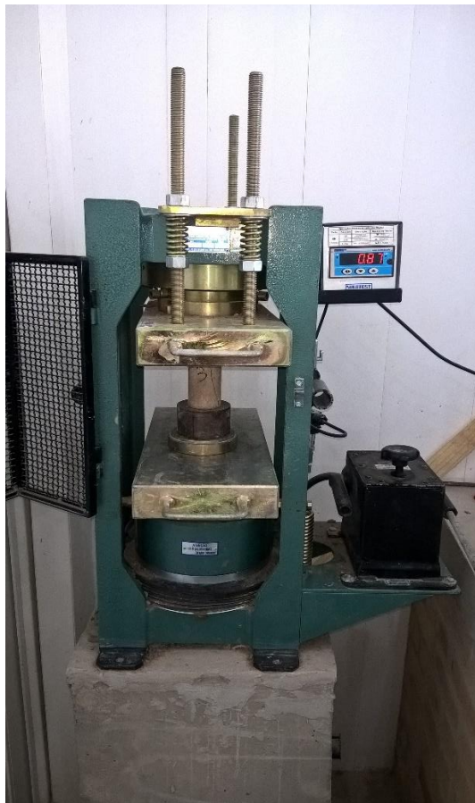
Figura 24. Ensaio de determinação da resistência à compressão axial.
