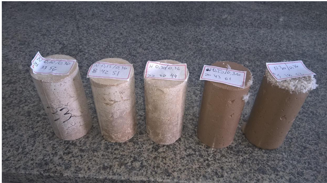
Figura 36. Diminuição gradual da eflorescência com a diminuição (da direita para a esquerda) da relação ativador/precursor, para argamassas geopoliméricas ativadas por NaOH.
