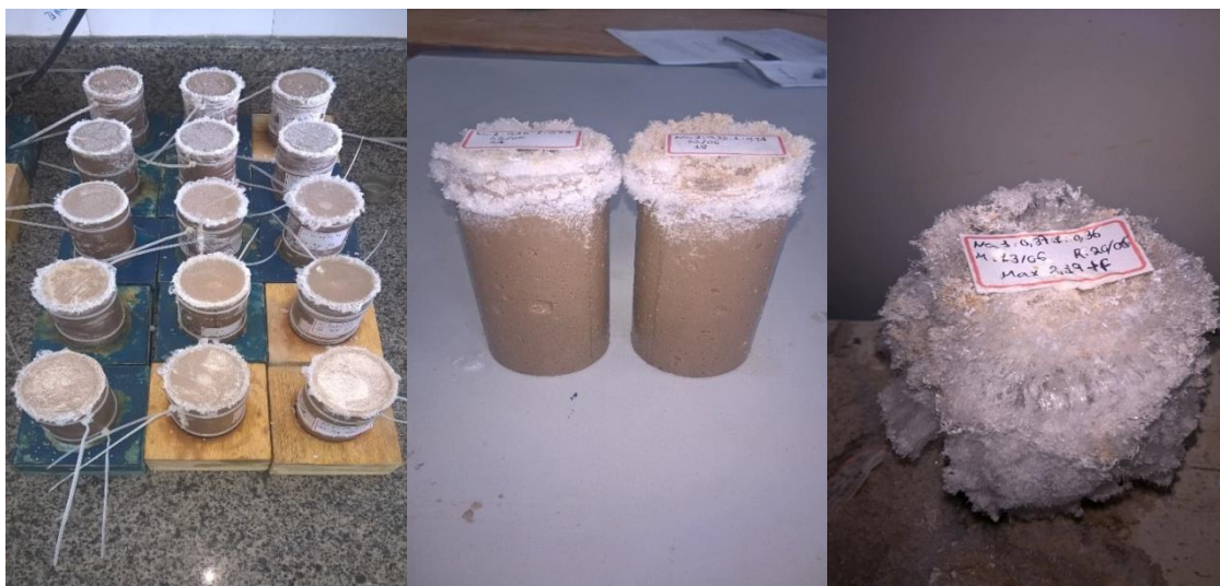
Figura 33. Eflorescência nas argamassas geopoliméricas ativadas por NaOH.
