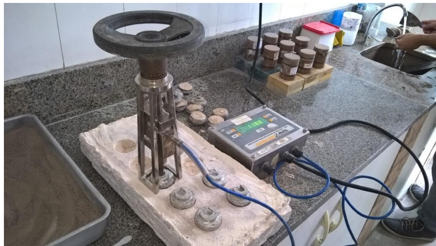
Figura 28. Execução do ensaio de determinação da resistência potencial de aderência à tração.
