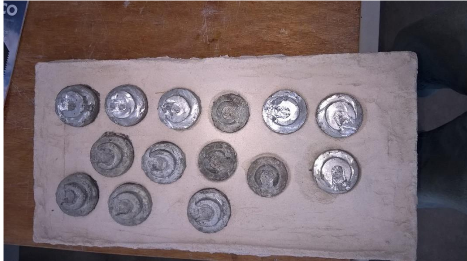
Figura 27. Colagem das pastilhas metálicas na superfície do substrato-padrão revestido com argamassa geopolimérica.
