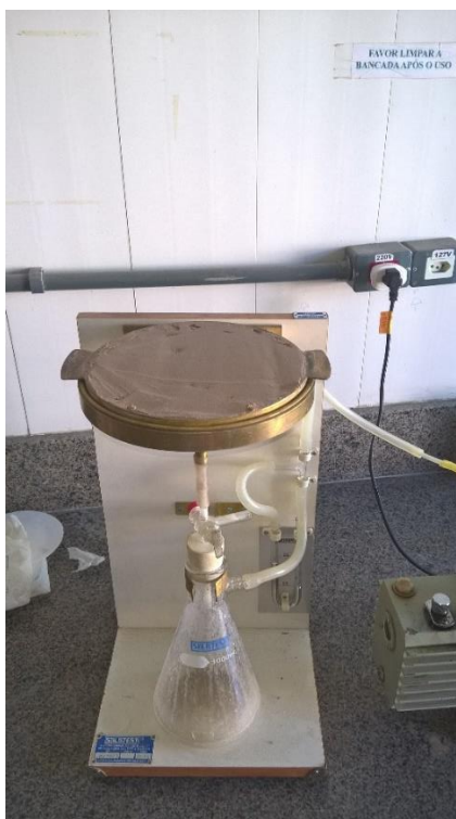
Figura 29. Execução do ensaio de determinação da retenção de água.
