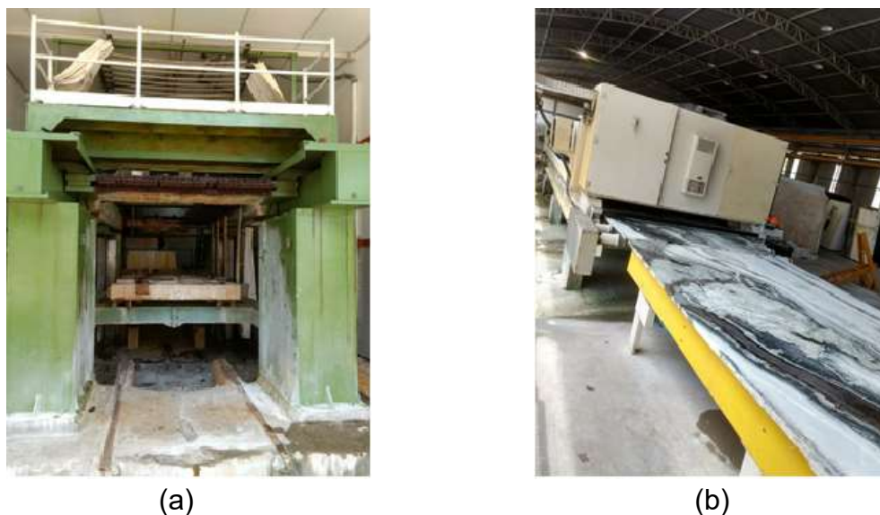
Figura 2-6: Processo de geração do resíduo do beneficiamento do mármore: (a) Tear de corte diamantado; (b) Máquina polidora de chapas.
