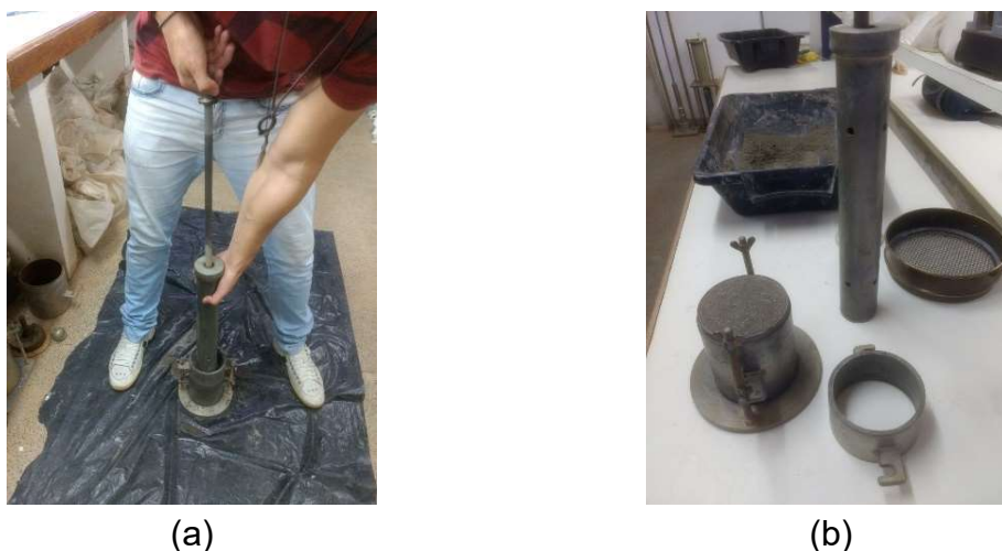
Figura 3-8: Metodologia experimental de compactação: (a) Compactação dinâmica do ensaio Proctor Normal; (b) Instrumentos do ensaio Proctor Normal.
