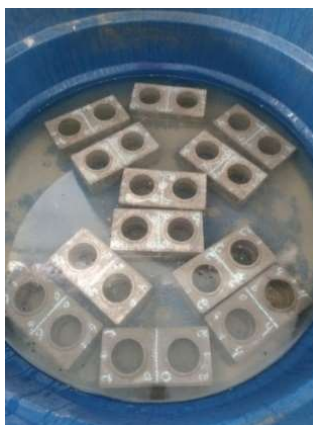
Figura 3-14: Procedimento para ensaio de absorção de água.
