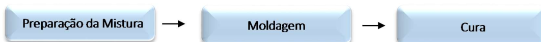
Figura 3-10: Fluxograma do processo de fabricação do bloco de solo-cimento pela NBR 12024 (ABNT, 2012).
