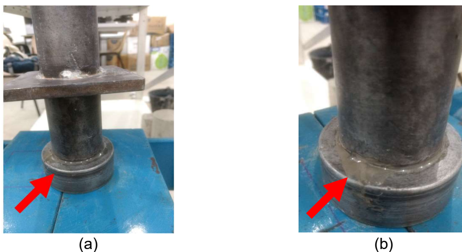
Figura 4-4: Perda de água por excesso de umidade: (a) e (b) Molde dos corpos-de-prova cilíndricos indicando perda de água na base.
