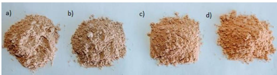
Figura 3.4: Metacaulim: a) Antes do tratamento térmico; Após tratamento térmico nas temperaturas de b) 700°C por 1 hora, c) 600°C por 2 horas e d) 500°C por 3 horas.
