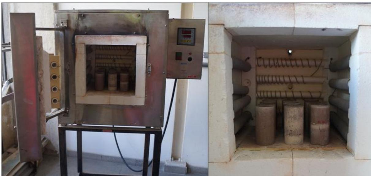
Figura 4.1: a) Forno mufla empregado no aquecimento dos corpos de prova;
