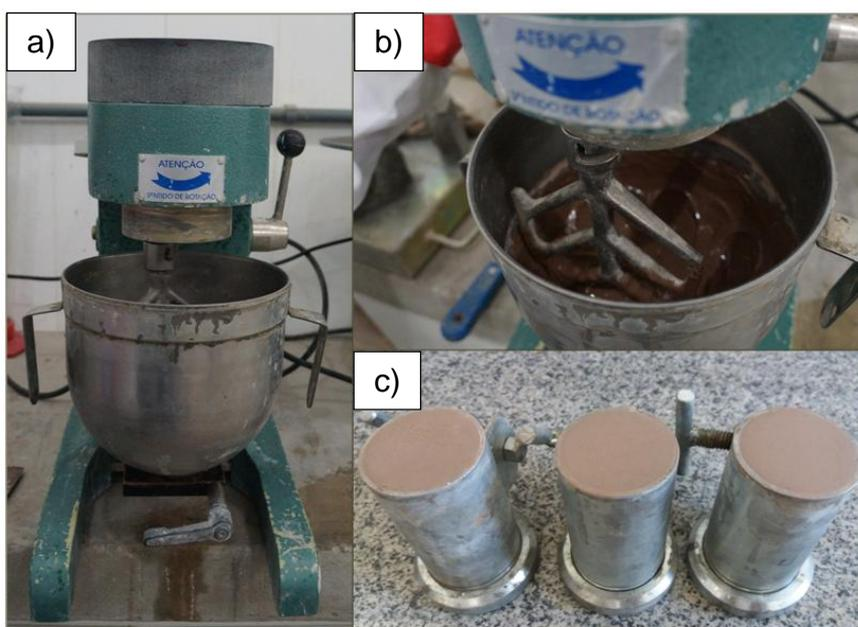
Figura 3.8: Produção das argamassas geopoliméricas. a) Argamassadeira; b) Mistura na argamassadeira; c) Mistura nos moldes metálicos.
