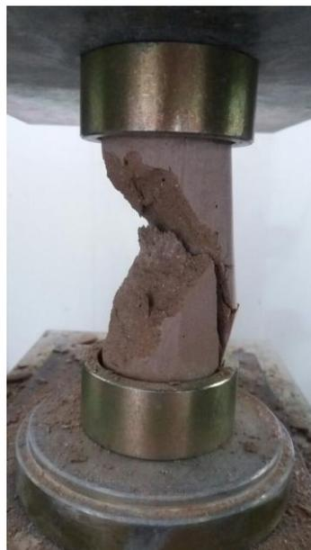
Figura 3.13: Modo de ruptura das argamassas geopoliméricas.
