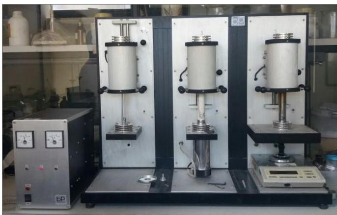
Figura 4.2: Equipamento de análise termogravimétrica RB-3000 da BP Engenharia.
