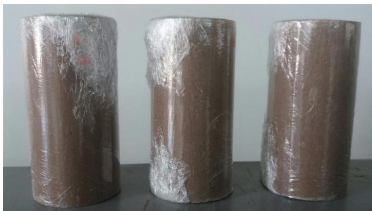
Figura 3.9: Corpos de prova envelopados com filme plástico.
