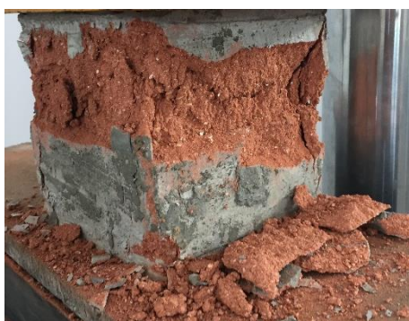
Figura G.1 - Bloco 1 rompido
