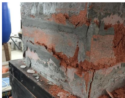
Figura G.8 – Prisma 3ISA 1 rompido
