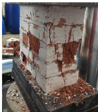
Figura G.14 – Prisma 5ISA 1 rompido
