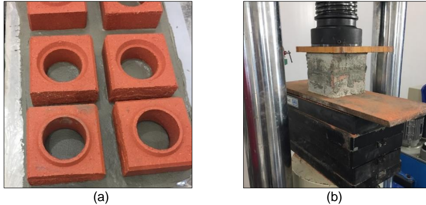
Figura 3.13 - Blocos com capeamento de pasta de cimento
