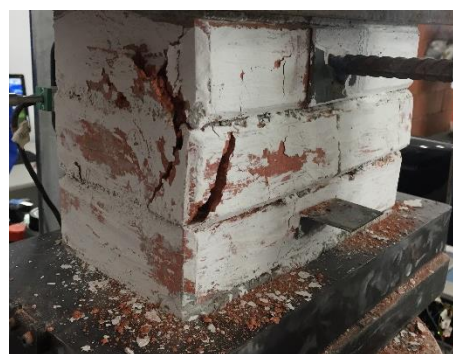
Figura G.10 – Prisma 3ISA 2 rompido
