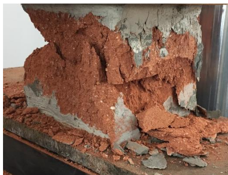
Figura G.3 – Bloco 3 rompido
