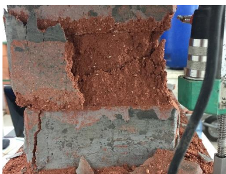
Figura G.11 – Prisma 3ISA 3 rompido
