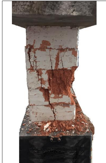
Figura 4.26 – Ruptura de pequena parede (PPSA)
