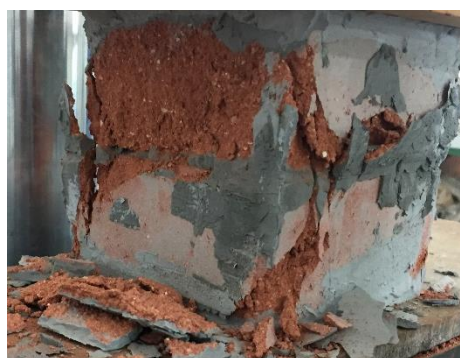
Figura G.2 – Bloco 2 rompido
