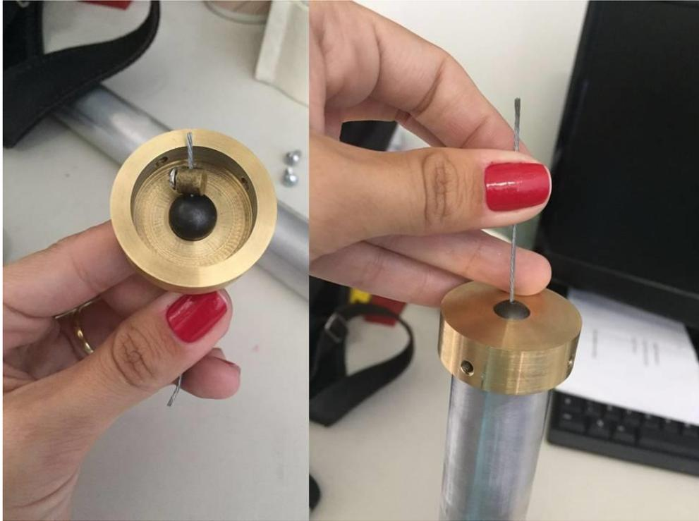
Figura 3.18–Cabeça de carregamento da estaca.
