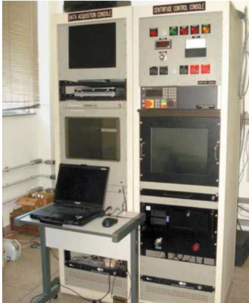
Figura 3.12 – Sala de controle e aquisição de dados da centrífuga.
