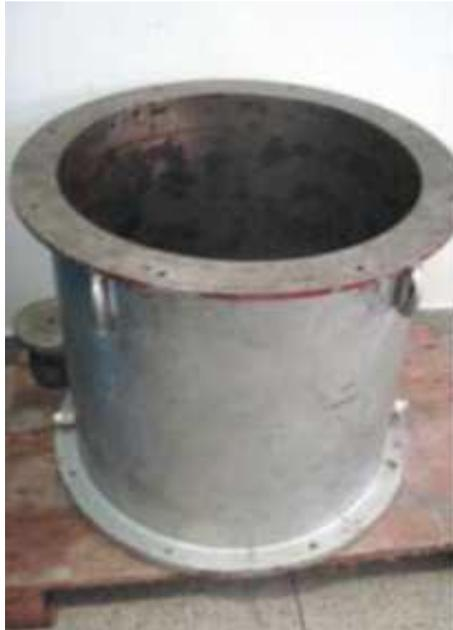
Figura 3.2 – Caixa teste cilíndrica para elaboração dos modelos físicos.
