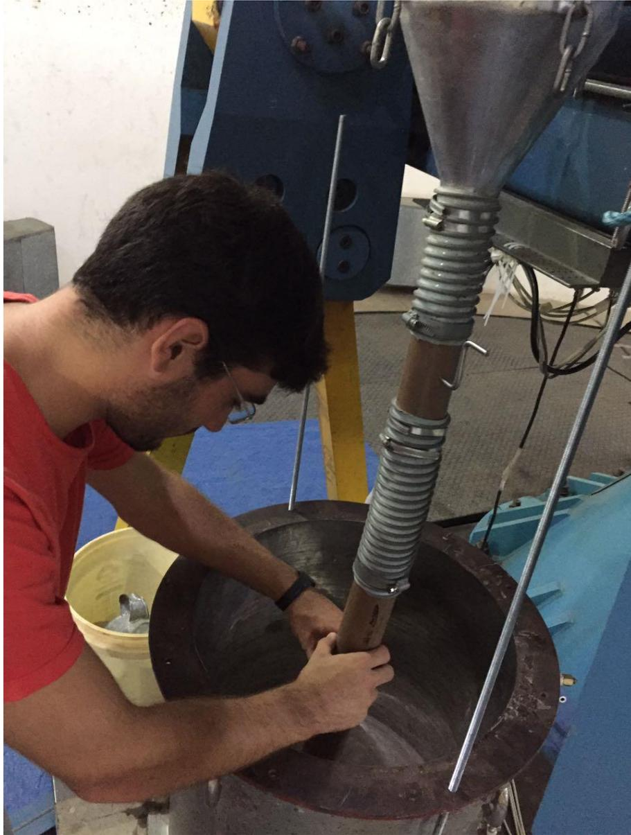
Figura 3.15 – Procedimento de pluviação na caixa cilíndrica da centrífuga.
