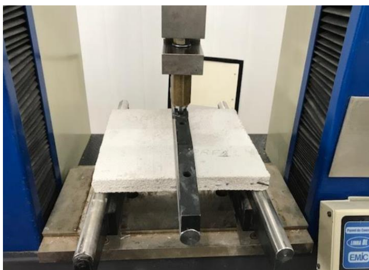
Fig. 3.8 – Execução do ensaio de resistência à tração na flexão. FONTE: Próprio Autor
