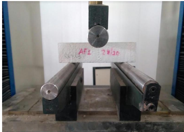
Fig. 2.10 – Execução do ensaio de resistência a flexão em corpos de prova prismáticos. Fonte: Próprio Autor
