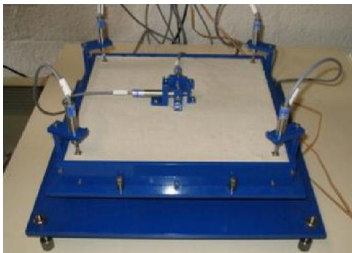
Fig. 2.13 – Instrumentação da placa para acompanhamento do empenamento das bordas (curling).
