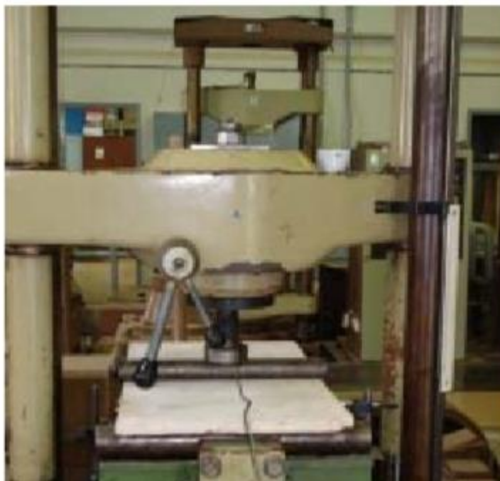
Fig. 2.11 – Exemplo de Execução do ensaio de resistência mecânica em placas. Fonte: PUC CAMPINAS
