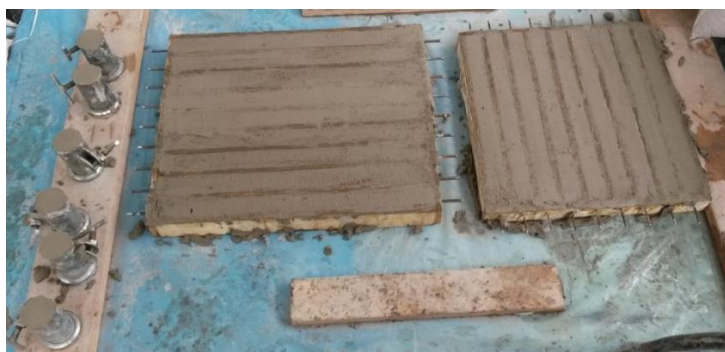
Figura 3.45 - Aparência dos corpos de prova de tirantes e cilíndricos, logo após a moldagem.
