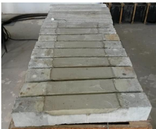
Figura 3.81 - Vigas reparadas com ACQT.
