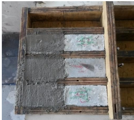
Figura 3.68- Confeção dos corpos de prova mistos da série CG.
