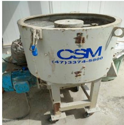
Figura 3.44 - Misturador planetário utilizado para confecção das argamassas de reparo.
