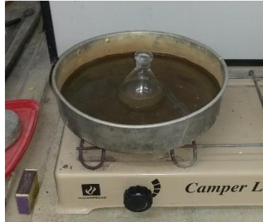
Figura 3.1 - Massa específica da areia obtida por picnometria.
