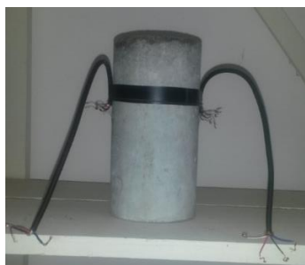
Figura 3.57- Corpo de prova cilíndrico de concreto instrumentado com dois extensômetros do tipo roseta.
