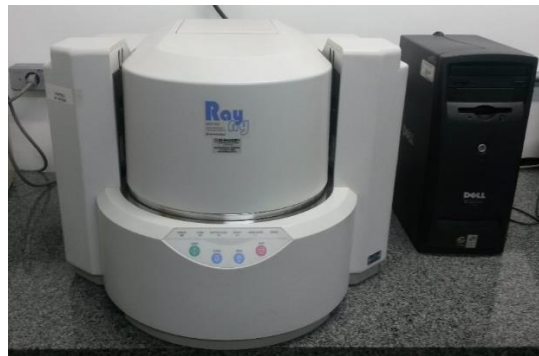
Figura 3.3 - Equipamento Shimadzu EDX- 720 com tubo de 3 kW e alvo de ródio.
