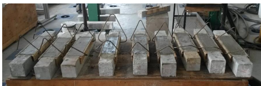
Figura 3.80 - Vigas reparadas com AGT1.
