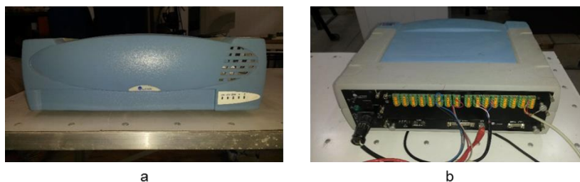
Figura 3.25 - Condicionador Lynx ADS 2000 de 16 bits: (a) frente; (b) traseira.
