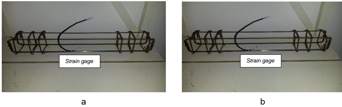
Figura 3.36 - Armaduras com extensômetros: (a) CA-60; (b) CA-25.
