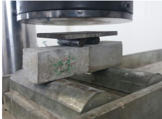
Figura 3.70 - Configuração do ensaio de resistência de aderência à tração na flexão.
