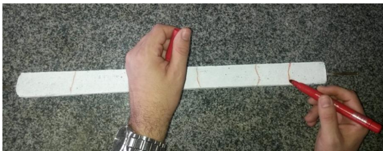
Figura 3.73 - Fissuras sendo realçadas no tirante após o ensaio de tração direta.
