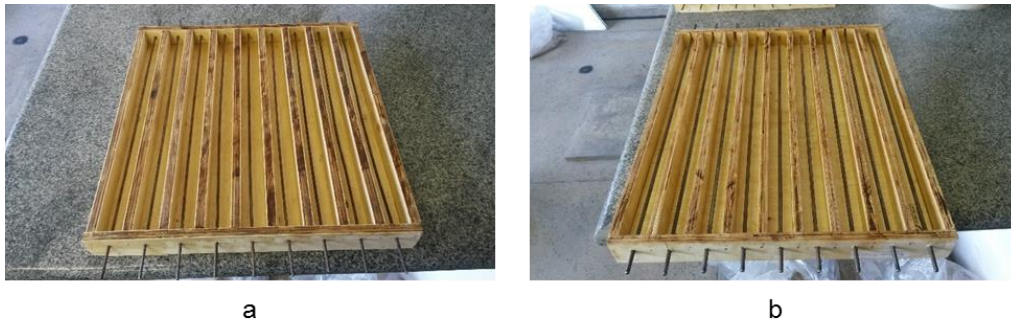
Figura 3.34 - Fôrmas para tirantes com as barras de aço inseridas e fixadas: (a) CA-60; (b) CA-25.
