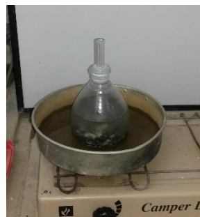
Figura 3.2 - Massa específica da brita 0 obtida por picnometria.
