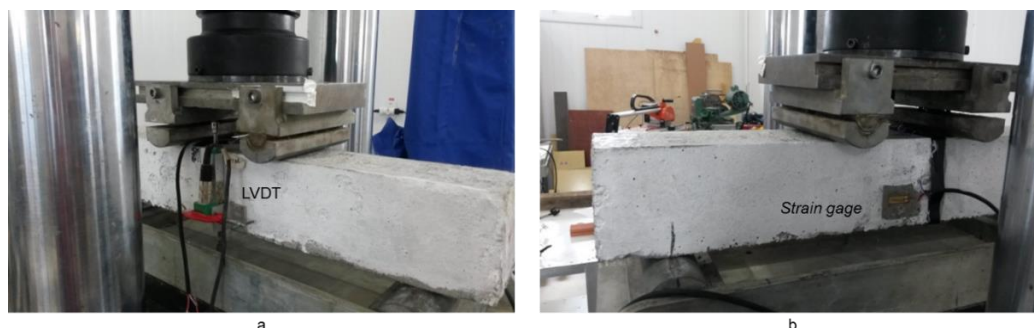
Figura 3.85 - Pontos de aplicação das cargas e pontos de apoio no ensaio.
