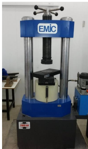
Figura 3.55 - Prensa utilizada na caracterização mecânica do concreto do substrato e das argamassas de reparo.
