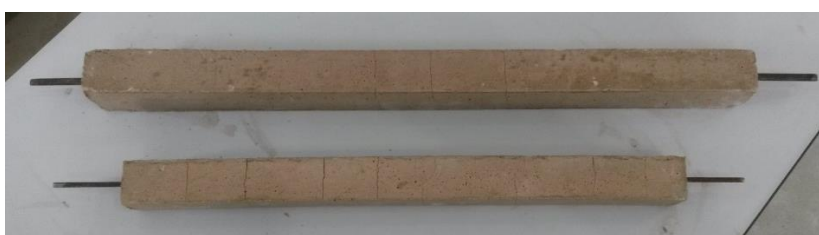
Figura 3.74 - Tirantes da AGT1 pré-fissurados.
