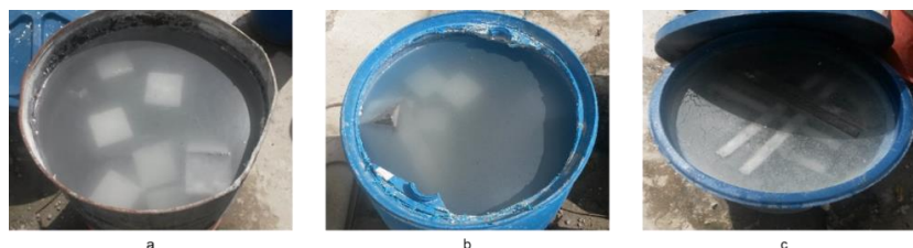
Figura 3.42 - Corpos de prova submersos em água saturada de hidróxido de cálcio: (a) vigas; (b) cilíndricos e mistos; (c) tirantes.
