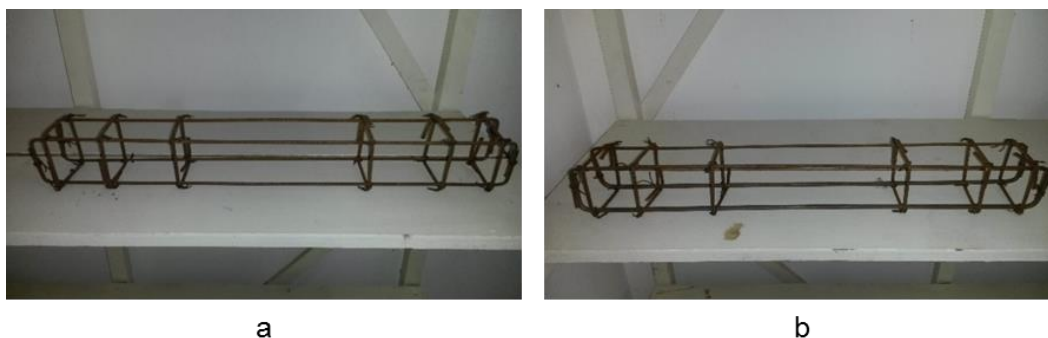
Figura 3.21 - Armaduras prontas para uso: (a) armadura 1 com armadura de flexão CA-60; (b) armadura 2 com armadura de flexão CA-25.
