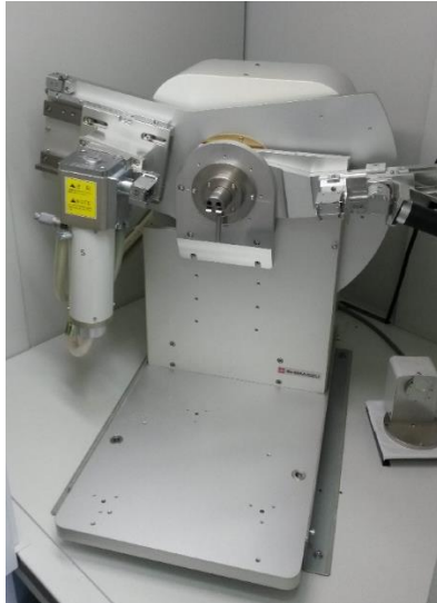
Figura 3.6 - Difratorômetro de raios X da marca Shimadzu, modelo XRD-7000.
