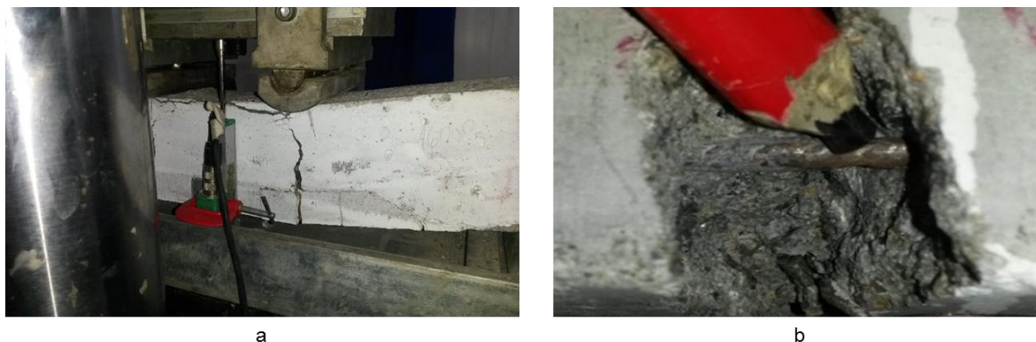
Figura 4.14 - (a) Momento da ruptura da viga I2; (b) deformação excessiva do aço após a ruptura da viga I2.
