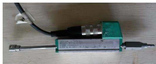
Figura 3.23 - LVDT utilizado para medição dos deslocamentos verticais nas vigas.
