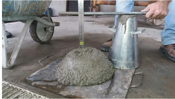
Figura 3.40 - Ensaio de abatimento do tronco de cone, conforme preconiza a ABNT NBR NM 67 (1998).
