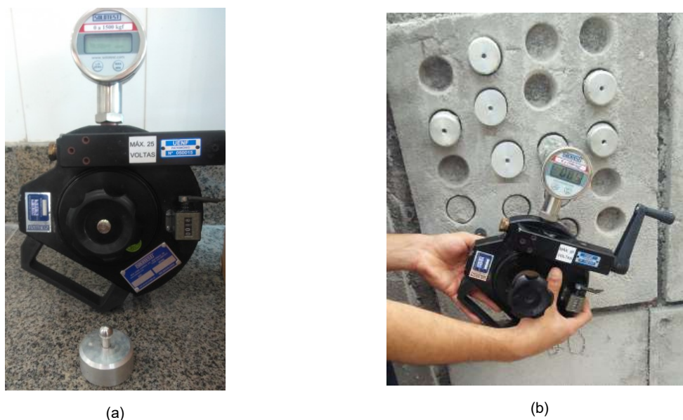
Figura 3.10– (a) Dinamômetro utilizado na pesquisa e (b) Ensaio de resistência à aderência entre substrato e argamassa.
