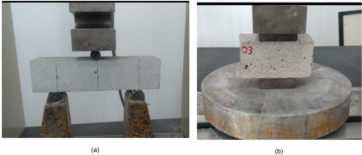
Figura 3.7– (a) Ensaio de tração na flexão e (b) ensaio de compressão em CP de argamassa.
