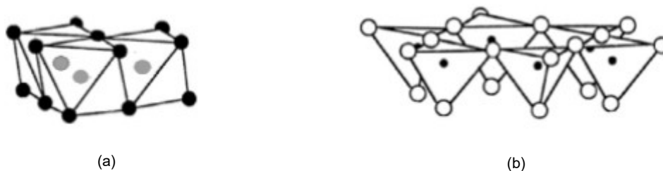
Figura 2.10 – Esquemas das unidades cristalográficas básicas dos argilominerais, (a) octaedro e (b) tetraedro.
