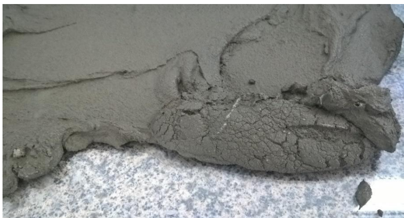
Figura 7 - Aparência da argamassa vencida. Traço feito com três horas.
