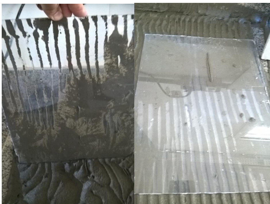
Figura 8 – Preenchimento do tardez reproduzido para teste.
