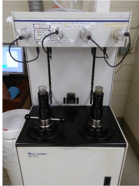
Figura 3.30. Porosímetro Micrometrics AutoPore IV 9500 Series.
