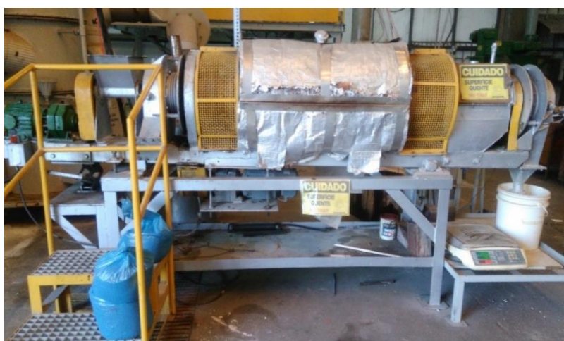
Figura 3.5. Planta piloto de calcinação: forno rotativo.
