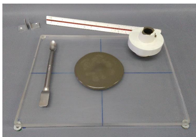
Figura 3.26. Ensaio de mini abatimento de cone de Kantro.
