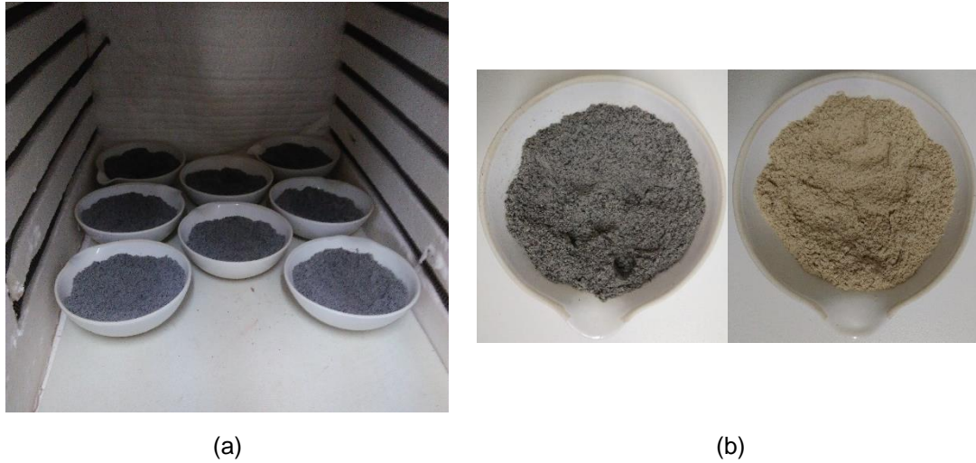
Figura 3.12. Requeima no forno mufla (a) e detalhe da cinza separada por diferenças de densidade após requeima no forno piloto (à esquerda) e após requeima em forno mufla (à direita) (b).
