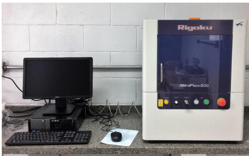
Figura 3.22. Difratorômetro de raios X Rigaku Miniflex 600.
