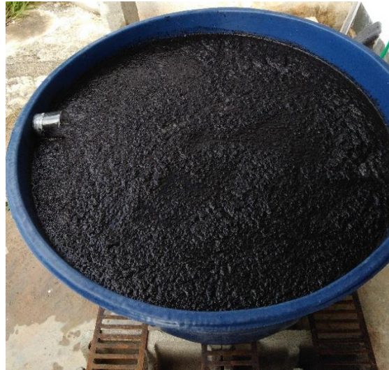
Figura 3.3. Procedimento de separação por fracionamento densimétrico da cinza residual.
