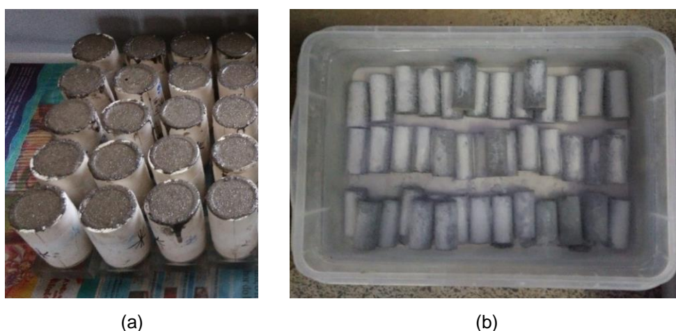
Figura 3.33. Moldes de PVC preenchidos com a mistura (a) e corpos de prova em cura submersa (b).
