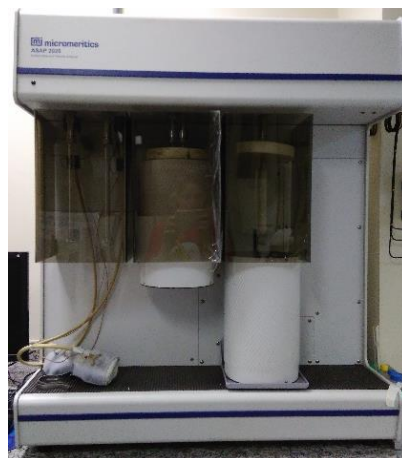
Figura 3.21. Equipamento de adsorção de nitrogênio Micromeritics Asap 2020.
