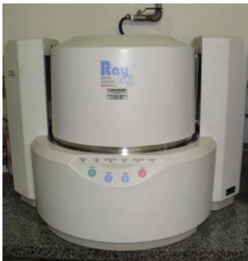
Figura 3.18. Espectrômetro de fluorescência de raios X Shimadzu EDX-720.
