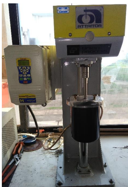
Figura 3.15. Moinho atritor, da Union Process, utilizado na moagem das cinzas original e separadas por diferenças de densidade.
