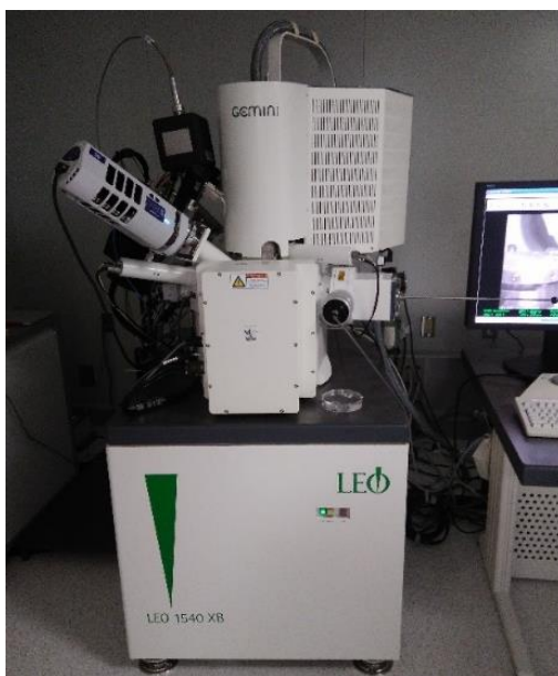
Figura 3.23. Microscópio eletrônico de varredura Zeiss LEO 1540XB FIB/SEM.
