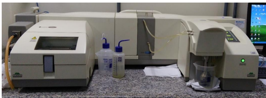
Figura 3.19. Granulômetro a laser Malvern Mastersizer 2000.
