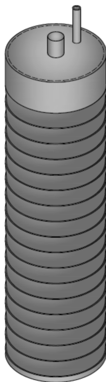
Figura 16: Modelo da estaca de sucção R3 (dezessete ranhuras)
