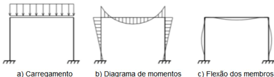
**Figura 2.2.** Pórtico com ligações rígidas (FIGUEIREDO, 2004).
