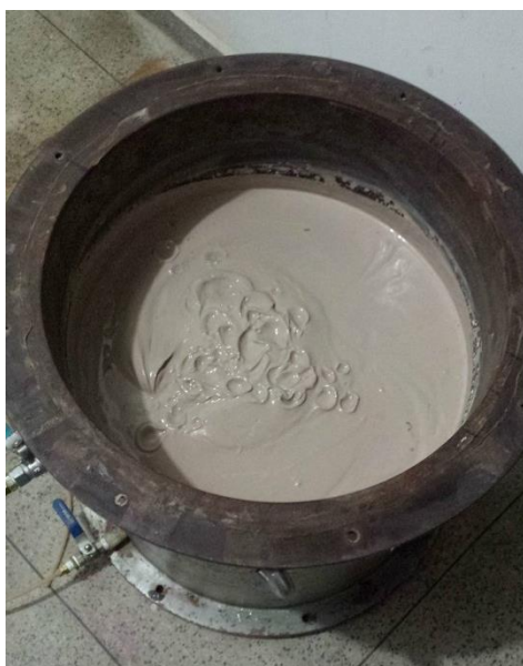
Figura 3.7: Lama recém lançada ao container.
