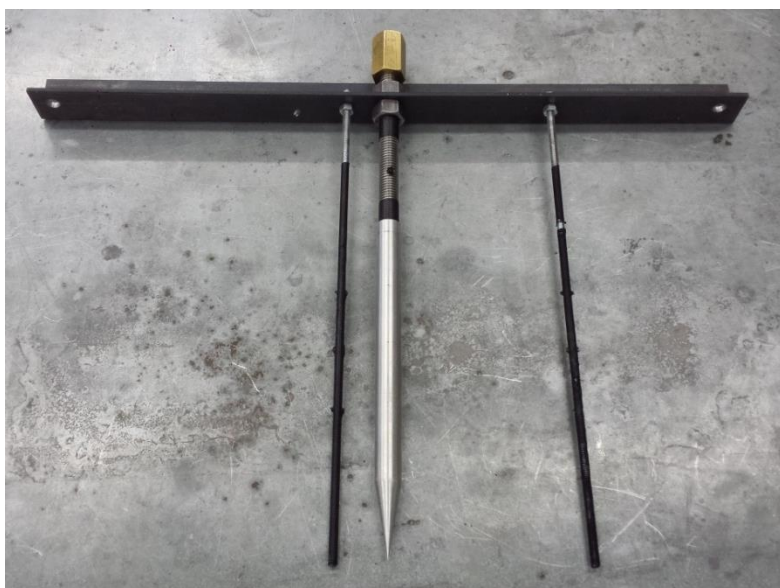
Figura 3.10: Conjunto para cravação da estaca e da instrumentação.
