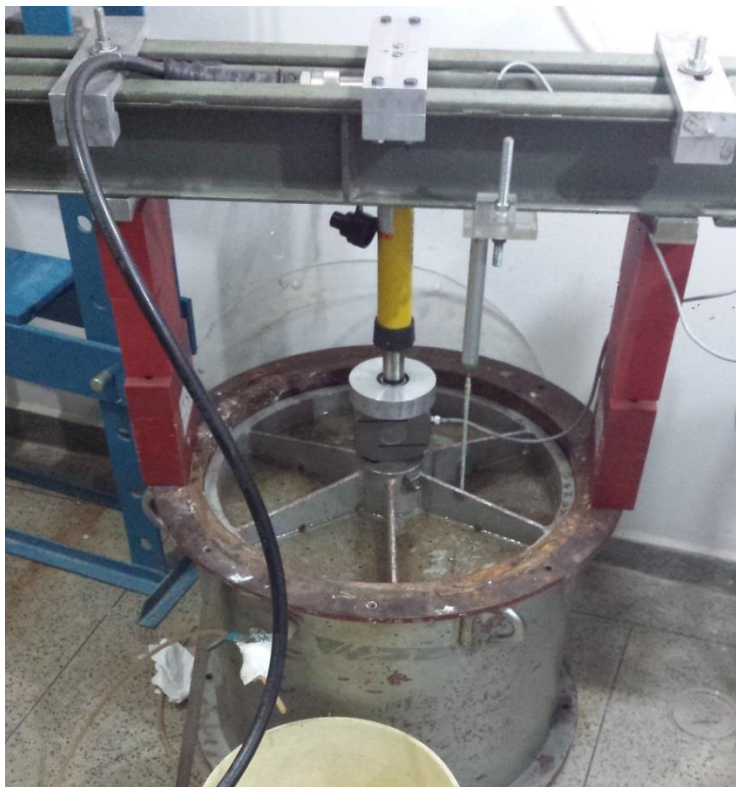
Figura 3.8: Adensamento mecânico com auxílio de bomba hidráulica.
