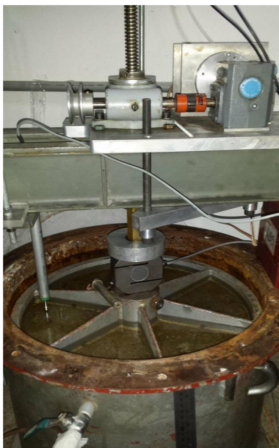
Figura 3.9: Esquema utilizado para adensamento mecânico do solo com motor elétrico.
