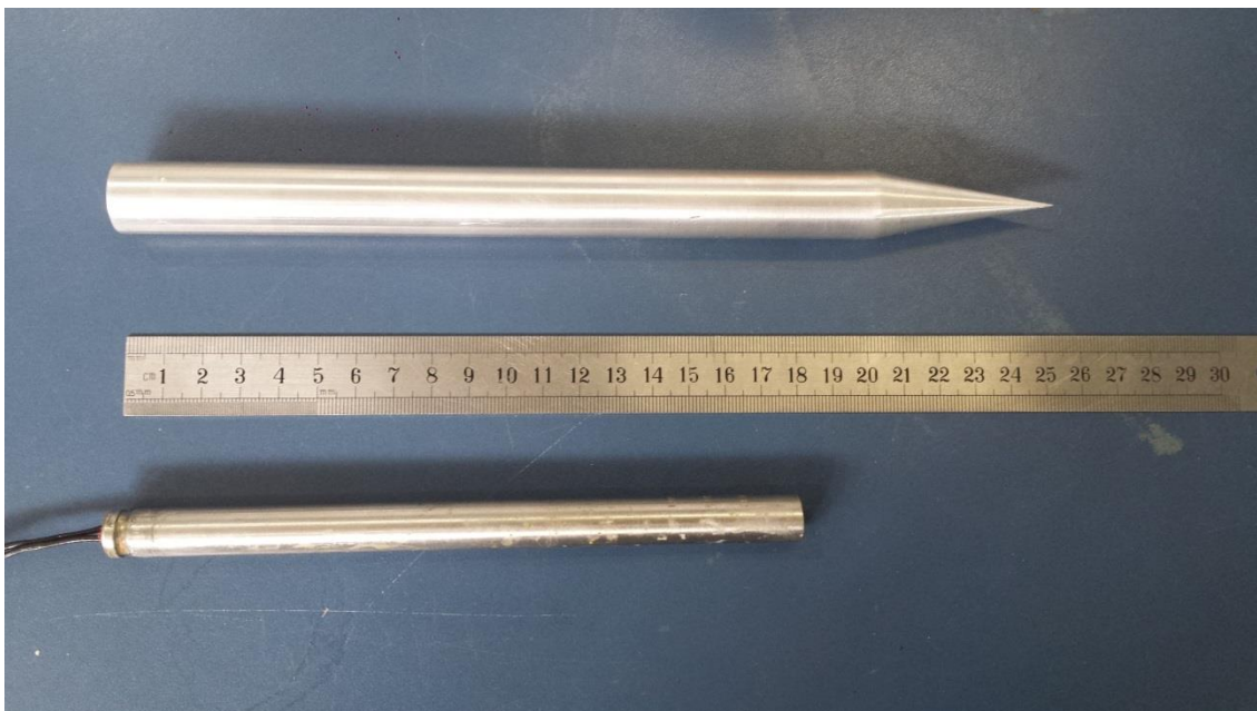
Figura 3.1: Estaca e heater utilizados nos ensaios.
