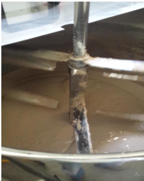
Figura 3.6: Mistura dos componentes caulim, metacalim e água.
