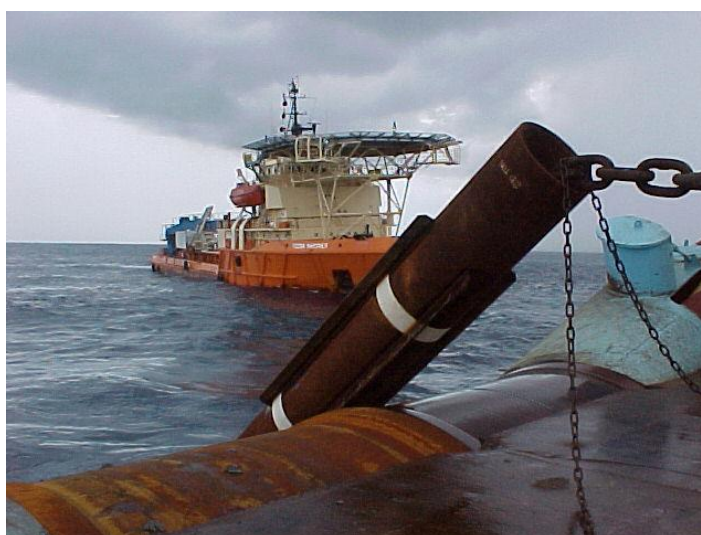
Figura 2.26: Lançamento de estaca torpedo para ancoragem de risers (Kunitaki, 2006).
