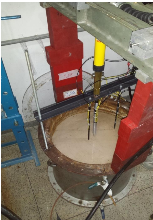
Figura 3.14: Sistema de cravação do torpedo e hastes de instrumentação.
