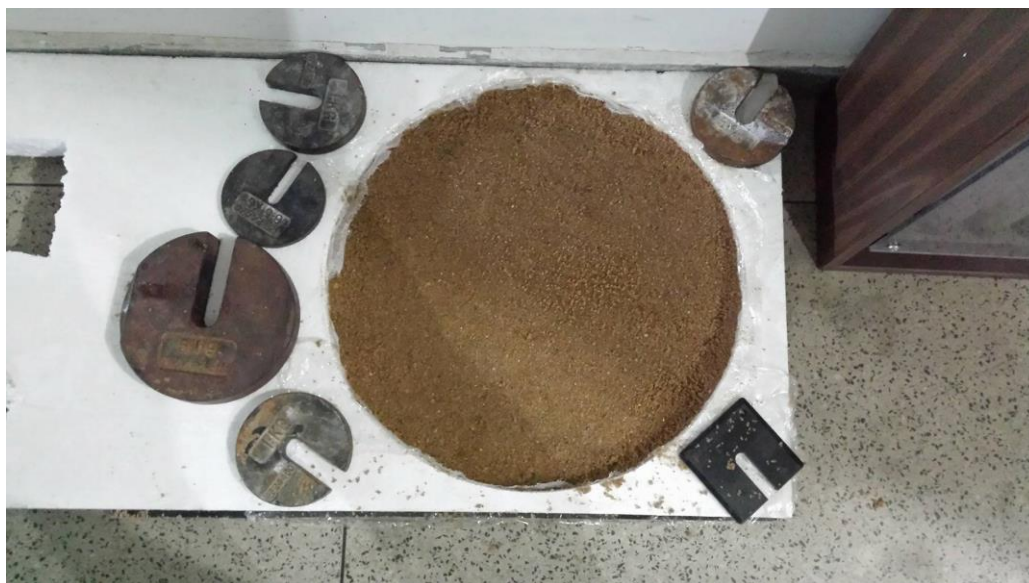
Figura 3.5: Confeção de pedra porosa para container de ensaio.
