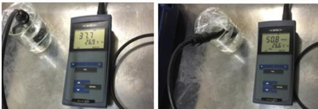
Figura 3.11 – Medidor de concentração portátil WTW- Profiline OXI 3205.
