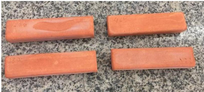
Figura 4.9 – Corpo de prova após ciclo de imersão – temperatura 950 °C
