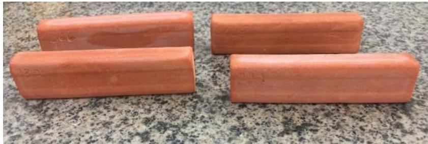
Figura 4.8 – Corpo de prova após ciclo de imersão – temperatura 950 °C
