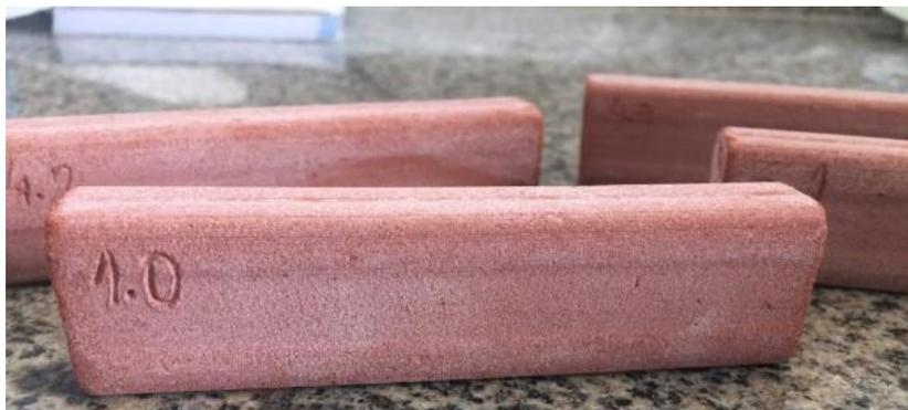
Figura 4.10 – Corpo de prova após ciclo de imersão – temperatura 1050 °C
