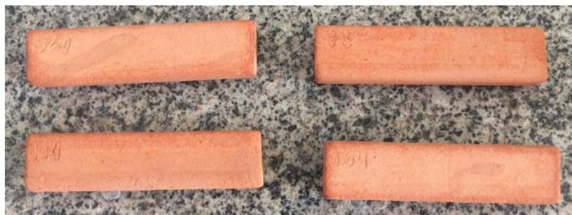
Figura 4. 6 – Corpo de prova após ciclo de imersão – temperatura 600°C
