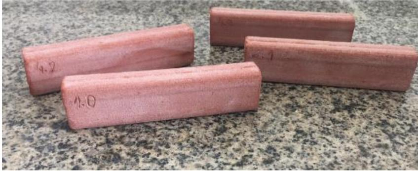
Figura 4.11 – Corpo de prova após ciclo de imersão – temperatura 1050 °C
