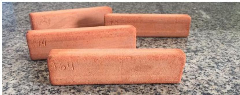
Figura 4. 5 – Corpo de prova após ciclo de imersão – temperatura 600°C
