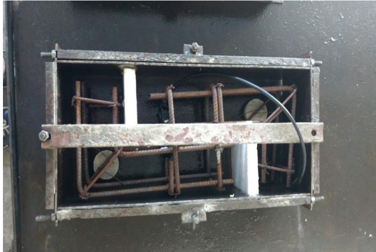
Figura 3.14 - Forma preparada com 2 barras na armadura transversal
