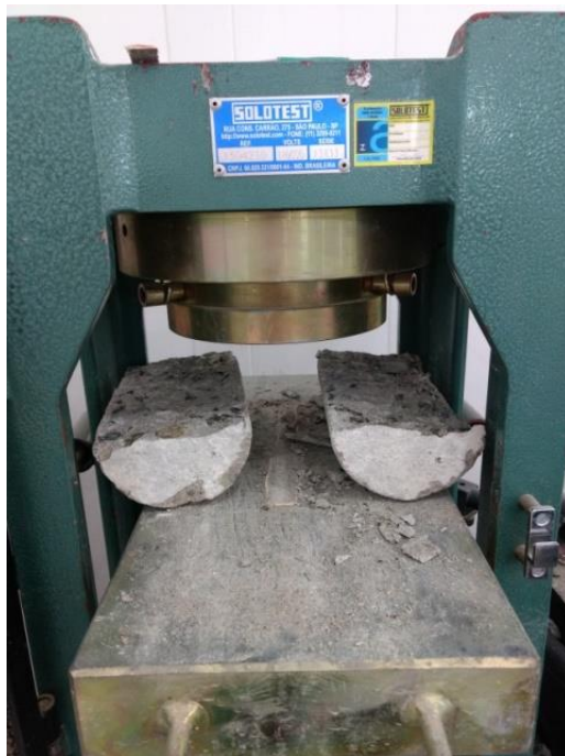
Figura 3.6 - Corpo de prova rompido por tração indireta
