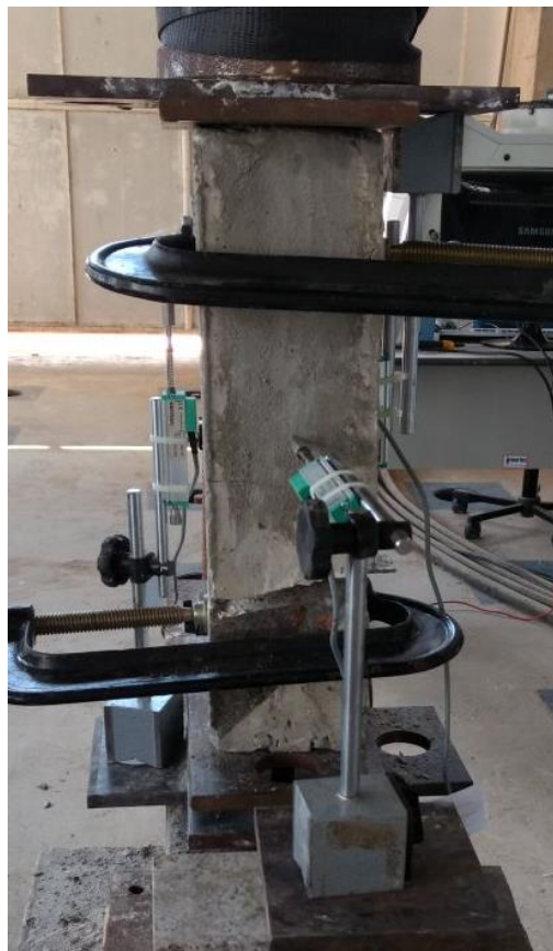
Figura 3.18 - Corpo de prova no ensaio de cisalhamento direto (vista Lateral 2)
