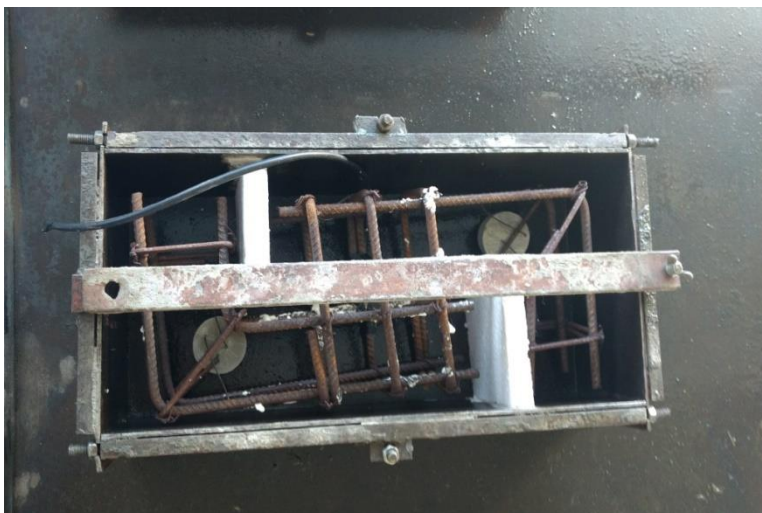
Figura 3.13 - Forma preparada com 3 barras na armadura transversal
