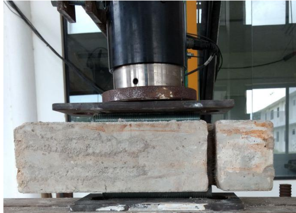
Figura 3.15 - Corpo de Prova pronto para ser pré-fissurado
