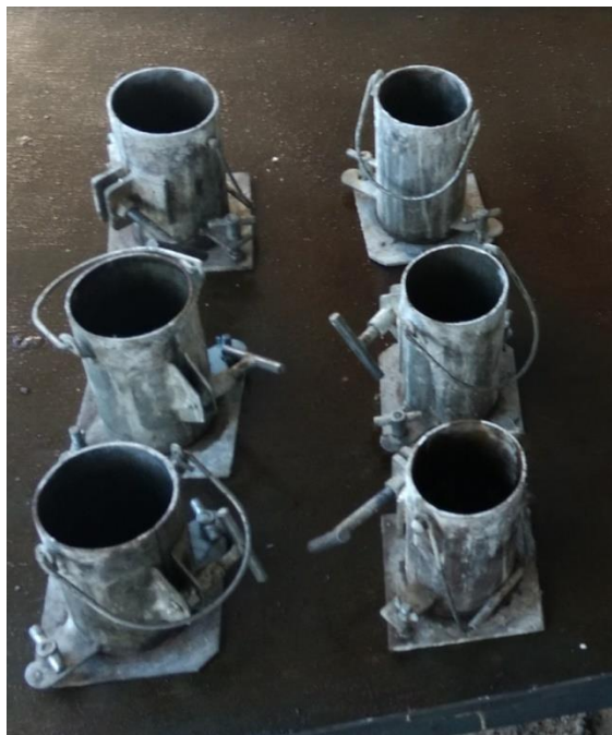
Figura 3.2 - Formas cilíndricas para moldagem dos corpos de prova
