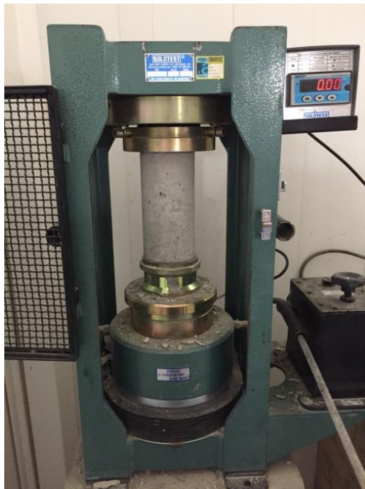
Figura 3.4 - Corpo de prova posicionado no interior da prensa
