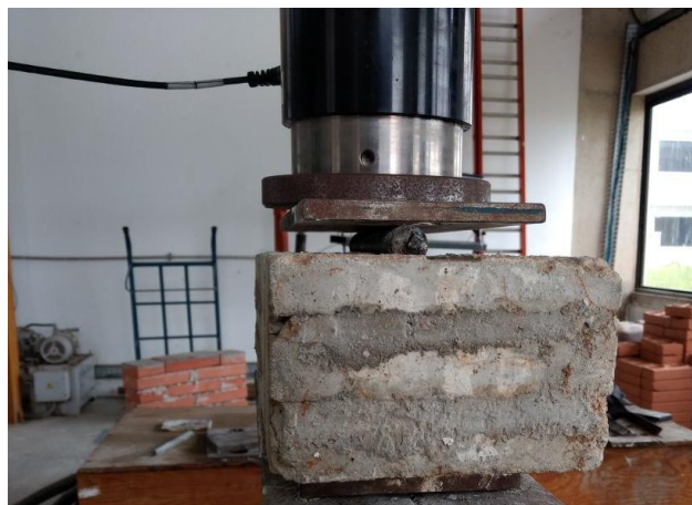
Figura 3.16 - Esquema de pré-fissuração do corpo de prova
