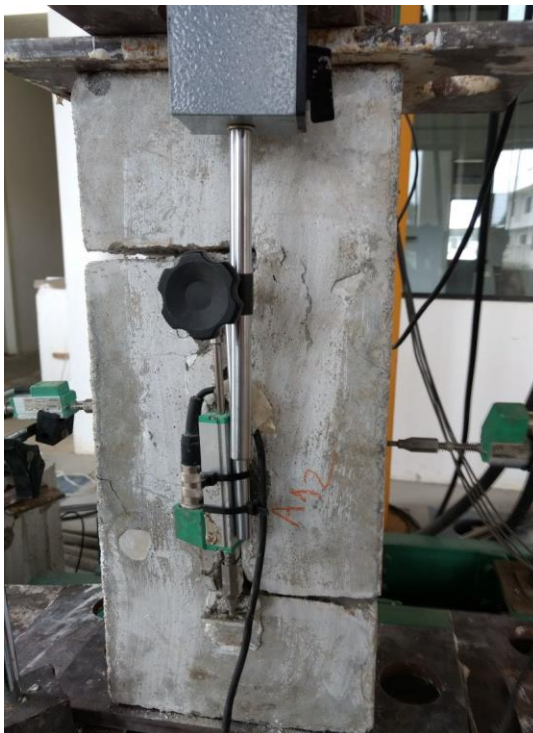
Figura 4.7 - Corpo de prova ao final do ensaio de cisalhamento direto
