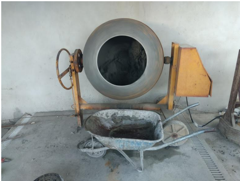
Figura 3.1 - Betoneira durante o processo de produção do concreto
