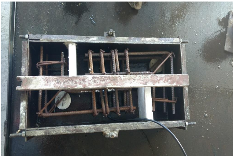
Figura 3.12 - Forma preparada com 4 barras na armadura transversal
