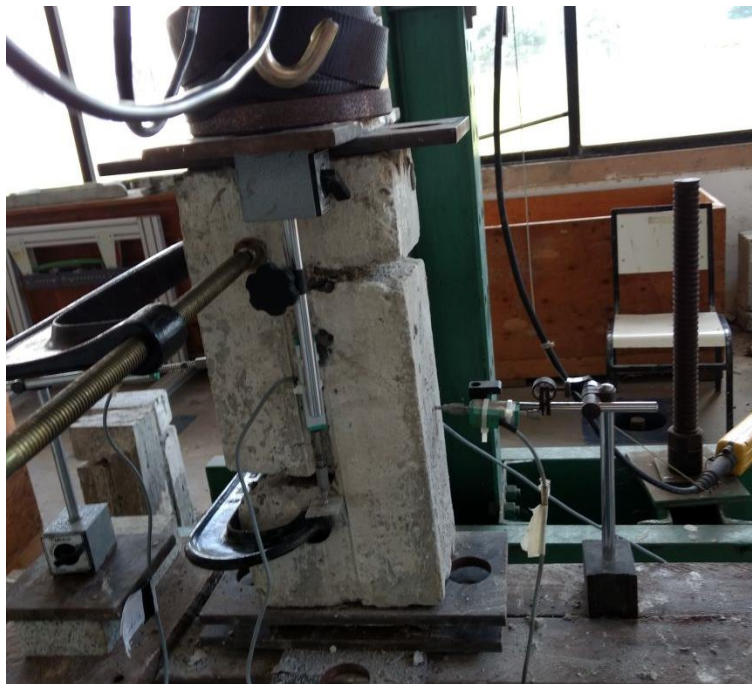
Figura 3.20 - Corpo de prova no ensaio de cisalhamento direto (vista posterior)
