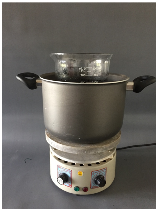
Figura 3.12 – Lixiviação da cinza residual em ácido clorídrico (HCl) 1 N a 90°C por 2 h.
