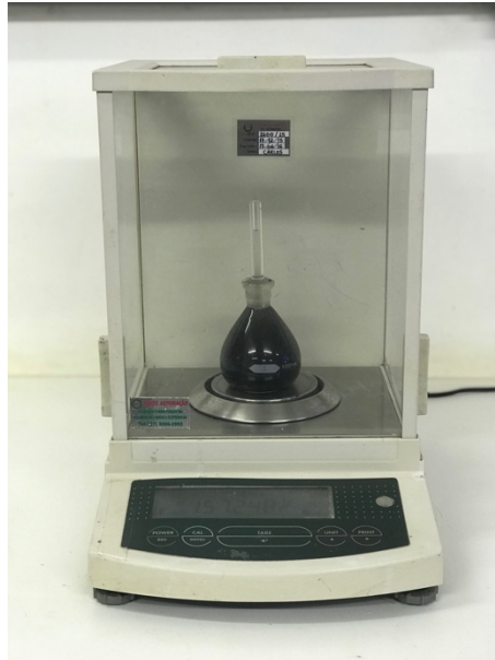
Figura 3.24 – Pesagem do picnômetro com amostra para determinação da massa específica.
