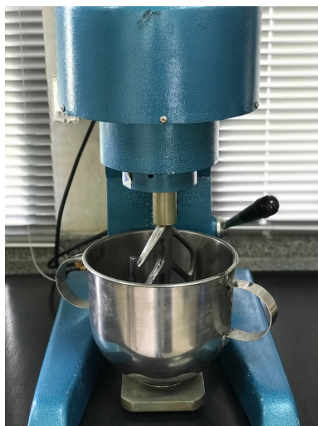
Figura 3.40 – Misturador de bancada utilizado na confecção dos microconcretos.
