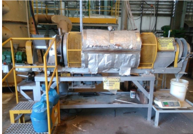
Figura 3.7 – Planta piloto de calcinação: forno rotativo (ANDREÃO, 2018).
