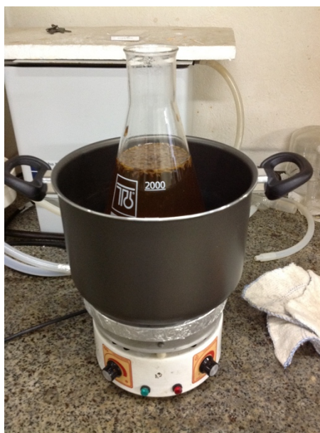
Figura 3.16 – Lixiviação da casca de arroz em ácido clorídrico (HCl) 1 N a 90°C por 2 h.
