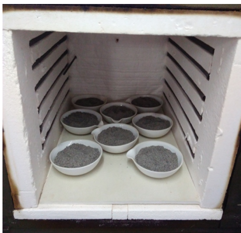
Figura 3.4 – Queima de cinza residual em forno tipo mufla do Nexmat/LECIV/UENF para produção da CBCA2.
