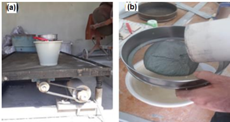
Figura 4.8 - Peneiramento com auxílio de mesa vibratória (a); resíduo retido na peneira (b).
