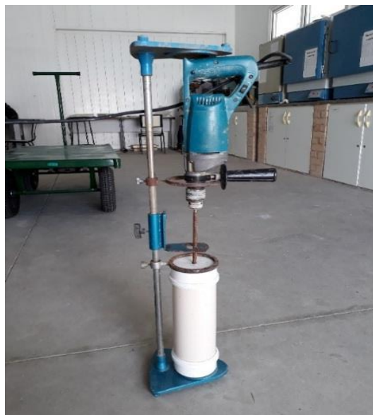
Figura 4.5 – Mistura mecânica do lodo primário com água de amassamento.
