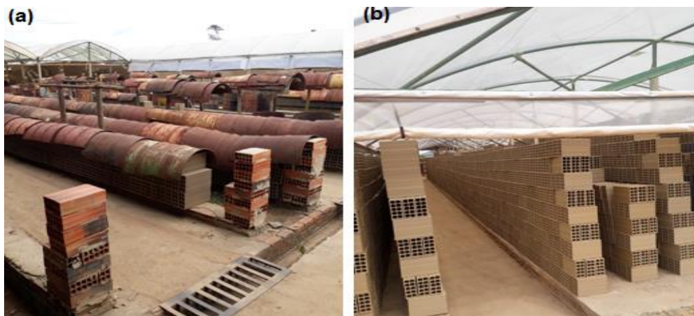
Figura 3.6 –Secagem dos blocos cerâmicos – natural (a) e artificial (b). Fonte: Acervo próprio.
