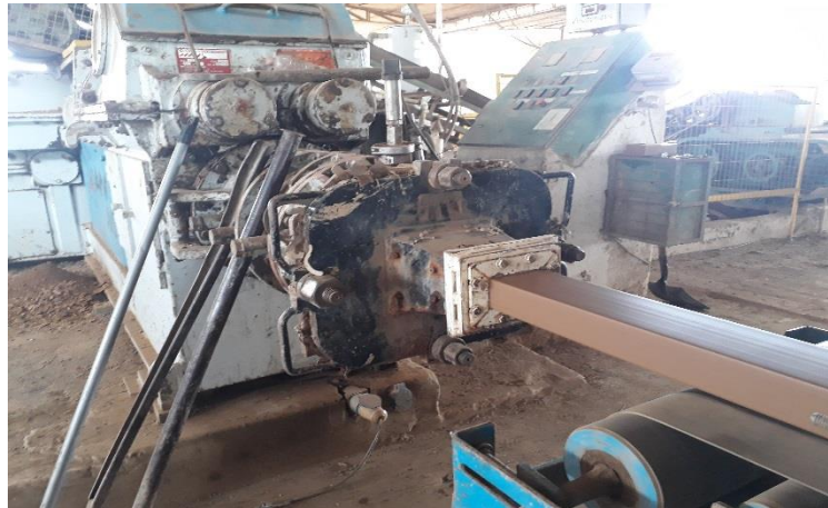
Figura 3.5 – Conformação de blocos cerâmicos por extrusão. Fonte: Acervo próprio.
