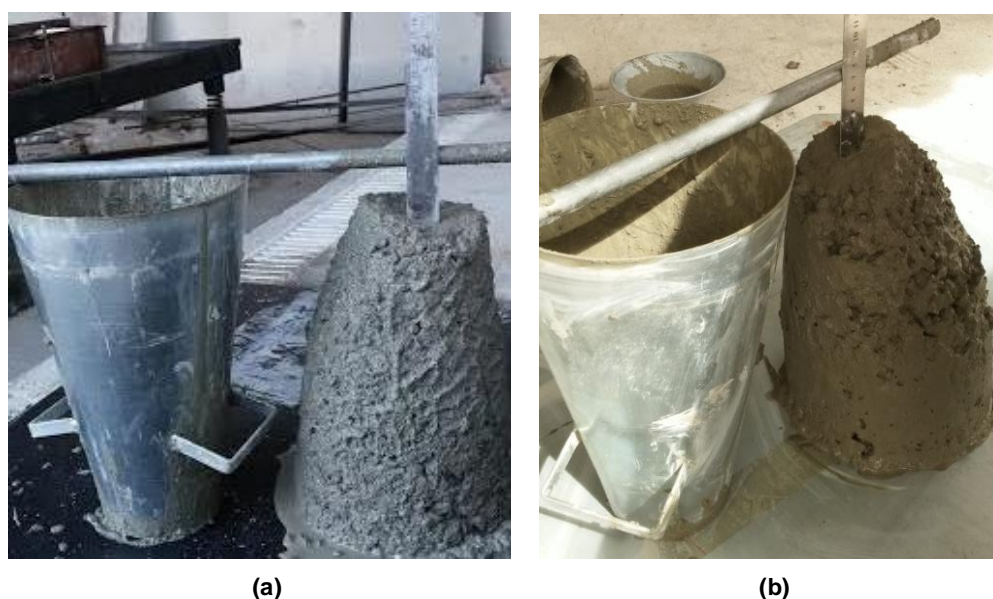
Figura 3.8 – Procedimento de ensaio de abatimento do tronco de cone realizado para os concretos: a) CCR e b) CLE.
