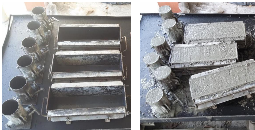
Figura 3.13 – Moldagem dos corpos de prova cilíndricos e prismáticos para o concreto CCR em mesa vibratória.
