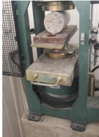
Figura 3.22 – Configuração do ensaio de resistência à compressão diametral.
