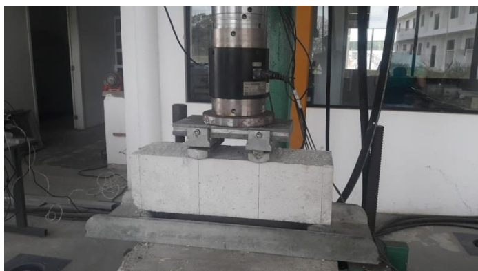
Figura 3.20 – Configuração do ensaio de resistência à tração na flexão.
