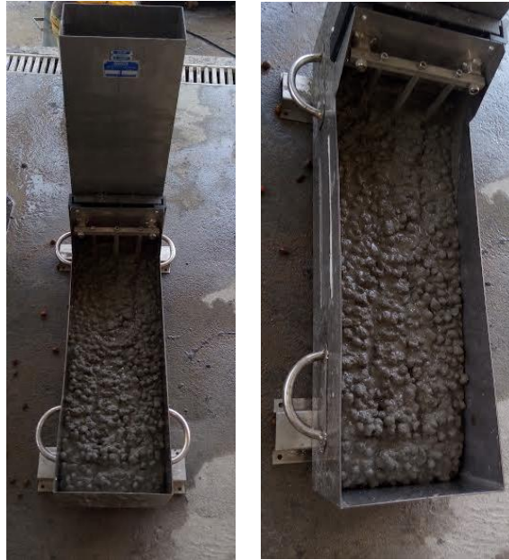
Figura 3.11 – Procedimento de ensaio da caixa-L realizado para os CLAA.
