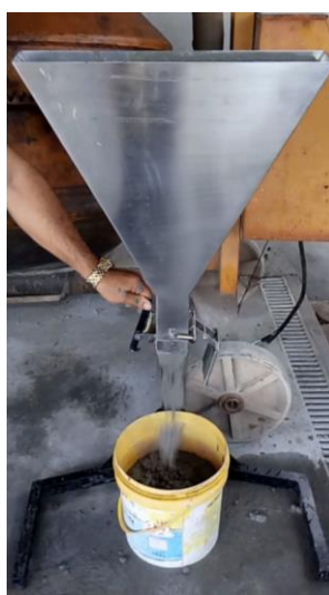
Figura 3.10 – Procedimento de ensaio do funil-V realizado para os CLAA.
