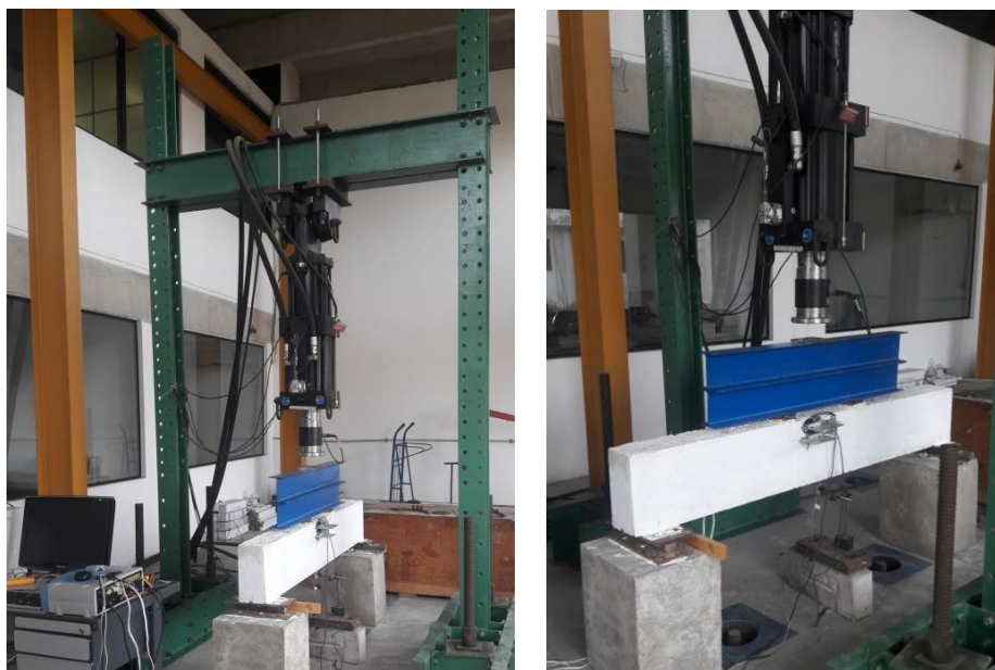
Figura 3.47 – Ensaio de flexão em 4 pontos de uma das vigas estudadas.
