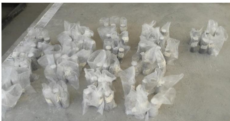
Figura 3.19 – Testemunhos extraídos das vigas.
