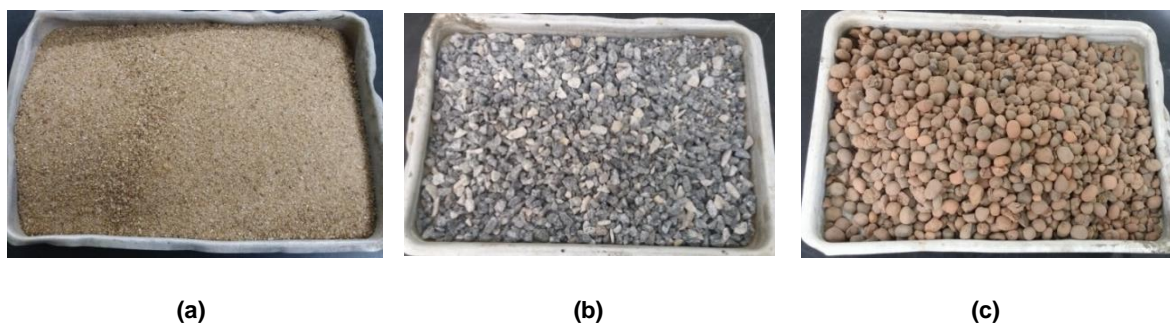
Figura 3.1 – Aspecto físico dos agregados utilizados: a) areia média; b) brita “0” e c) argila expandida 1506.
