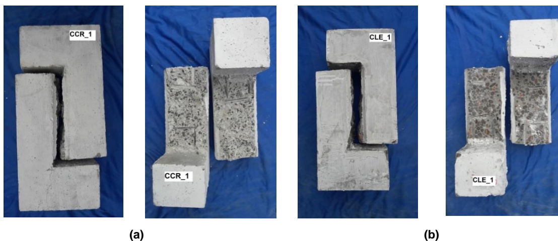
Figura 3.25 – Exemplo dos corpos de prova rompidos: a) CCR e b) CLE.
