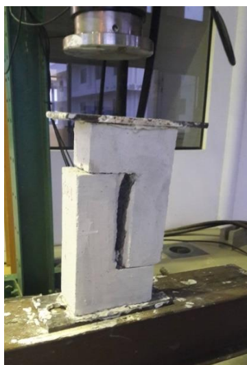
Figura 3.24 – Configuração do ensaio de resistência cisalhamento direto ( push-off ).
