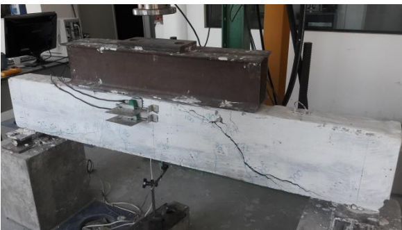
Foto 13 – Aspecto da viga V1_CLAA_100_00.
