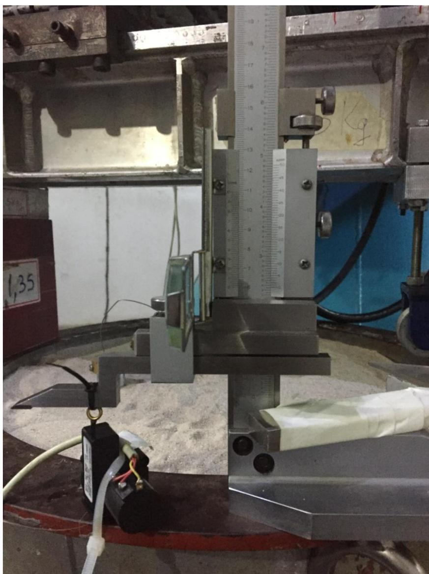
Figura IV.1 Calibração dos transdutores WPS-750-MK30-P10
