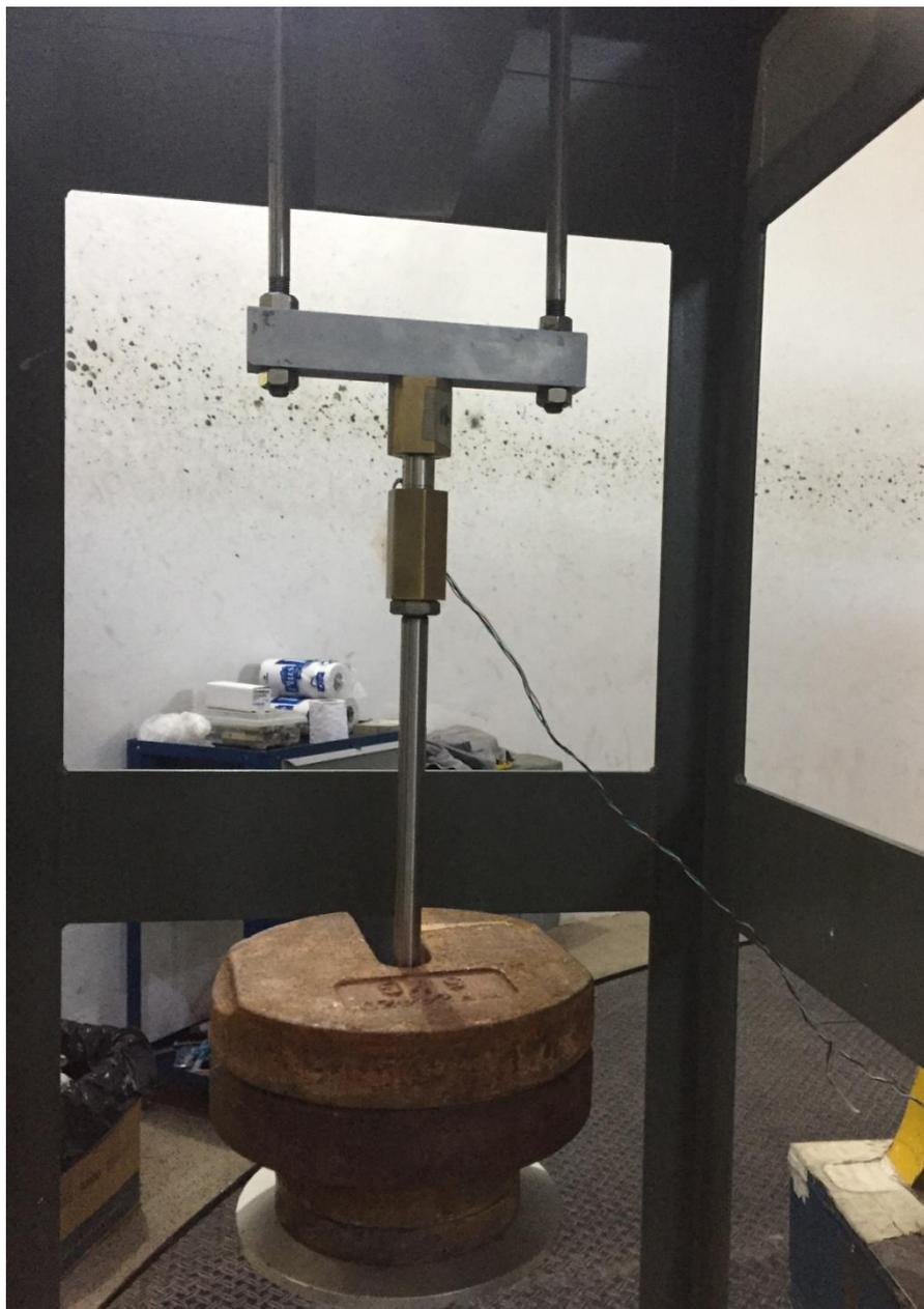
Figura II.2 Pórtico de calibração com pesos mortos
