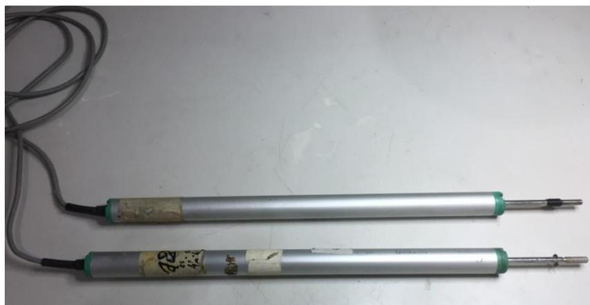
Figura 3.17 Transdutores lineares potenciométricos modelo GEFran Brasil PZ34-S-
