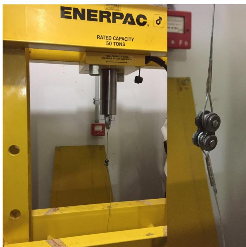
Figura 3.8 Ensaio de tração do cabo de aço na prensa
