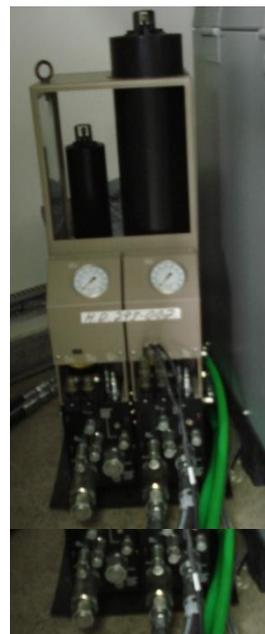
Figura 3.14 Unidade HPU-MTS- a) controlador 407 MTS, b) bomba hidráulica, c) manifold
