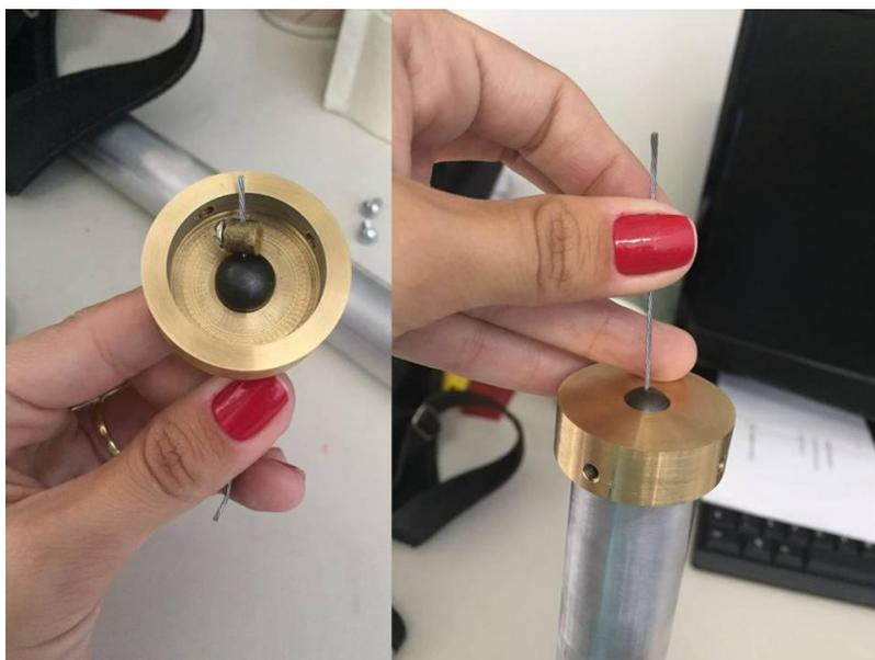
Figura 3.5 Peça acoplada na cabeça da estaca com rótula e cabo de aço
