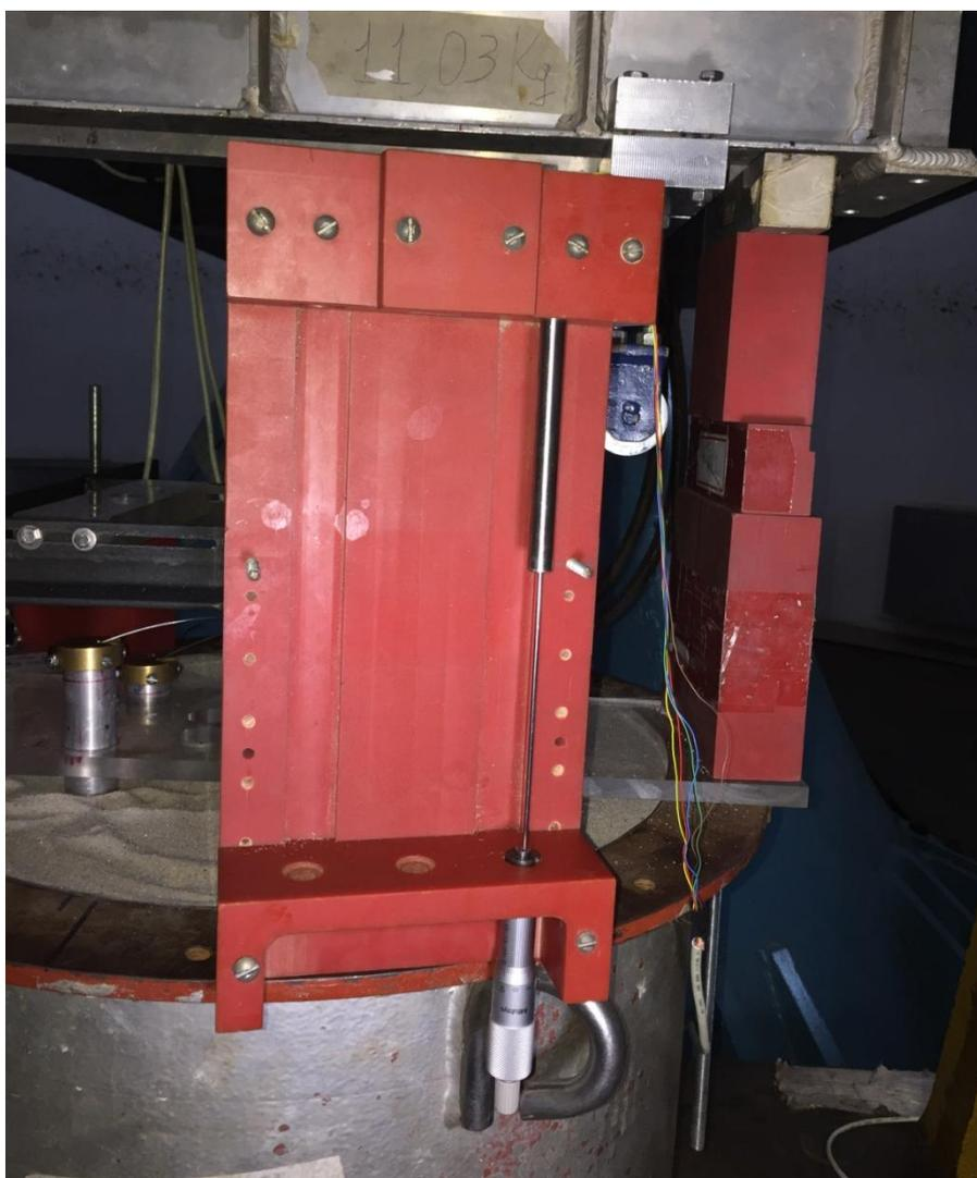
Figura V.1 Calibração do LVDT utilizando um micrômetro
