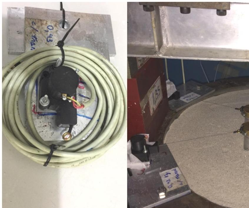
Figura 3.18 Transdutores de deslocamentos potenciométricos (19359 e 19994) modelo WPS-750-MK30-P10
