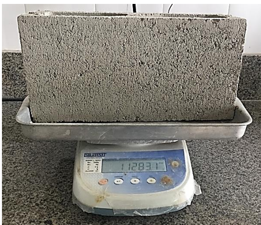
Figura 23 - Determinação da massa dos blocos à temperatura ambiente.
