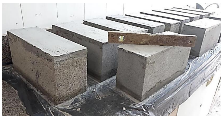
Figura 25 - Capeamento com pasta de cimento.
