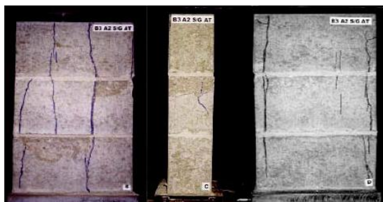
Figura 17 - Modo de ruptura dos prismas com argamassamento total (ROMAGMA, 2000).
