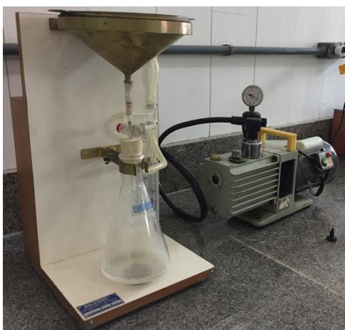
Figura 27 - Execução do ensaio de retenção de água da argamassa de assentamento com funil de Büchner.
