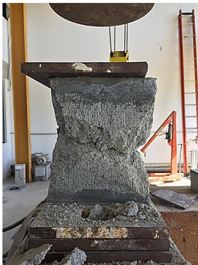
Figura 43 - Modo de ruptura dos blocos à compressão.
