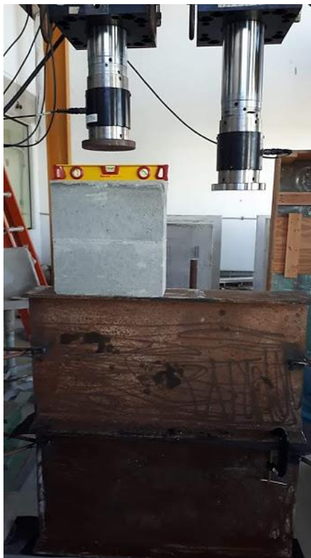
Figura 38 – Prisma posicionado para ensaio no atuador hidráulico controlado pelo sistema servohidráulico MTS® do LECIV/UENF.
