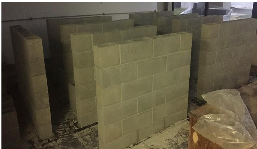
Figura 37 - Miniparedes armazenadas em local livre de intemperes à temperatura ambiente para o processo de cura.
