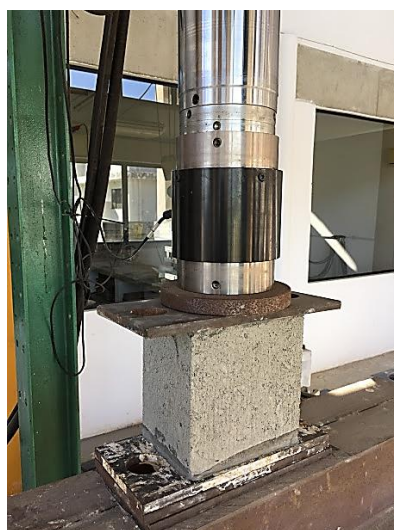
Figura 26 – Dispositivo para o ensaio de resistência à compressão dos blocos.
