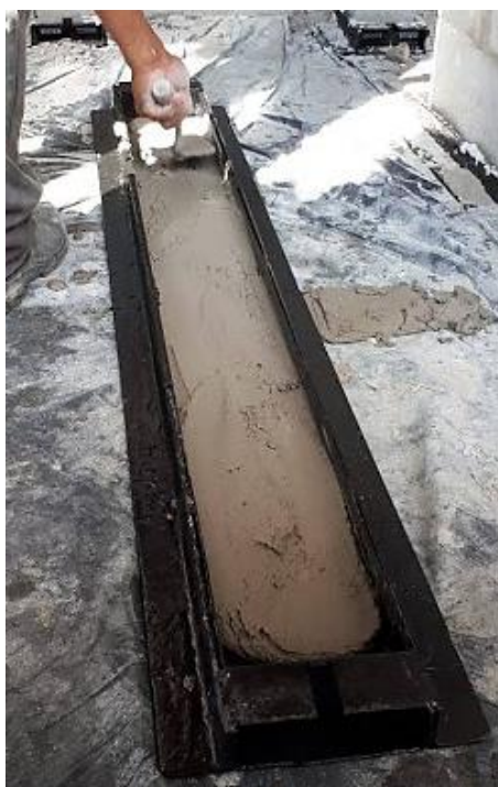
Figura 33 - Início do assentamento da miniparede sobre perfil U.
