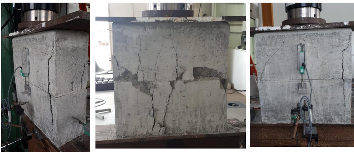
Figura 51 - Modo de ruptura dos prismas com argamassamento total.
