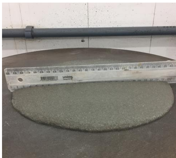
Figura 46 - Ensaio de consistência da argamassa de assentamento.
