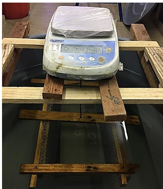
Figura 24 - Determinação da massa aparente por meio de balança hidrostática.
