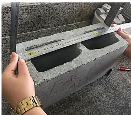
Figura 20 - Determinação do comprimento dos blocos.
