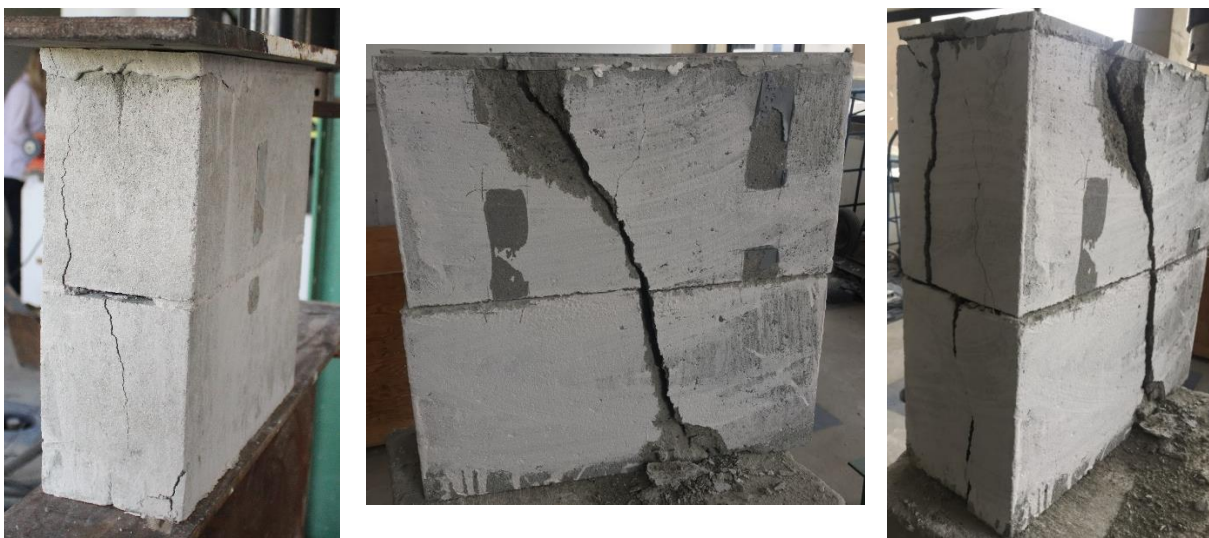
Figura 50 - Modo de ruptura dos prismas com argamassamento parcial.
