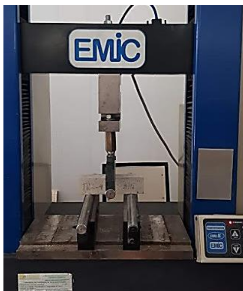
Figura 28 - Ensaio para a determinação da resistência à tração na flexão da argamassa de assentamento.
