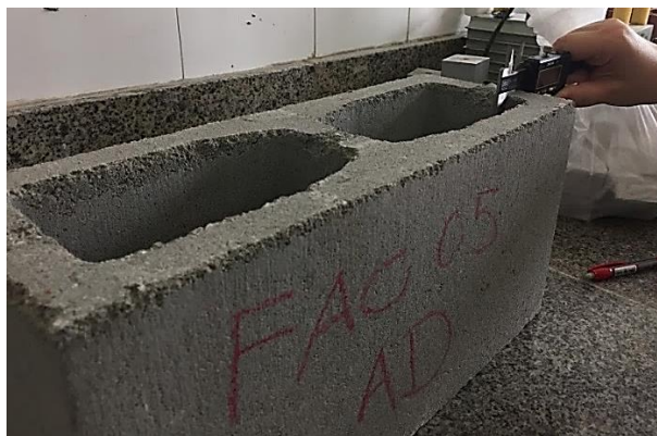
Figura 21 - Determinação das espessuras das paredes dos blocos.
