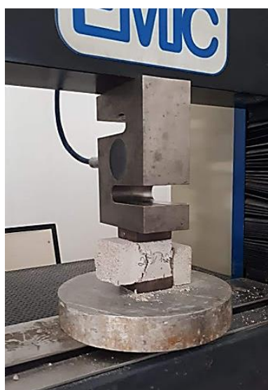
Figura 29 - Ensaio para a determinação da resistência à compressão da argamassa de assentamento.
