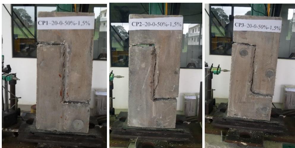
Figura A.5 – Corpos de prova CPn 1 20-0-50-1,5 após a realização do ensaio push-off .
