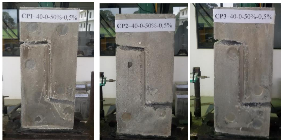
Figura 4.9 – Corpos de prova CPn 2 40-0-50-0,5 antes da realização do ensaio push-off .
