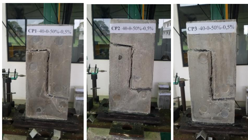
Figura 4.10 – Corpos de prova CPn 2 40-0-50-0,5 após a realização do ensaio push-off .
