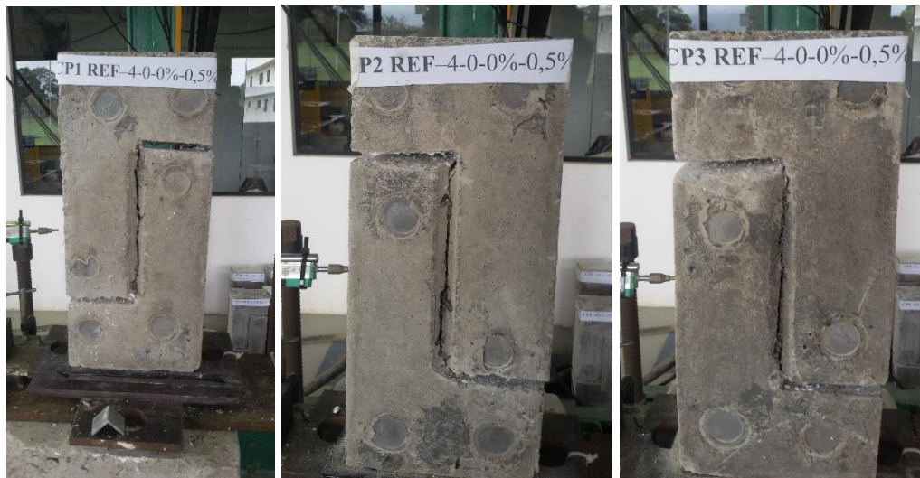
Figura A.14 – Corpos de prova CPn 4-0-0-0,5 após a realização do ensaio push-off .
