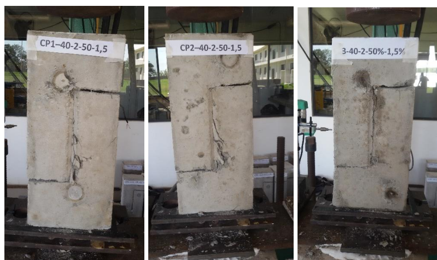
Figura A.11 – Corpos de prova CPn 3 40-0-50-1,5 após a realização do ensaio push-off .
