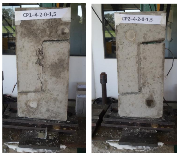
Figura A.23 – Corpos de prova CPn 4-2-0-1,5 após a realização do ensaio push-off .
