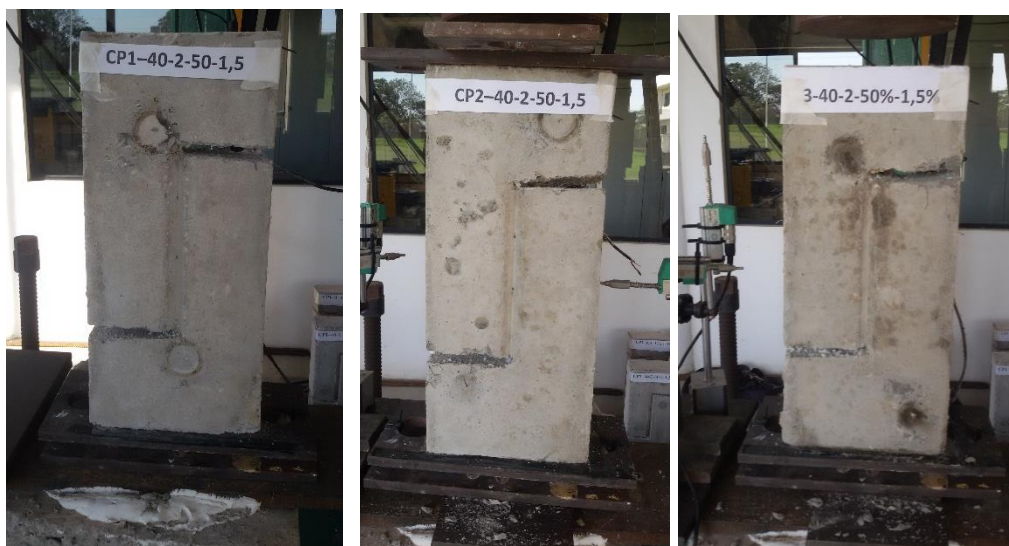
Figura A.10 – Corpos de prova CPn 3 40-0-50-1,5 antes da realização do ensaio push-off .
