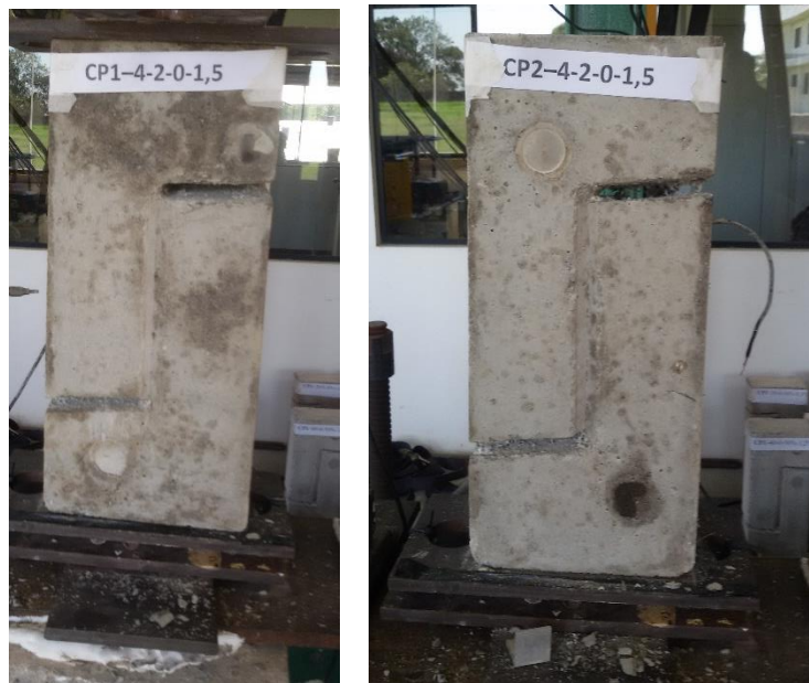
Figura A.22 – Corpos de prova CPn 4-2-0-1,5 antes da realização do ensaio push-off .
