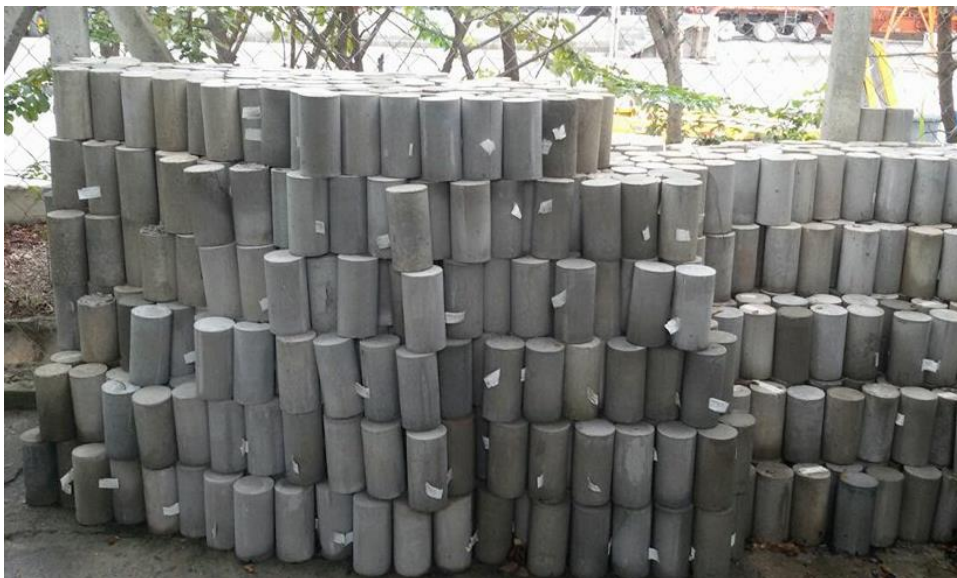
Figura 3.4 – Corpos de prova armazenados e identificados para produção do agregado reciclado.
