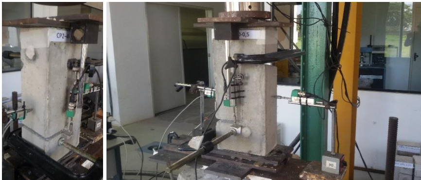
Figura 3.23 – Posicionamento dos LVDTs nos corpos de prova.
