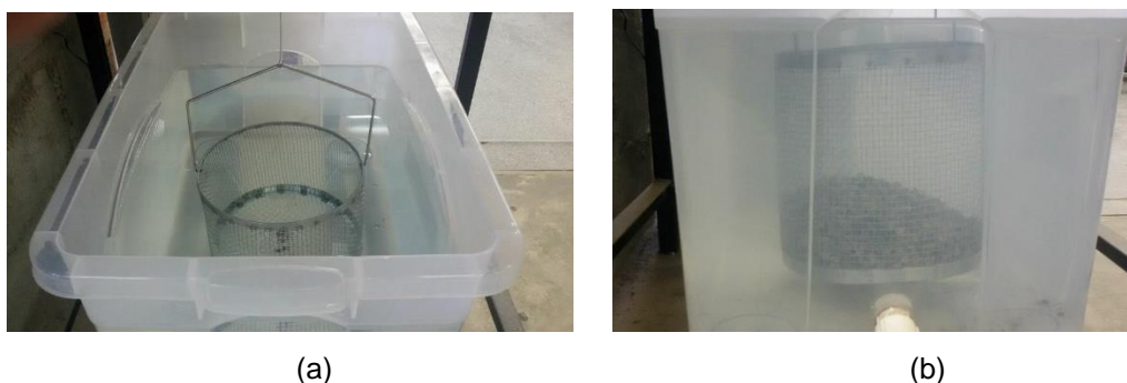
Figura 3.9 - Pesagem do agregado graúdo submerso: a) início do ensaio; b) término do ensaio.
