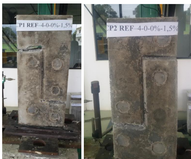
Figura A.17 – Corpos de prova CPn 4-0-0-1,5 após a realização do ensaio push-off .
