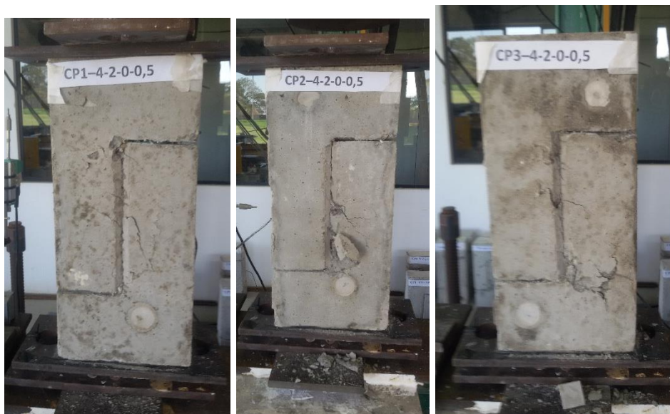
Figura A.20 – Corpos de prova CPn 4-2-0-0,5 após a realização do ensaio push-off .
