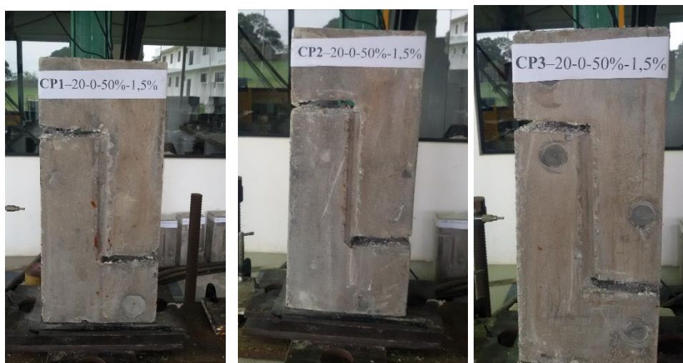
Figura A.4 – Corpos de prova CPn 1 20-0-50-1,5 antes da realização do ensaio push-off .
