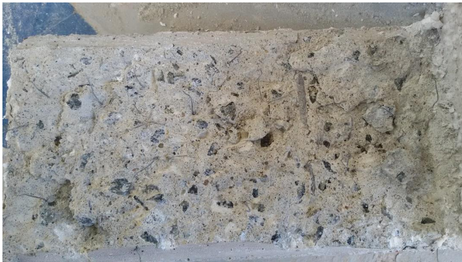
Figura 4.26 – Detalhe da superfície de ruptura do corpo de prova da série CPn 1-20-0-50-0,5.
