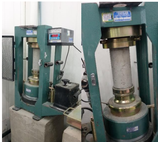
Figuras 3.19 – Ensaio de resistência à compressão do concreto.
