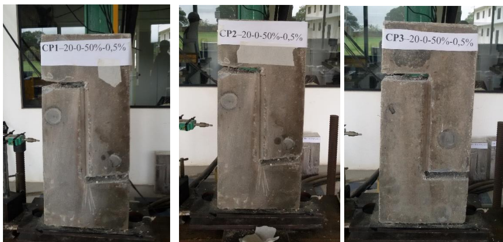
Figura A.1 – Corpos de prova CPn 1 20-0-50-0,5 antes da realização do ensaio push-off .
