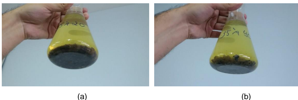
Figura 3.10 – Ácido agindo no agregado reciclado: a) Grupo I – 15 a 20 MPa; b) Grupo II – 35 a 40 MPa.
