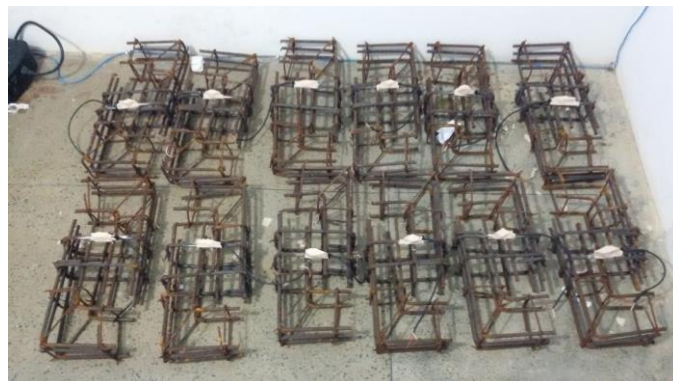
Figura 3.24 – Posicionamento dos strain gages nos estribos das armaduras.
