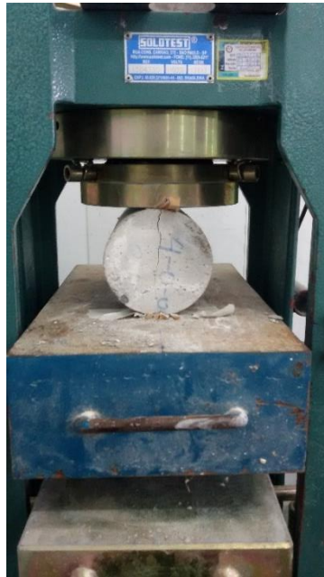
Figuras 3.20 – Ensaio de resistência à tração por compressão diametral do concreto.
