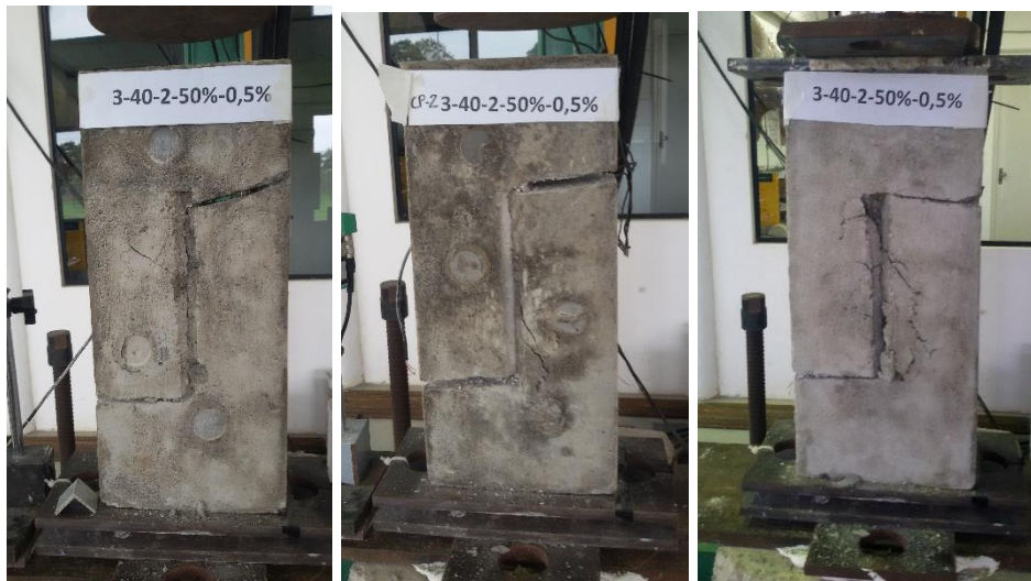
Figura A.8 – Corpos de prova CPn 3 40-2-50-0,5 após a realização do ensaio push-off .
