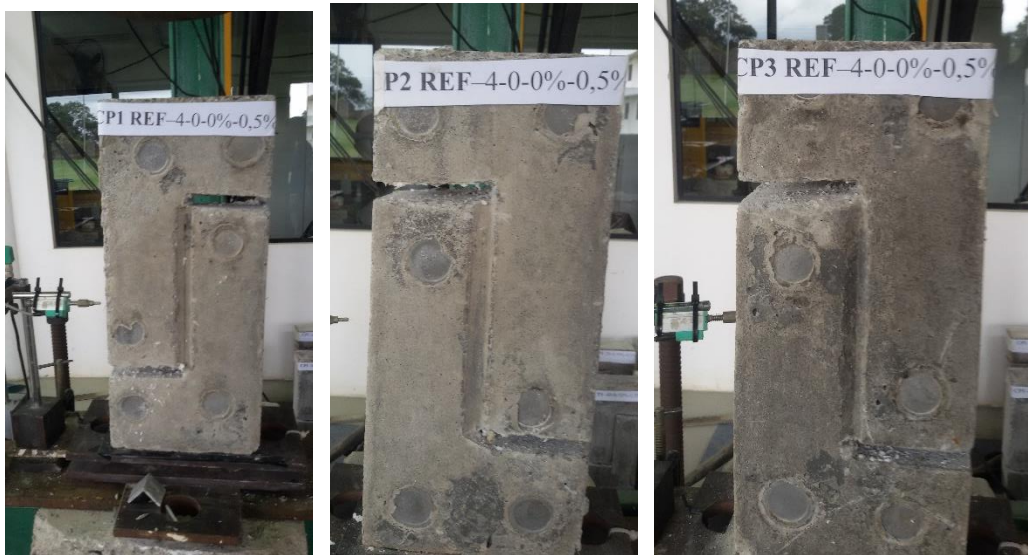
Figura A.13 – Corpos de prova CPn 4-0-0-0,5 antes da realização do ensaio push-off .
