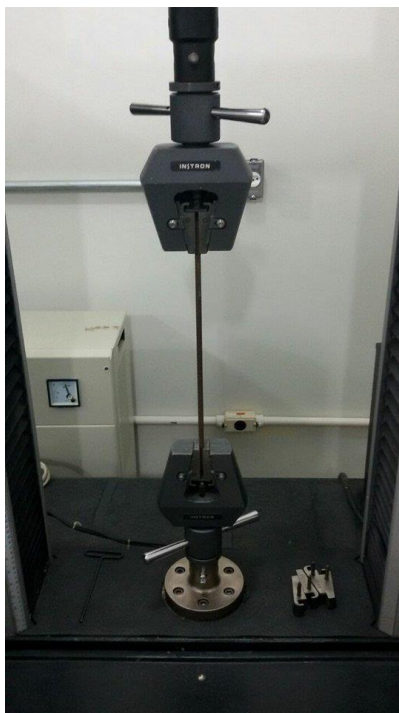
Figura 3.1 – Ensaio de tração realizado na barra de aço de 8 mm.
