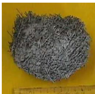
Figura 1.4 – Novelos formados por fibras de aço mal misturadas ao concreto (Figueiredo, 2000).
