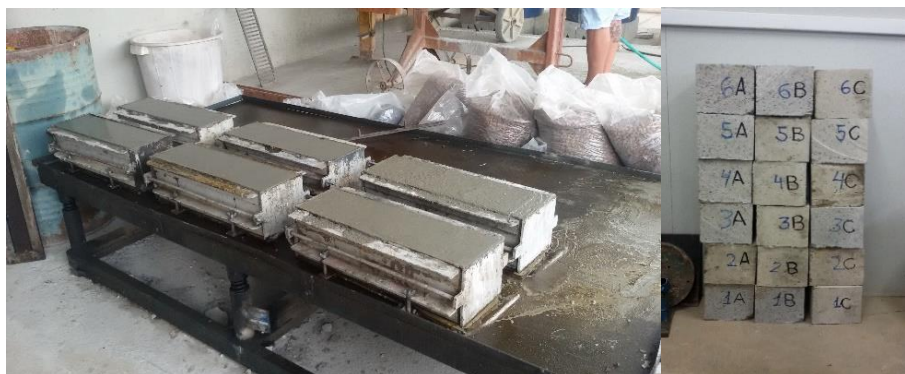
Figura 3.21 – Produção de corpos de prova: a) moldagem; b) corpos de prova para a realização do ensaio de absorção e massa específica.
