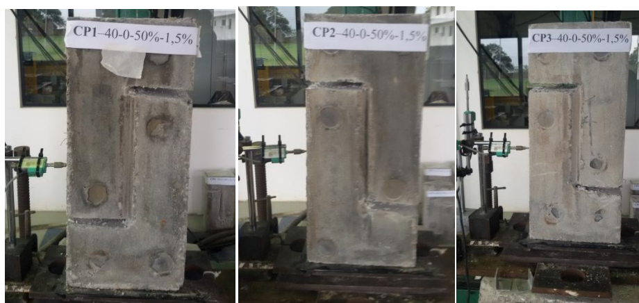
Figura 4.12 – Corpos de prova CPn 2 40-0-50-1,5 antes da realização do ensaio push-off .
