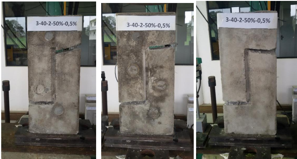
Figura A.7 – Corpos de prova CPn 3 40-2-50-0,5 antes da realização do ensaio push-off .
