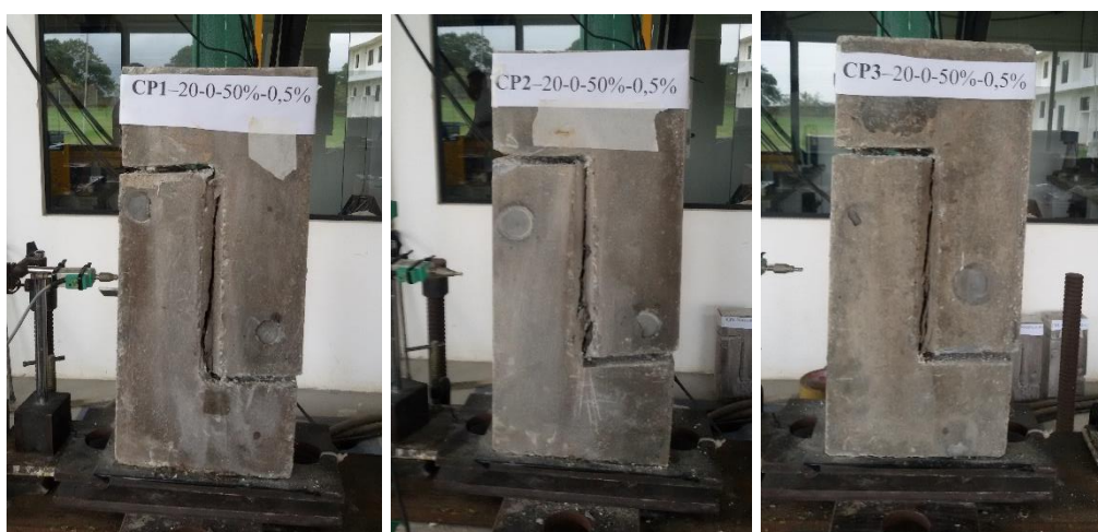
Figura A.2 – Corpos de prova CPn 1 20-0-50-0,5 após a realização do ensaio push-off .
