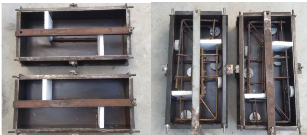
Figuras 3.15 - Fôrmas metálicas para os corpos de prova push-off . (a) detalhe da fôrma sem a armadura; (b) detalhe da fôrma com a armadura disposta em seu interior.
