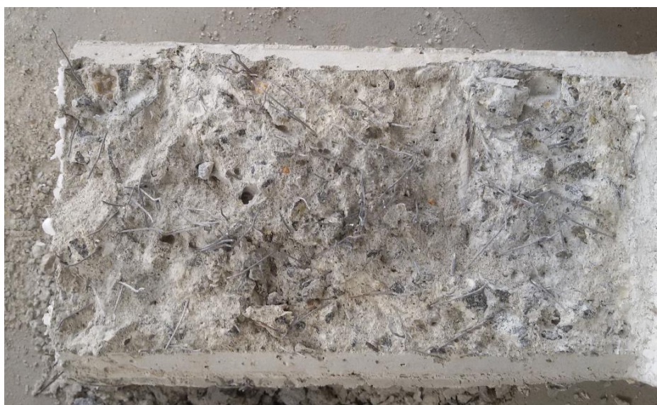
Figura 4.27 – Detalhe da superfície de ruptura do corpo de prova da série CPn 1-20-0-50-1,5.
