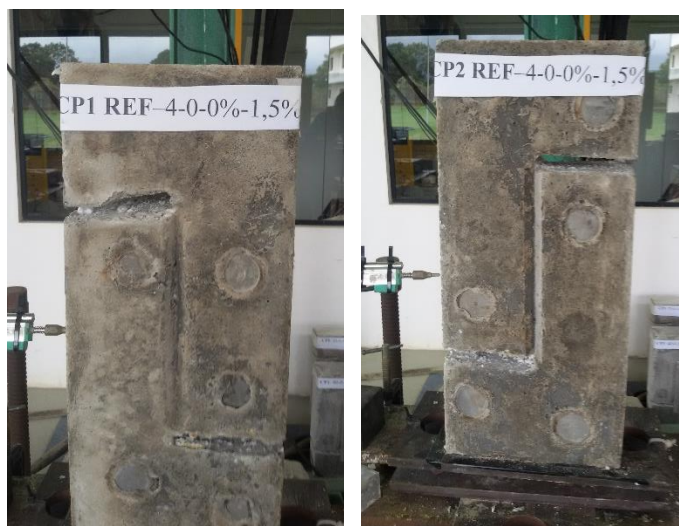
Figura A.16 – Corpos de prova CPn 4-0-0-1,5 antes da realização do ensaio push-off .
