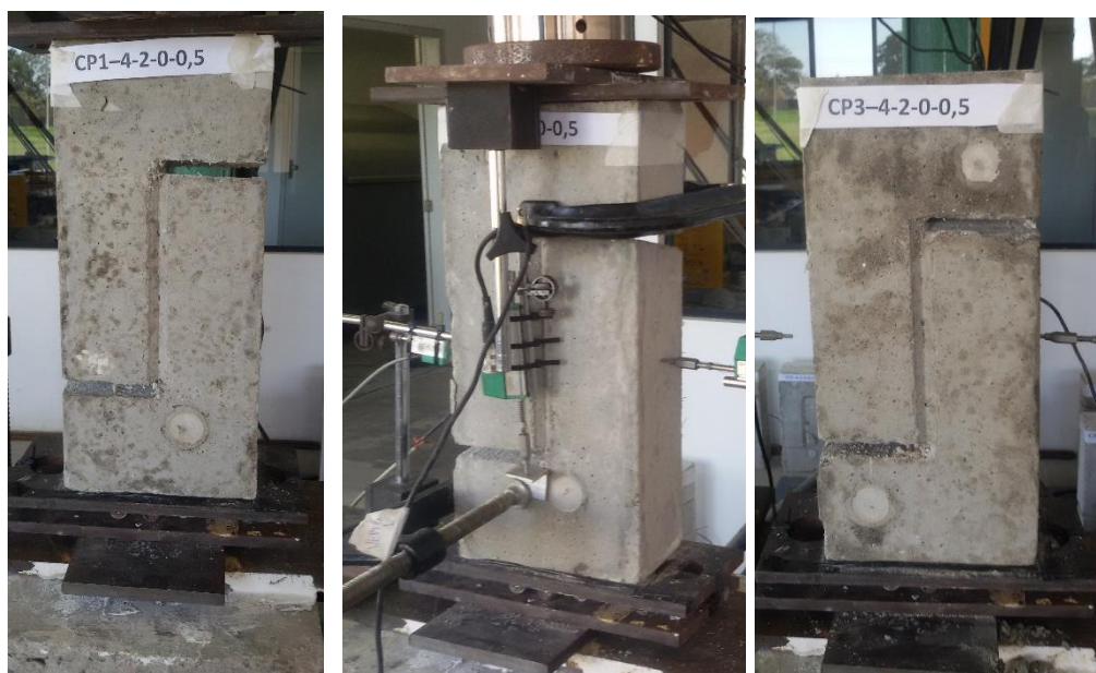
Figura A.19 – Corpos de prova CPn 4-2-0-0,5 antes da realização do ensaio push-off .
