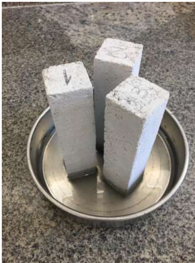
Figura 13: Corpos de prova durante ensaio de absorção de água por capilaridade e coeficiente de capilaridade.
