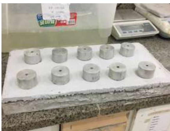
Figura 15: Pastilhas coladas sobre a base de argamassa para ensaio de aderência à tração.
