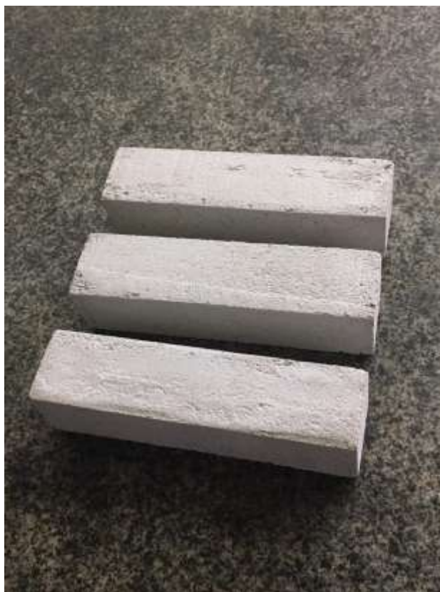
Figura 12: Corpos de prova prismáticos de dimensões 40 mm × 40 mm × 160 mm.
