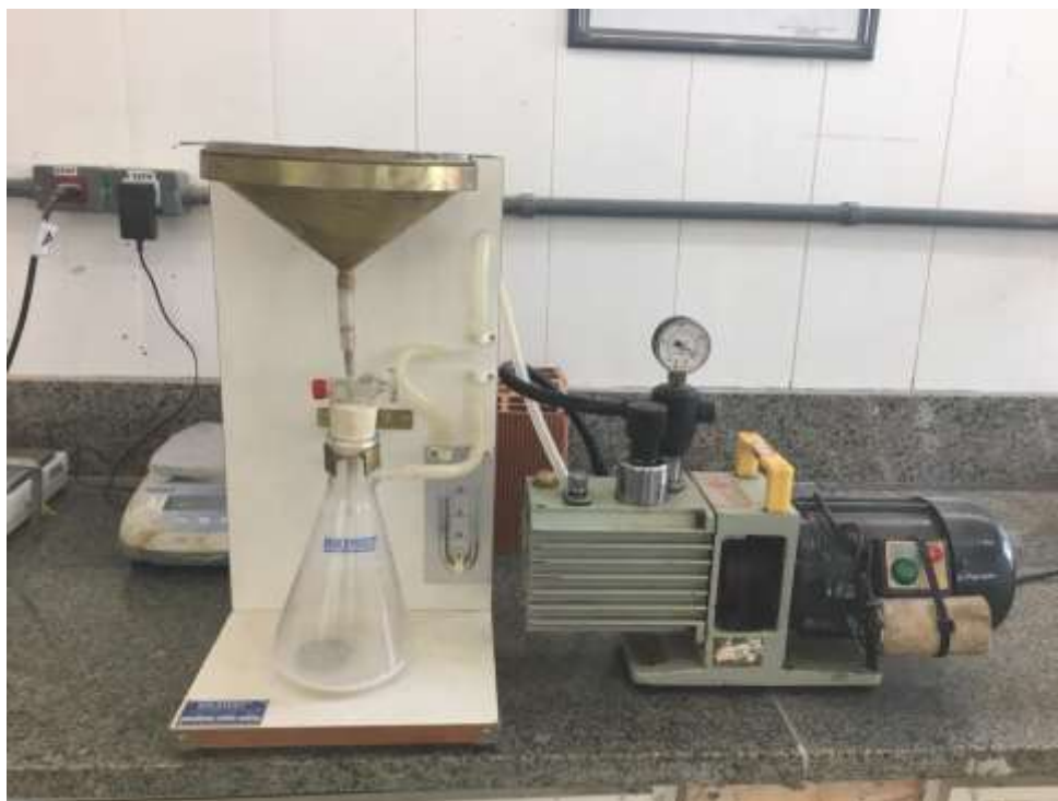
Figura 11: Funil de Buchner modificado acoplado à bomba de vácuo durante ensaio para determinação da retenção de água.
