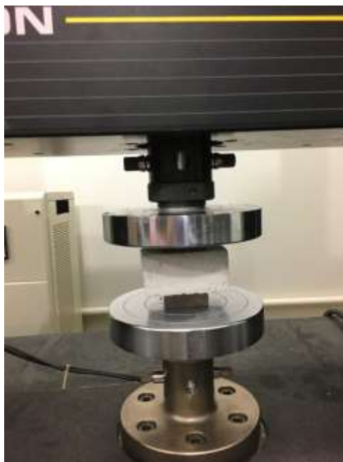
Figura 19: Corpo de prova no início do ensaio de compressão.
