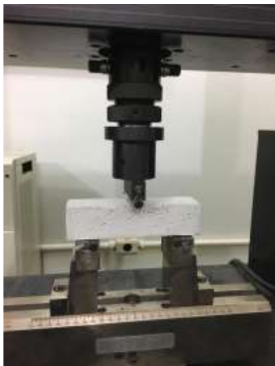
Figura 17: Corpo de prova no início do ensaio de determinação de resistência à tração na flexão.
