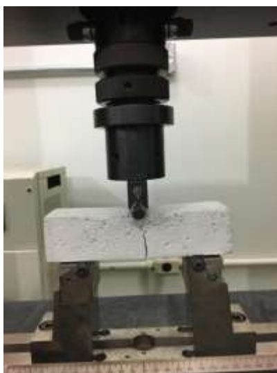
Figura 18: Corpo de prova após a ruptura no ensaio de determinação de resistência à tração na flexão.
