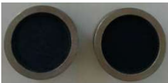
Figura 6: Pratos metálicos com revestimento elastomérico utilizados nas extremidades dos corpos de prova cilíndricos.
