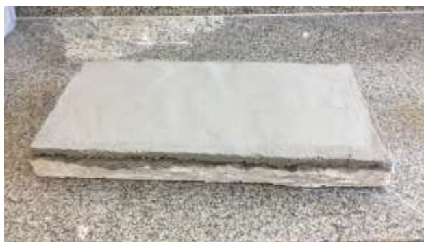
Figura 14: Base de argamassa sobre substrato de concreto para ensaio de aderência à tração.
