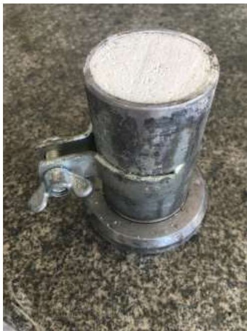
Figura 5: Corpo de prova na fôrma cilíndrica (diâmetro = 50 mm e altura = 100 mm).
