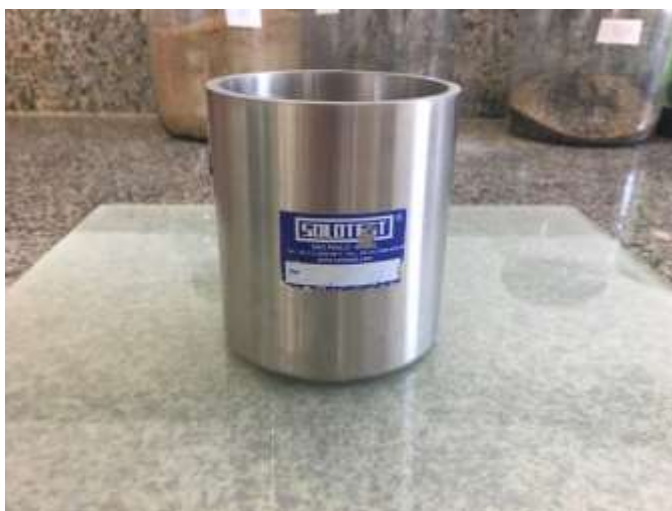
Figura 10: Recipiente para determinação da densidade de massa no estado fresco.
