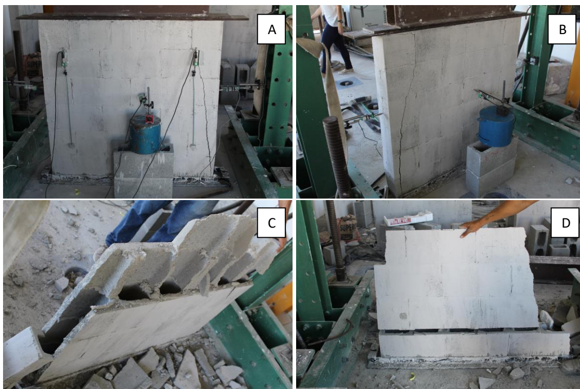
Figura 86 - Ruptura do modelo de miniparede sem viga
