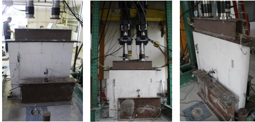
Figura 51 - Ensaio em Miniparedes. Fonte: Próprio autor
