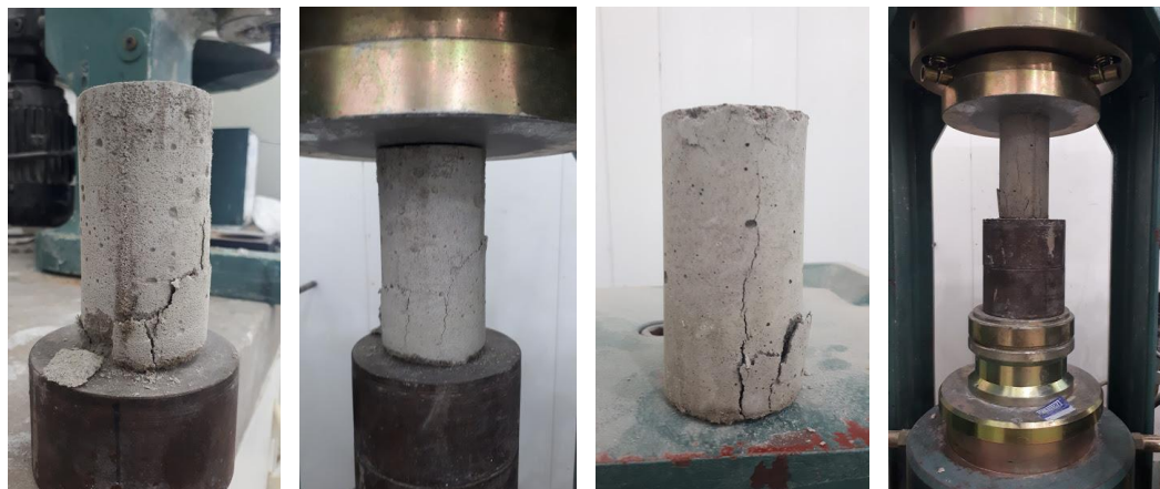
Figura 29 - Verificação da resistência a compressão, estudo do graute ideal
