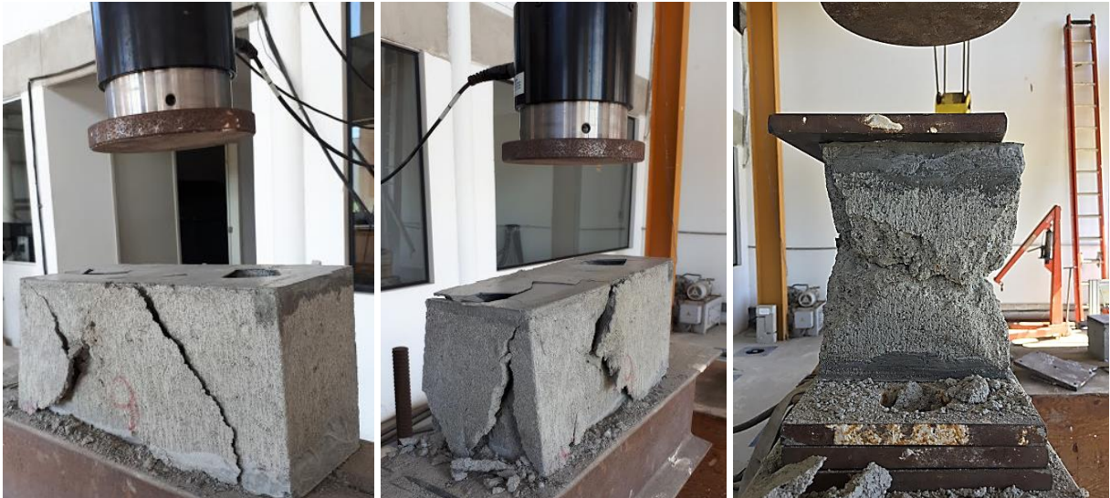
Figura 60 - Ruptura dos Blocos de concreto. Fonte: Próprio autor
