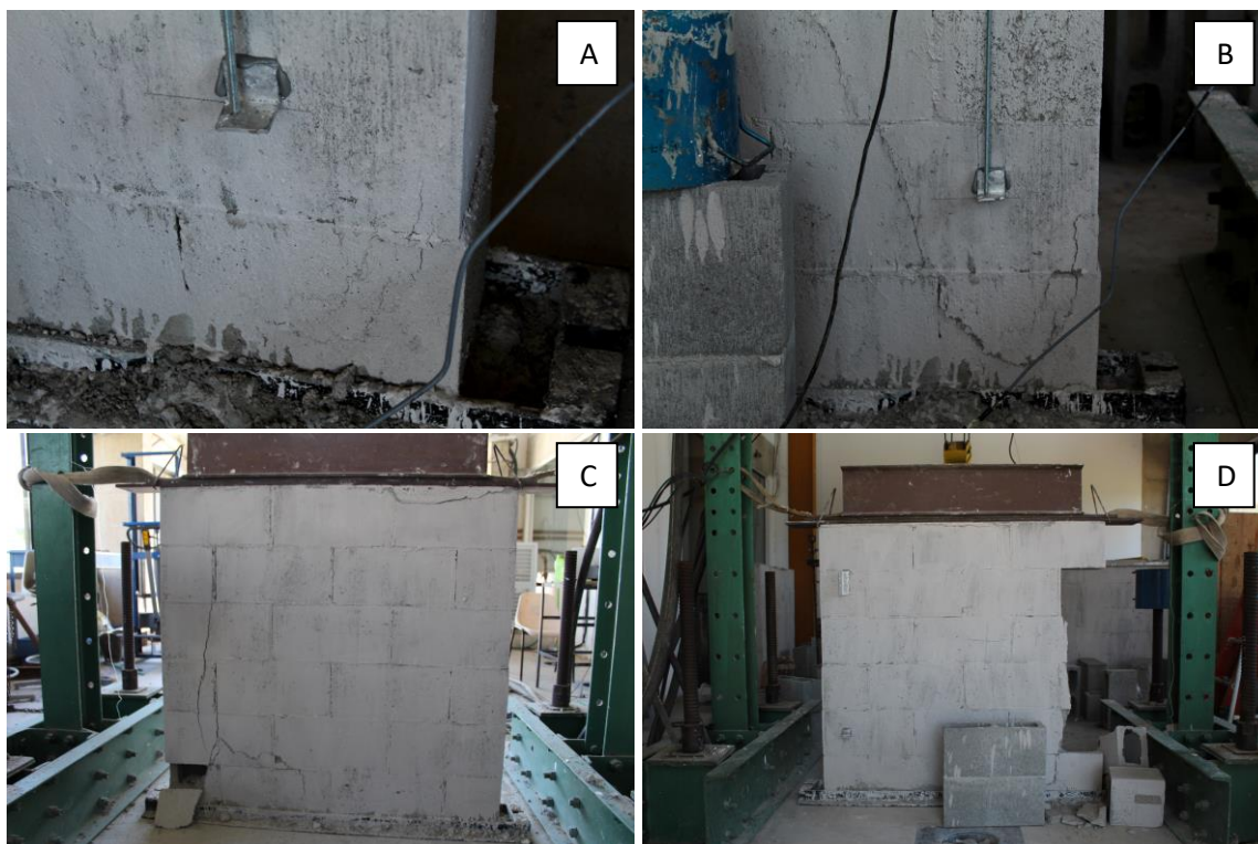
Figura 93 - Módulo de ruptura das miniparedes com vigas convencionais
