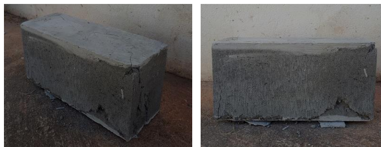
Figura 23 - Bloco rompido. Fonte: Próprio autor
