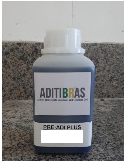
Figura 31 - Incorporador de ar. Fonte: Próprio autor
