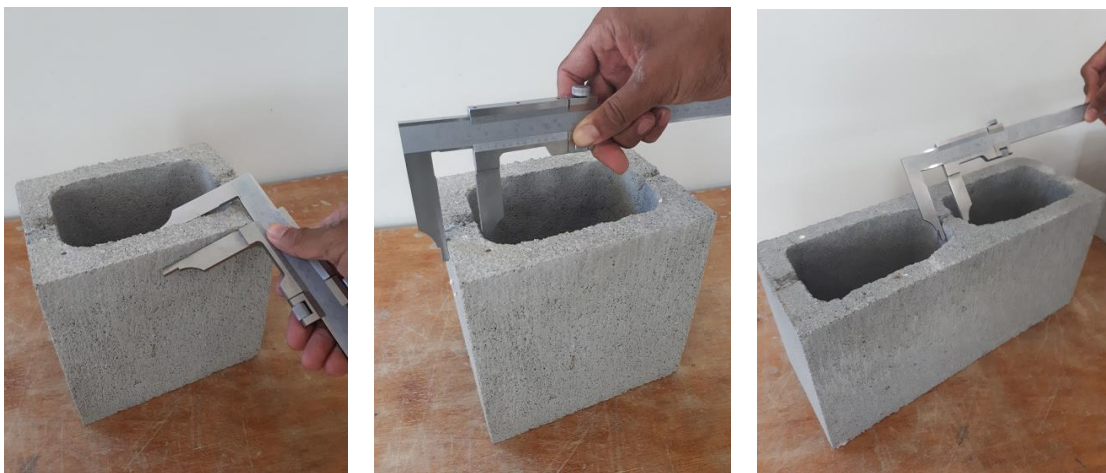
Figura 20 - Medição das dimensões menores com paquímetro manual. Fonte: Próprio autor
