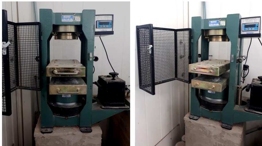
Figura 22 - Prensa Manual Solotest®. Fonte: Próprio autor
