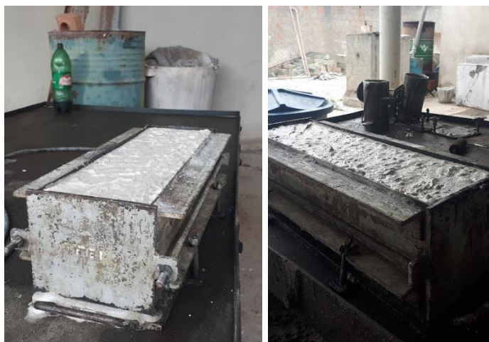
Figura 64 - Ensaio de densidade real do concreto no estado seco
