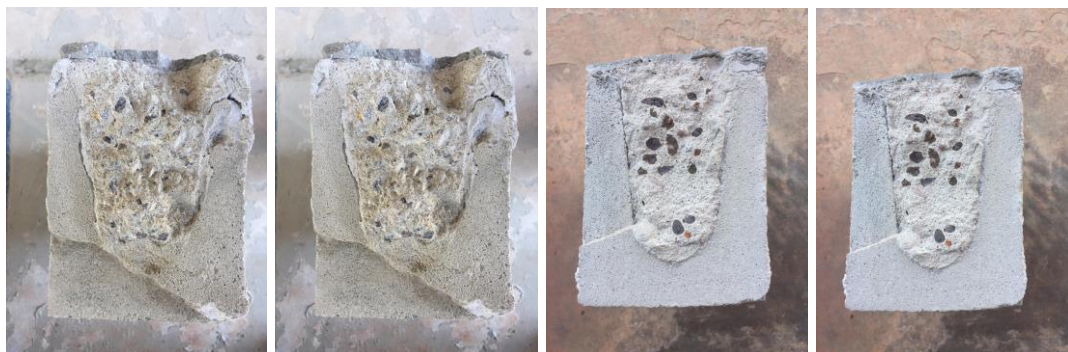
Figura 65 - Interface de ruptura do bloco canaleta e concreto de preenchimento
