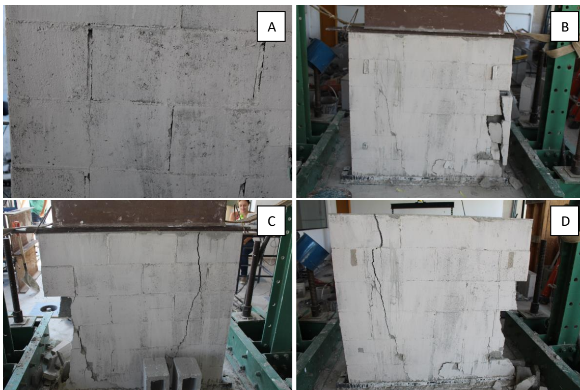
Figura 101 - Módulo de ruptura das miniparedes com vigas convencionais
