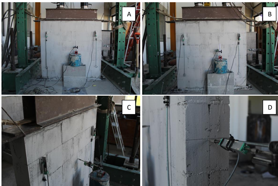
Figura 100 - Preparação para aplicação de carga nas miniparedes com viga leve
