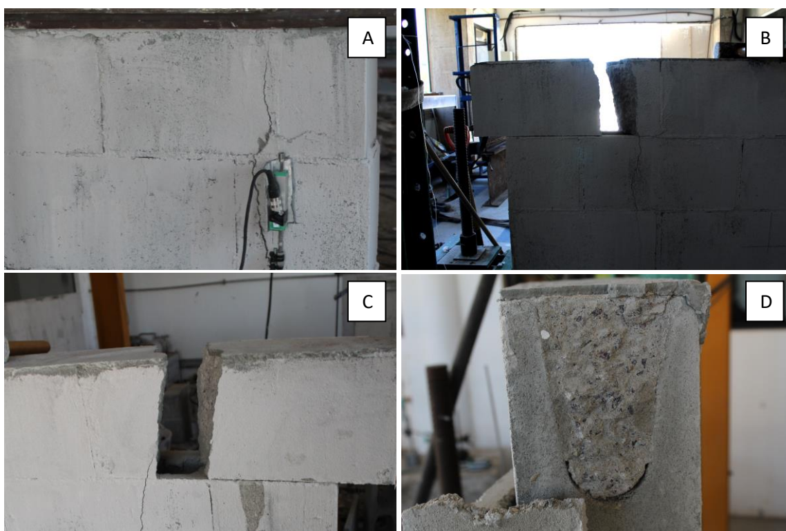
Figura 94 - Ruptura da Viga
