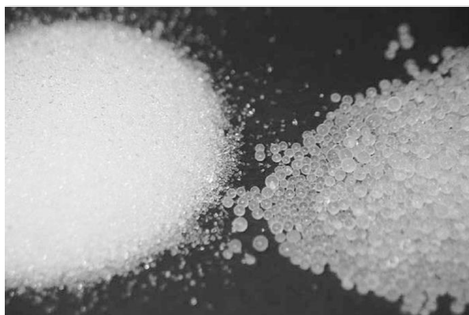
Figura 2.17. Sílica gel (Sadek et al. , 2002).
