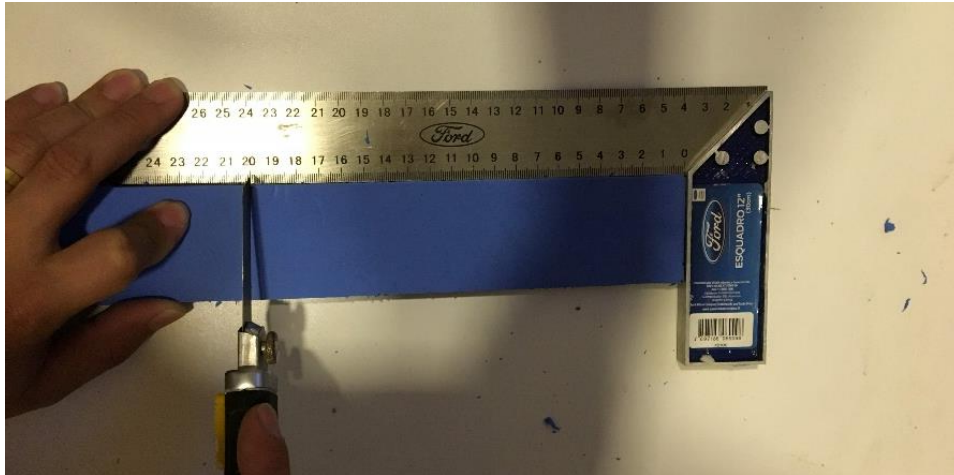
Figura 3.41. Corte da folha de E.V.A. no comprimento e largura do container de ensaio.
