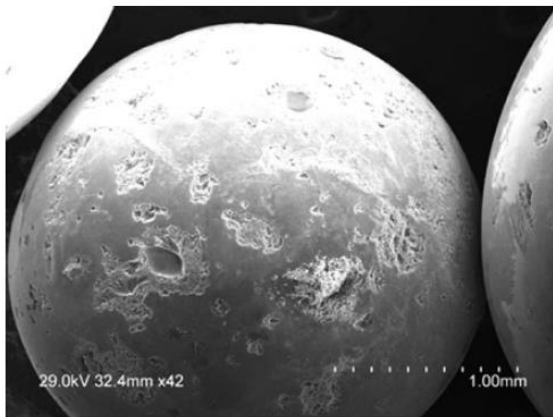
(a) Foto da seção transversal esférica ampliada em 48 vezes (2-5 mm) comumente encontrada como dessecante para produtos embalados.
