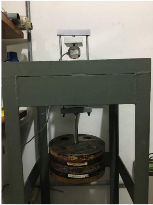
(a) Calibração da célula de carga
