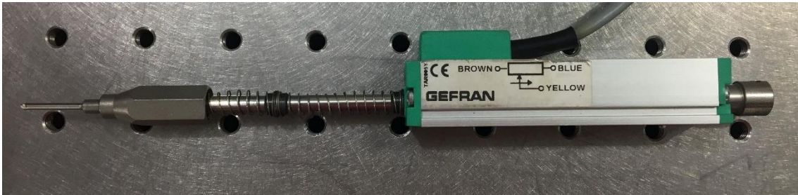
Figura 3.29. Sensor de deslocamento utilizado nos ensaios.
