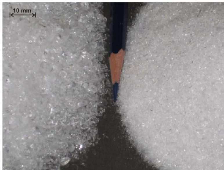
Figura 2.19. Partículas de quartzo fundido, graduação grossa: D_{50} = 1,68 mm, graduação fina: D_{50}=0,33 mm (Ezzein e Bathurst, 2011).
