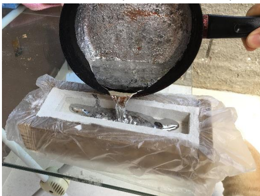
(c) Chumbo derretido sendo colocado dentro da forma
