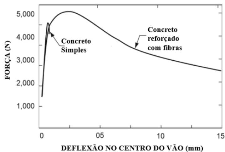
Figura 2.2- Comportamento mecânico de um composto cimentício reforçado com fibras submetido à flexão (MEHTA e MONTEIRO, 2014).
