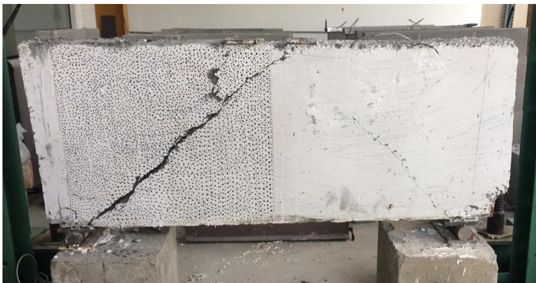
Figura 4.26: Ruptura da viga VCLF106.
