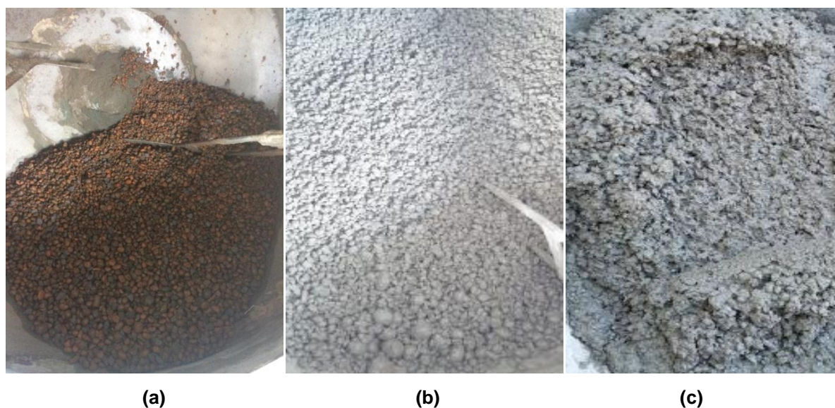
Figura 3.12: Sequencia da produção dos concretos: a) agregados leves absorvendo parte da água, b) homogeneização do agregado com o cimento e c) inserção do restante dos materiais e aspecto fina da mistura.
