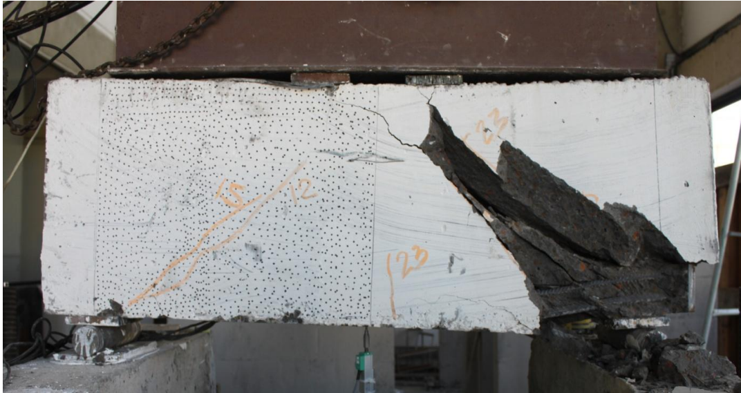
Figura 4.19: Ruptura da viga VCL104.
