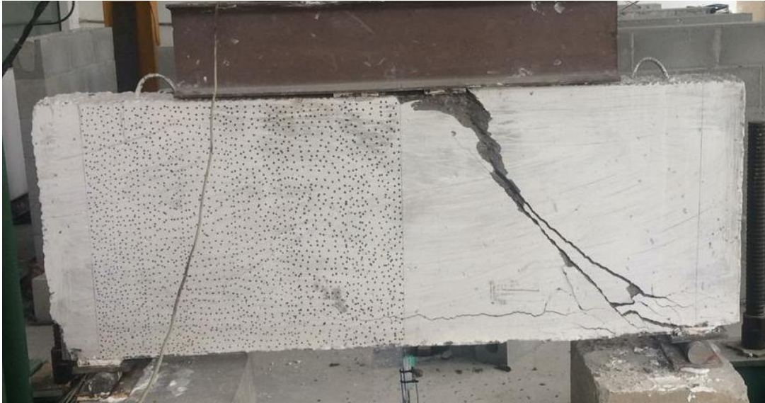
Figura 4.24: Ruptura da viga VCL106.
