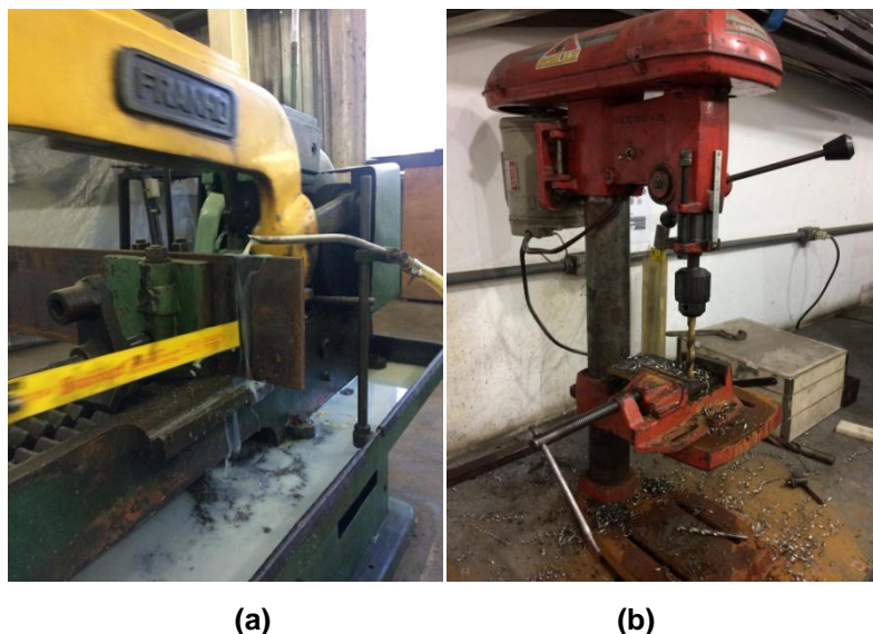
Figura 3.10: Etapas iniciais da confecção das armaduras: a) corte das chapas de aço em placas e b) realização de furos nas placas.
