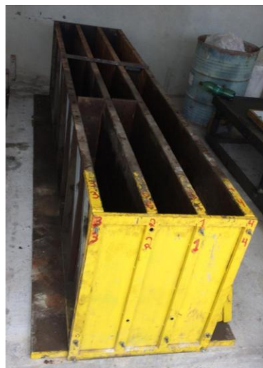
Figura 3.6: Forma metálica para concretagem das vigas-parede.
