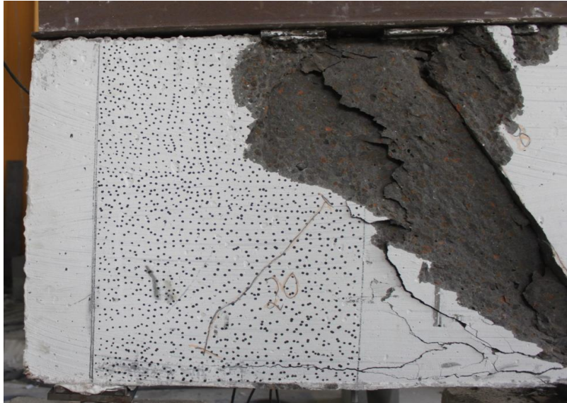
Figura 4.9: Ruptura da viga VCL056.
